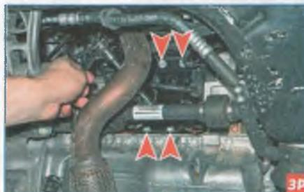
Головкой «на 13» с удлинителем отворачиваем четыре болта крепления
