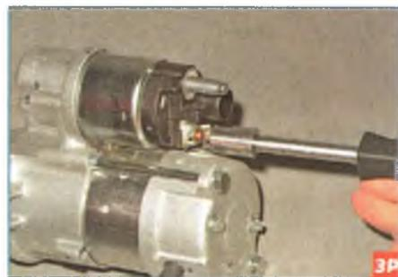
Головкой «на 10» отворачиваем гайку...
