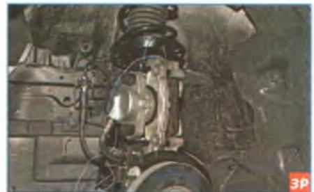
Подвязываем суппорт с направляющей колодок к пружине амортизаторной стойки.
