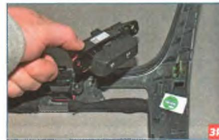
Вынимаем выключатель из накладки.
