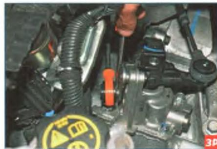
...оперев шлицевую отвертку на рычаг выбора передач...
