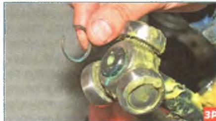
...вынимаем стопорное кольцо из проточки на валу.
