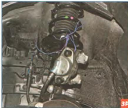
Подвязываем суппорт шнуром или проволокой к пружине амортизаторной стойки.
