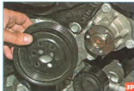
...снимаем шкив со ступицы насоса.
