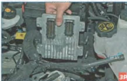
...и снимаем блок управления со шпилек кронштейна.
