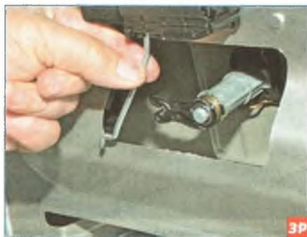
...и выводим тягу из отверстия рычага.
