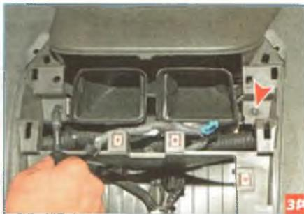
Головкой «на 7» отворачиваем два самореза в зоне центральных воздуховодов.
