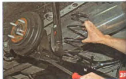
...и снимаем обе пружины задней подвески (см. «Снятие пружины», с. 158).
