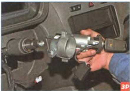
Снимаем выключатель зажигания (см. «Снятие катушки с блоком управления иммобилайзером и выключателя зажигания», с. 204).
