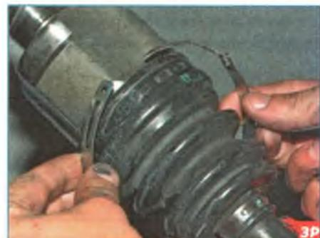
...и, расстегнув замок, снимаем хомут.
