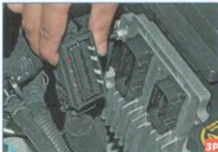
Аналогично отсоединяем от разъема блока другую колодку жгута проводов системы управления двигателем.
