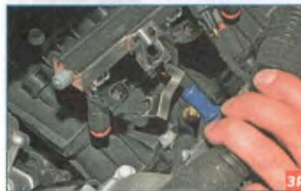
...извлекаем форсунки из отверстий во впускном трубопроводе.
