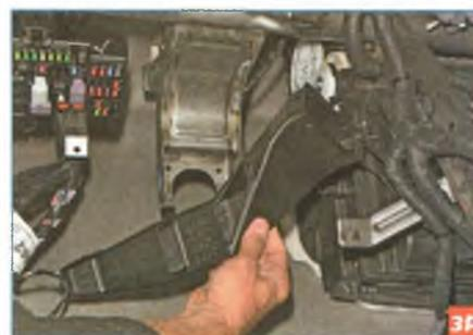
...и снимаем воздуховод подачи воздуха к ногам водителя.
