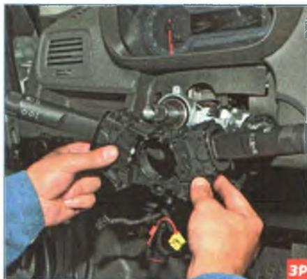
Снимаем соединитель с подрулевыми переключателями (см. «Снятие подрулевых переключателей, барабанного устройства спирального кабеля, соединителя переключателей и датчика углового поворота рулевого колеса», с. 219).
