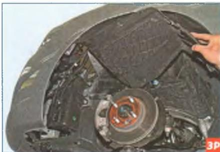
...отгибаем переднюю часть подкрылка и заводим ее за тормозной механизм. Для снятия насоса омывателя...
