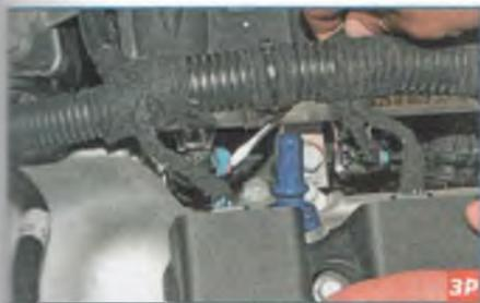
Шлицевой отверткой выдвигаем стопорный элемент фиксатора колодки жгута проводов системы управления двигателем...
