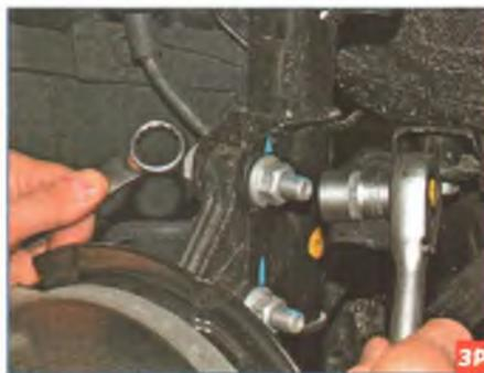
...болты крепления стойки к поворотному кулаку следует удерживать накладным ключом «на 21», т.к. в новых деталях (например амортизаторных стойках) еще нет насечки под соответствующие элементы болтов.
