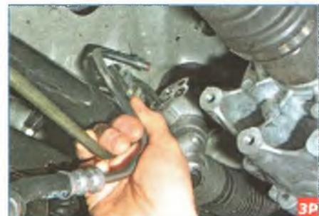
Отводим фланец трубок от картера рулевого механизма...
