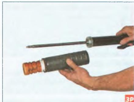
Снимаем защитный чехол вместе с буфером хода сжатия.
