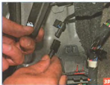
...и разъединяем колодки антенны.
