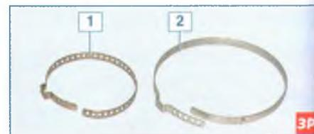
Универсальные хомуты для крепления чехла ШРУСа: 1 – хомут крепления чехла на валу привода; 2 – хомут крепления чехла на корпусе шарнира
