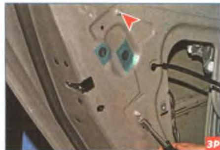
Головкой «на 10» отворачиваем две гайки крепления направляющей стекла к внутренней панели двери.
