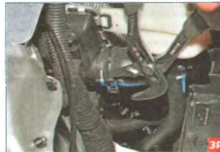
С левой стороны раздвижными пассатижами сжимаем концы хомута крепления подводящего шланга радиатора и, сдвинув хомут по шлангу...
