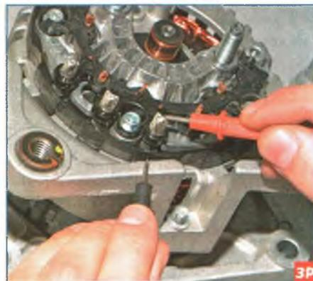
...«плюс» тестера (в режиме проверки диодов) подсоединяем к выводу одной из фазных обмоток статора, а «минус» – к корпусу генератора.
