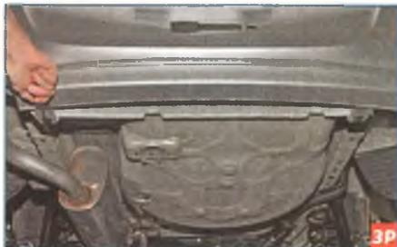
Шлицевой отверткой поддеваем фиксатор пистона левого крепления бампера к кронштейну кузова...
