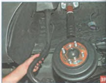
...и снимаем наливную трубу.
