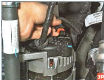
Нажав на фиксатор колодки проводов, отсоединяем колодку от разъема генератора.
