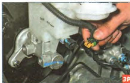
Отжав фиксатор колодки жгута проводов, отсоединяем ее от разъема датчика уровня рабочей жидкости.
