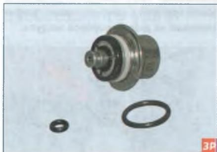
При повреждении резиновых уплотнительных колец регулятора, заменяем их новыми.
