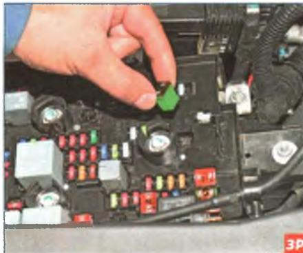
Предохранитель большого размера вынимаем рукой.
