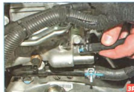
...снимаем шланг со штуцера выпускного патрубка.
