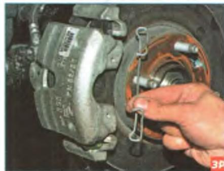
...и снимаем фиксатор.
