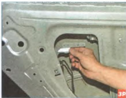
Снимаем со шпилек наружной ручки металлическую пластину...
