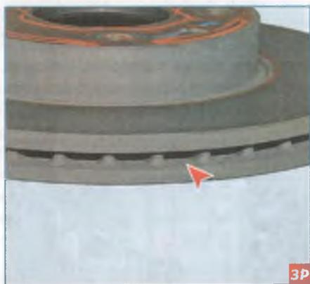
Расположение маркировки минимальной толщины диска тормозного механизма переднего колеса.
