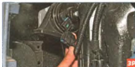
Нажав на фиксатор колодки проводов, отсоединяем колодку от разъема сигнала.
