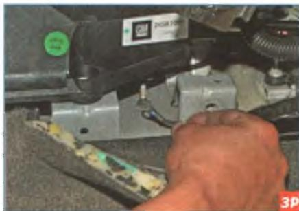
...и снимаем наконечник «массового» провода со шпильки, расположенной под механизмом переключения передач. Снизу отопителя...
