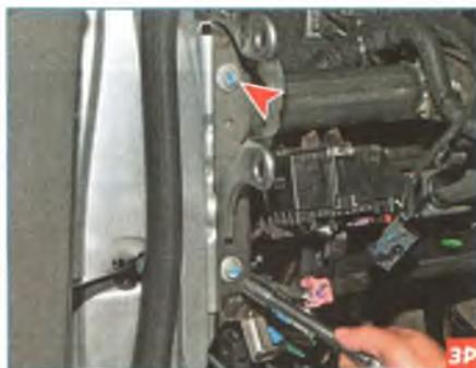
Головкой «на 13» отворачиваем два болта крепления каркаса панели приборов с левой стороны.
