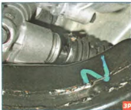
...стягиваем чехол с картера рулевого механизма...
