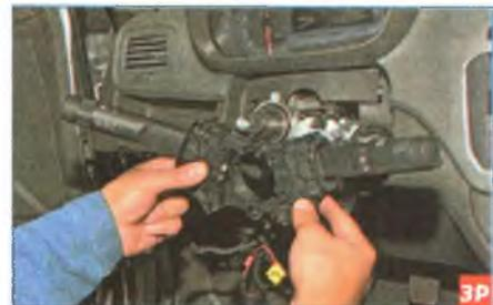
Снимаем соединитель с переключателями с рулевой колонки...
