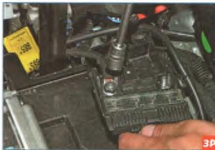
Головкой «на 13» отворачиваем гайку...
