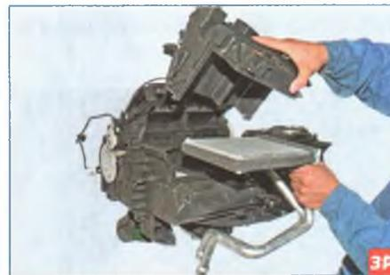
Приподняв заднюю часть корпуса отопителя, вынимаем радиатор отопителя.
