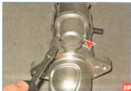
Головкой E-5 отворачиваем два винта крепления тягового реле.
