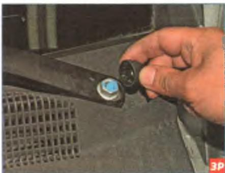
...и снимаем его с рычага щетки.
