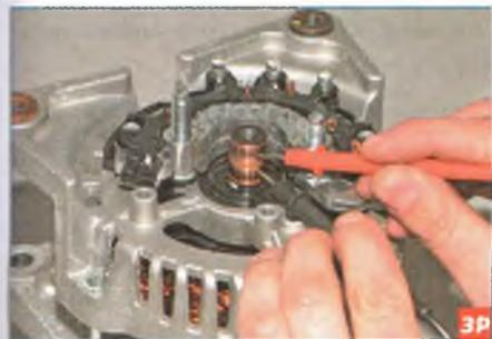
...подсоединяем щупы цифрового тестера (в режиме омметра) к контактному кольцам.
