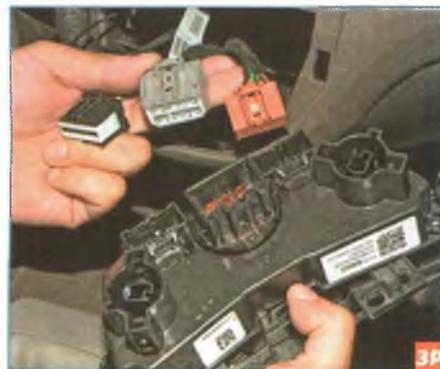
Нажав на фиксаторы колодок проводов, отсоединяем три колодки от разъемов блока...
