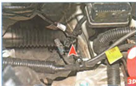
...отсоединяем ее от колодки жгута проводов датчика. Снимаем держатель колодки жгута проводов датчика со шпильки (показана на фото стрелкой) на лонжероне.
