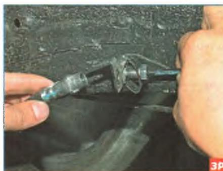
Выводим конец трубки из отверстия верхнего наконечника шланга и извлекаем наконечник шланга из отверстия в кронштейне кузова.
