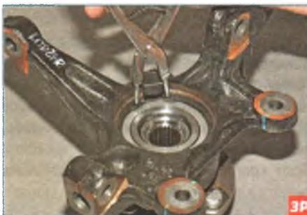
Специальными щипцами для снятия стопорных колец...
