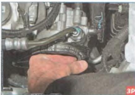
...и сдвигаем ремень со шкива насоса гидроусилителя.
