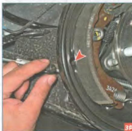
Вынимаем заглушку и через окно оцениваем состояние передней тормозной колодки (для наглядности показано при снятом барабане).
