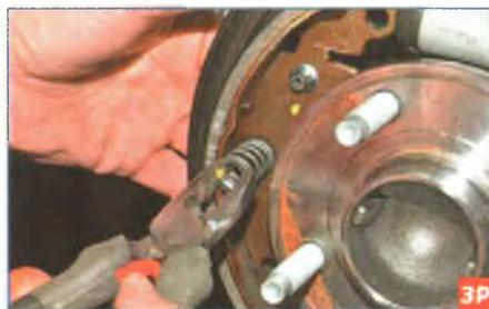
Придерживая с обратной стороны щита тормозного механизма опорную стойку передней колодки, пассатижами нажимаем на опорную чашку пружины стойки (сжимая пружину) и поворачиваем чашку до совмещения ее паза с хвостовиком стойки.
