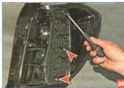
Крестообразной отверткой отворачиваем три самореза крепления держателя ламп.
