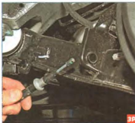
Выводим наконечники средних тросов стояночного тормоза из отверстий кронштейнов на рычагах балки задней подвески (см. «Снятие элементов стояночной тормозной системы», с. 191).
