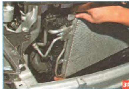
...и приподнимаем правую сторону конденсатора, выводя его кронштейны из нижнего и верхнего держателей.
