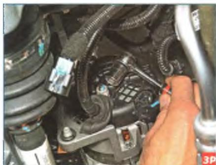
Головкой «на 13» отворачиваем гайку...
