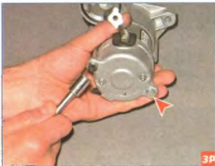
Головкой «на 10» отворачиваем два стяжных болта.
