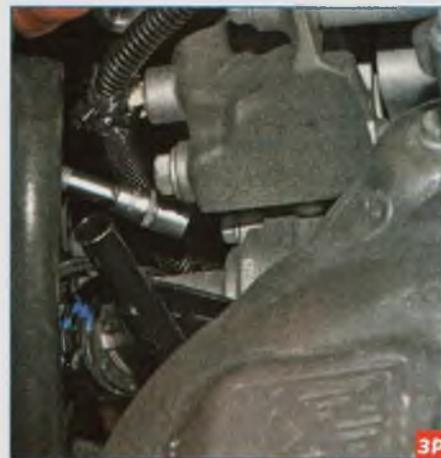
...головкой «на 10» с удлинителем отворачиваем два болта крепления корпуса термостата к передней крышке блока цилиндров.
