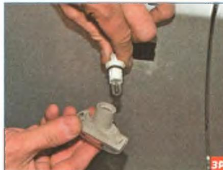
Повернув патрон лампы против часовой стрелки, вынимаем патрон с лампой из корпуса указателя.
