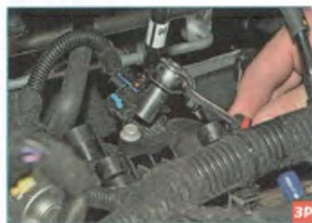
Головкой «на 10» отворачиваем болт крепления датчика к впускному трубопроводу...
