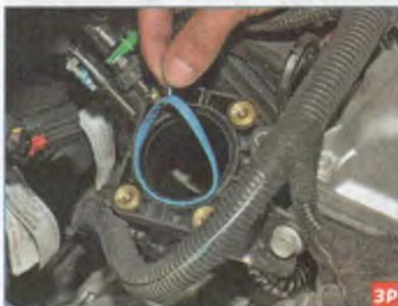
Вынимаем резиновую уплотнительную прокладку из канавки фланца впускного трубопровода.
