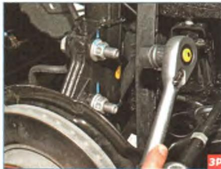
Головкой «на 21» отворачиваем гайку двух болтов крепления корпуса стойки к поворотному кулаку.
