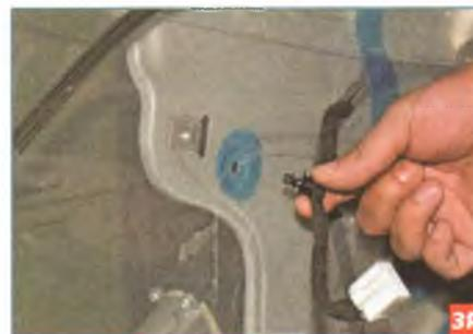
Вынимаем пластмассовый держатель жгута проводов электростеклоподъемника из отверстия во внутренней панели двери.
