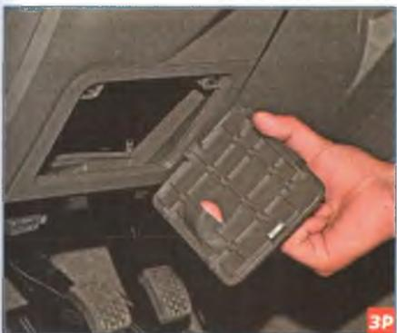
...снимаем крышку монтажного блока в салоне. Через отверстие в панели приборов...
