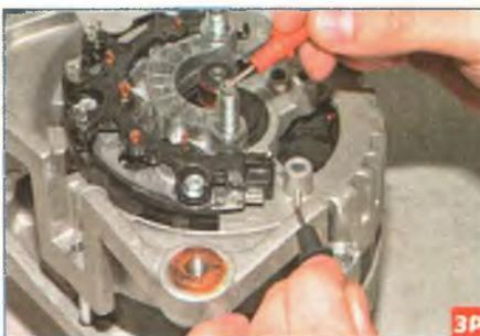
...«плюс» цифрового тестера (в режиме проверки диодов) подсоединяем
