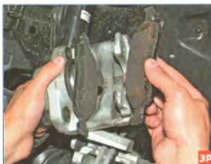
...вынимаем из суппорта наружную тормозную колодку.
