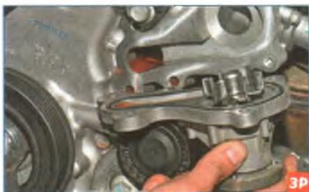
...и снимаем насос.
