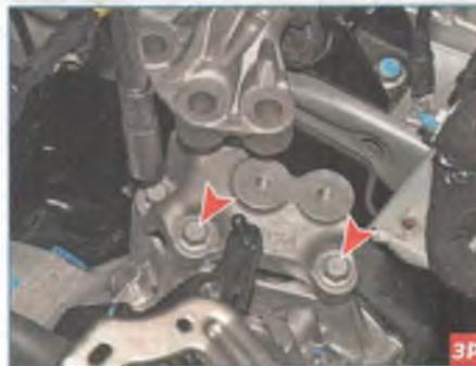
Головкой «на 15» отворачиваем три болта крепления кронштейна к картеру коробки передач.
