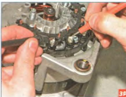
...подсоединяем щупы тестера (в режиме омметра) к выводам обмоток.
