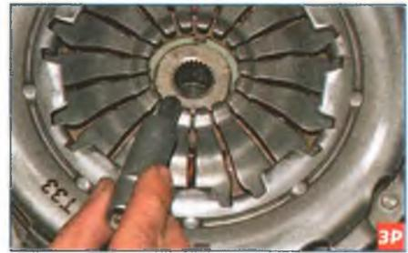
Вставляем центрирующую оправку в шлицы ступицы ведомого диска и вводим хвостовик оправки в отверстие фланца коленчатого вала.
