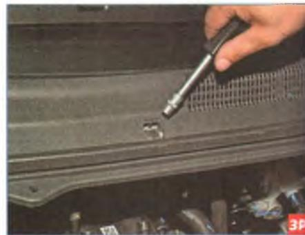
Головкой «на 7» отворачиваем болт, расположенный под заглушкой...
