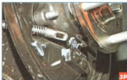
...выводим наконечник из отверстия в щите тормозного механизма...
