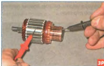
...подсоединяем щупы тестера (в режиме омметра) к коллектору и «железу» якоря.
