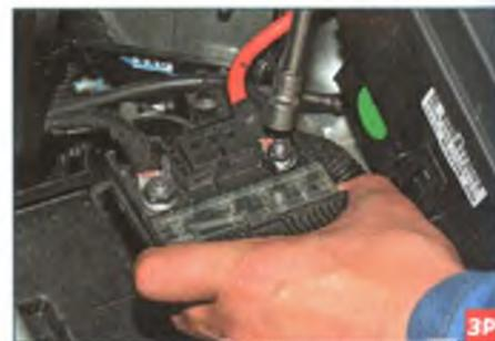
Головкой «на 10» отворачиваем гайку...
