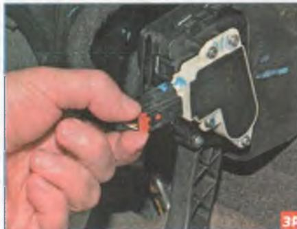
Выдвигаем стопор (красного цвета) фиксатора колодки жгута проводов...
