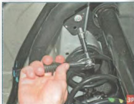
Головкой «на 10» с удлинителем отворачиваем болт нижнего крепления наливной трубы к кузову.
