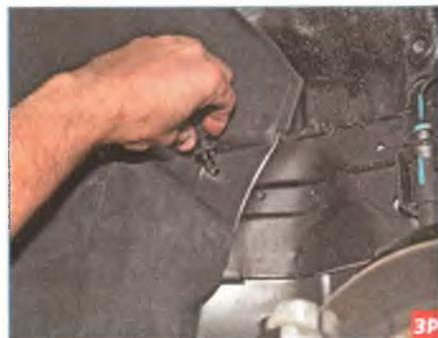
...и вынимаем пистон из отверстия кузова.
