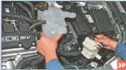
...отводим бачки от кожуха вентилятора назад и размещаем их на силовом агрегате.
