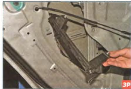
...и извлекаем направляющую стекла через технологическое отверстие во внутренней панели двери.
