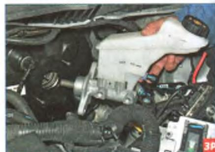
Сдвигаем главный тормозной цилиндр вперед по шпилькам вакуумного усилителя тормозов и снимаем его в сборе с бачком гидроприводов тормозов и сцепления.
