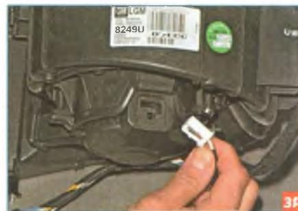
Нажав на фиксатор колодки проводов, отсоединяем колодку от разъема электродвигателя вентилятора.
