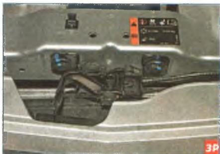
Замок капота крепится к передней стороне верхней поперечины рамки радиатора.
