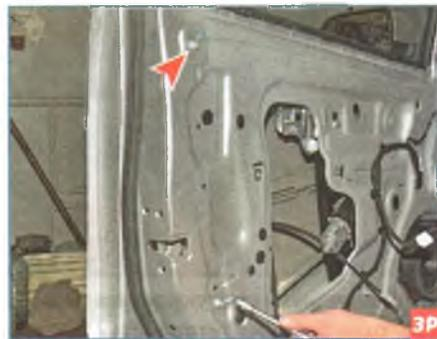
Головкой «на 10» отворачиваем две гайки крепления направляющей стекла к внутренней панели двери.
