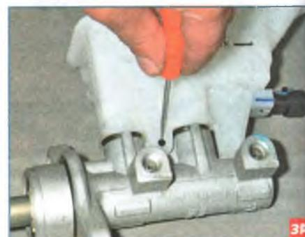
Тонкой отверткой выталкиваем штифт крепления бачка к корпусу главного тормозного цилиндра...
