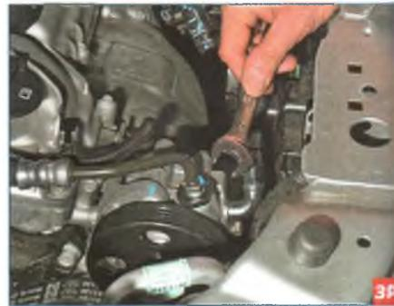
Ключом «на 16» отворачиваем штуцер крепления трубки нагнетательной магистрали к насосу...
