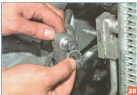
Снимаем уплотнительные кольца с трубок.
