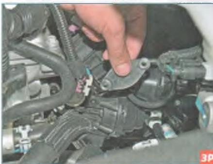
...и снимаем упорную пластину.
