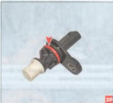
Корпус датчика уплотняется в гнезде блока цилиндров резиновым кольцом. При повреждении уплотнительного кольца (трещины, разрывы) или потере им эластичных свойств, заменяем кольцо новым. Устанавливаем датчик положения коленчатого вала в обратной последовательности.
