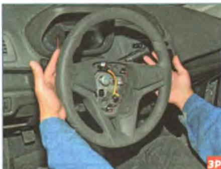
Покачивая, тянем на себя рулевое колесо и снимаем его со шлицев вала. Полностью отворачиваем винт крепления рулевого колеса.
