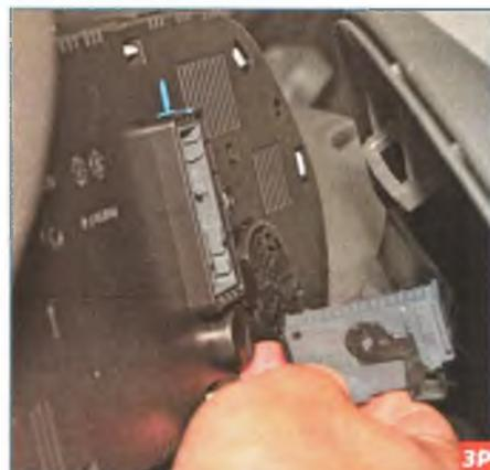
...и отсоединяем колодку от разъема комбинации приборов.
