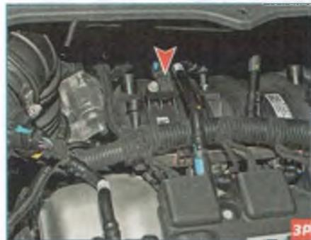
Расположение на двигателе датчика абсолютного давления воздуха.
