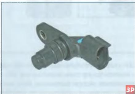
Датчик положения распределительного вала
