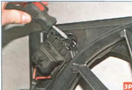
Шлицевой отверткой освобождаем фиксатор дополнительного резистора...
