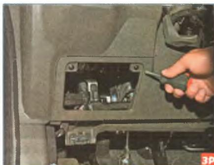
Крестообразной отверткой отворачиваем два самореза крепления рамки крышки нижней накладке панели приборов...
