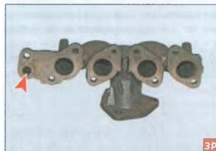
Из выпускного коллектора отработавшие газы попадают в полость левого торца головки блока цилиндров через канал, выполненный во фланце патрубка коллектора для 4-го цилиндра
