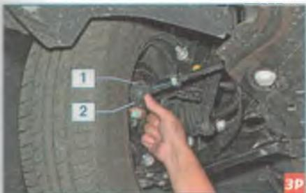
...к корпусу шарового шарнира 1 наконечника рулевой тяги и рычагу поворотного кулака 2, оцениваем их взаимное перемещение.
