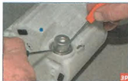
Поддеваем двумя шлицевыми отвертками регулятор и, преодолевая сопротивление двух его резиновых уплотнительных колец...
