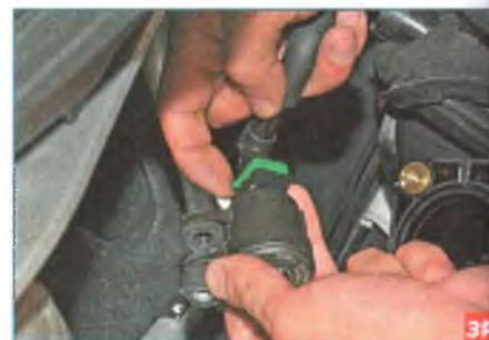
Выдвигаем стопорный элемент фиксатора наконечника трубки подвода паров топлива к клапану...
