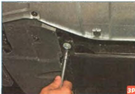
Тем же инструментом отворачиваем два болта переднего крепления защиты к нижней поперечине рамки радиатора.
