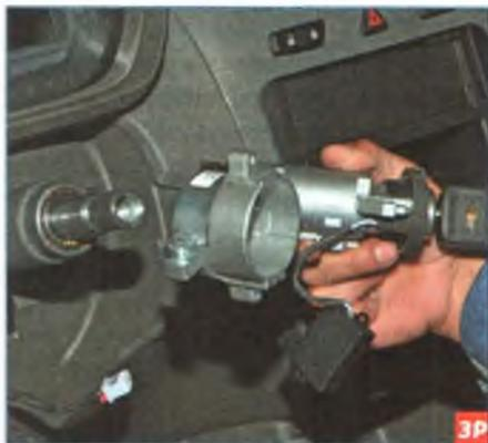
Снимаем выключатель зажигания (см. «Снятие катушки с блоком управления иммобилайзером и выключателя зажигания», с. 204).
