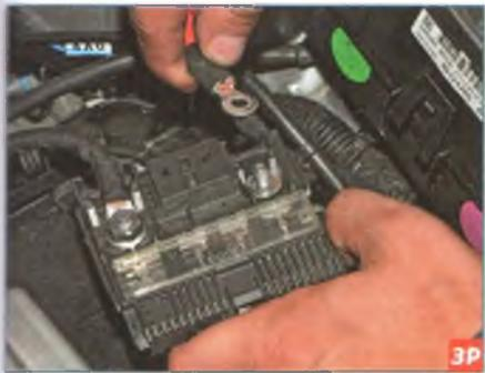
...и отсоединяем провод, идущий к монтажному блоку в моторном отсеке.
