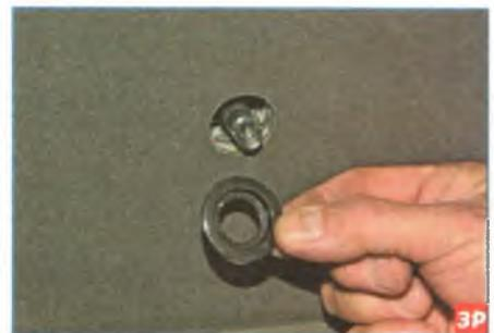
Снимаем розетку с вала.
