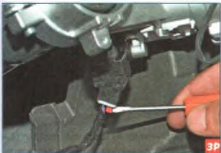
Отверткой сдвигаем стопор фиксатора колодки...
