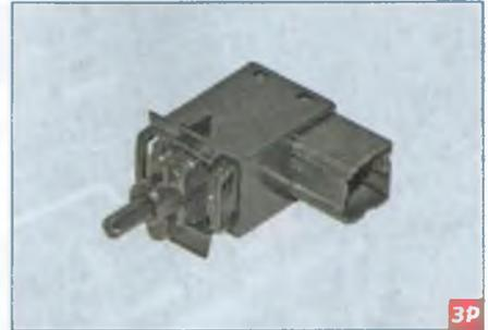
Датчик положения педали сцепления. Устанавливаем датчик положения педали сцепления в обратной последовательности.
