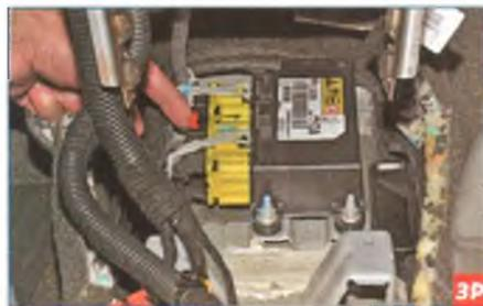
Сдвигаем стопор фиксатора...
