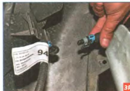
Через арку правого переднего колеса отжимаем фиксатор и разъединяем
