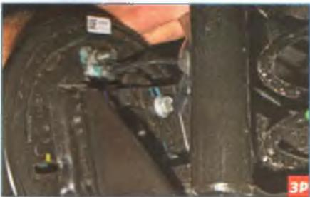
Головкой «на 15» с удлинителем отворачиваем четыре болта крепления
