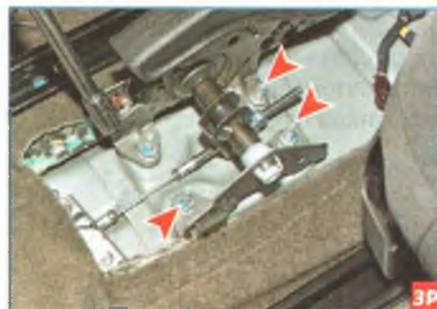
Головкой «на 13» отворачиваем четыре гайки крепления кронштейна рычага к туннелю пола...
