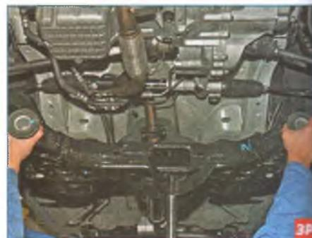
Опускаем подрамник и снимаем его с автомобиля вместе с рычагами передней подвески.
