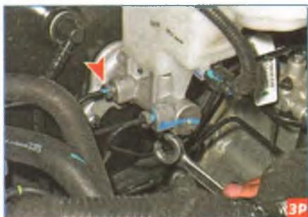
Специальным ключом «на 13» выворачиваем штуцеры двух тормозных трубок из отверстий в главном тормозном цилиндре...
