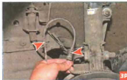
Вынимаем два резиновых держателя жгута проводов датчика из прорезей кронштейнов кузова и амортизаторной стойки. Металлической щеткой очищаем от загрязнений головку винта крепления датчика к поворотному кулаку.
