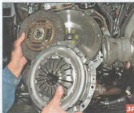
Демонтируем «корзину» и ведомый диск сцепления (см. «Снятие «корзины» и ведомого диска сцепления», с. 125).
