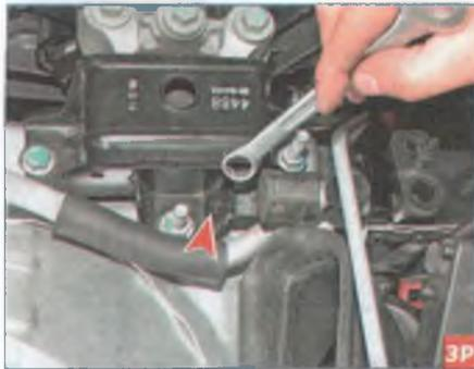
Накидным ключом «на 13» отворачиваем болт...
