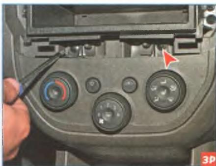
Крестообразной отверткой отворачиваем два самореза крепления блока управления отоплением, вентиляцией и кондиционированием к панели приборов.
