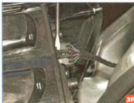
Поддев отверткой фиксатор колодки проводов...
