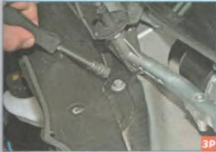
Головкой «на 10» отворачиваем четыре болта крепления облицовки щитка передка.
