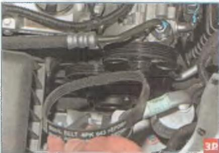
...вынимаем ремень из моторного отсека.
