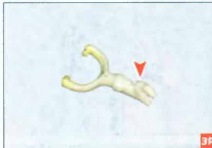
Рычаг привода устанавливаем так, чтобы выступ рычага (показан стрелкой) был обращен к коронной шестерне планетарного редуктора.
