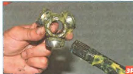
Снимаем трехшариковик с вала.
