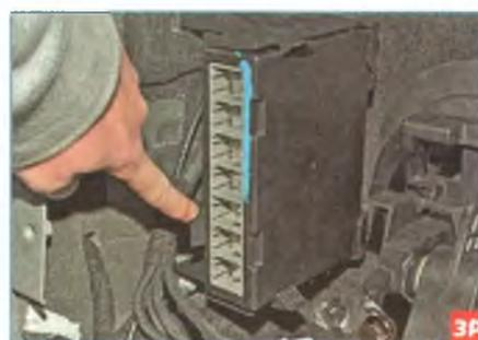
Нажав на фиксатор кронштейна...
