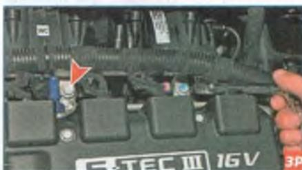
Головкой «на 13» с удлинителем отворачиваем два болта крепления топливной рампы к впускному трубопроводу.
