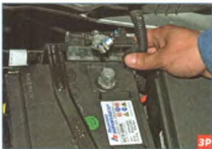
...и снимаем клемму проводов с блоком силовых предохранителей с вывода батареи.
