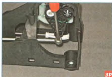
Отверткой отжимаем вниз наконечник троса выбора передач (для наглядности показано на снятом механизме управления)...
