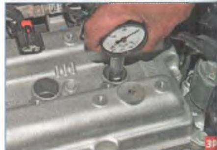
**Устанавливаем наконечник компрессометра в свечное отверстие головки блока цилиндров.**
