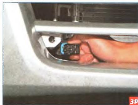
Потянув, вынимаем датчик из отверстия в бампере, преодолевая сопротивление фиксаторов датчика.
