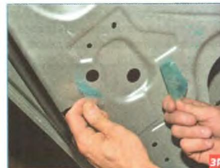
Отклеиваем защитные пленки с двух отверстий внутренней панели двери.
