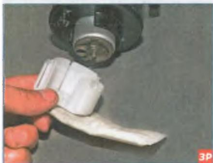
...и снимаем сетчатый фильтр с патрубка и штифта топливного насоса.
