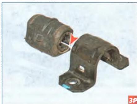
...разрез подушки должен быть обращен к передней части автомобиля.
