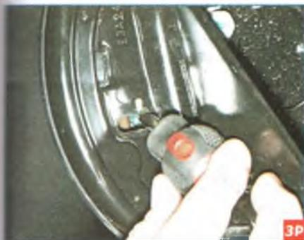
Через отверстие в щите отверткой надавливаем на рычаг привода стояночного тормоза, который закреплен на оси задней тормозной колодки. Для наглядности показываем эту операцию на снятой тормозной колодке. При нажатии на рычаг...
