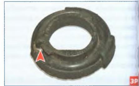
...конец нижнего витка пружины уперся в уступ прокладки (показан стрелкой), а фиксирующие лепестки прокладки обхватили нижний виток пружины.
