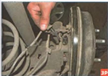
...и вынимаем датчик из отверстия в проставке для крепления ступичного узла.
