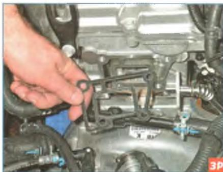
Снимаем металлическую обрезиненную прокладку выпускного патрубка. Перед установкой выпускного патрубка очищаем от загрязнений привалочные поверхности...
