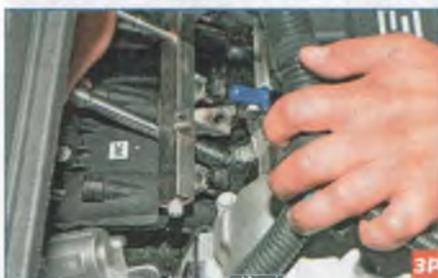
Головкой «на 13» с удлинителем отворачиваем на несколько оборотов болт верхнего правого крепления впускного трубопровода, который также крепит контактную («массовую») пластину, припаянную к кронштейну рампы.
