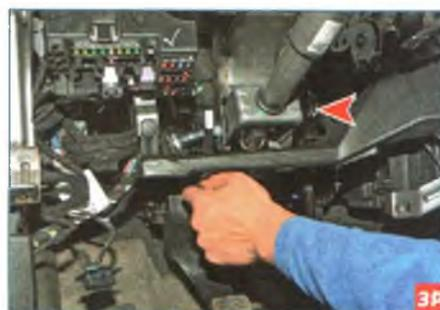
Под панелью приборов головкой «на 13» отворачиваем два болта крепления вилки нижней части рулевой колонки к каркасу панели приборов.
