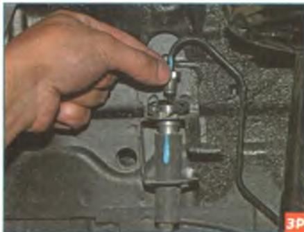
Разъединяем трубку и наконечник шланга...
