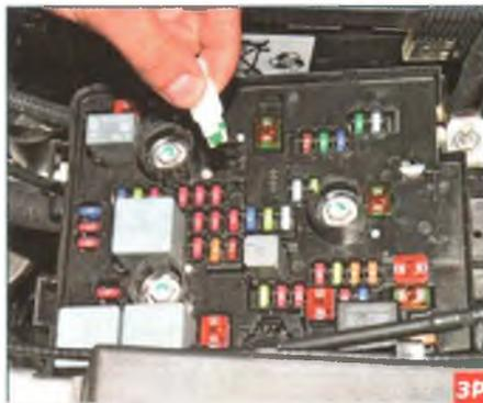
Пинцетом вынимаем предохранитель малого размера.
