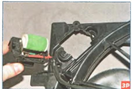
...и вынимаем резистор из гнезда кожуха.
