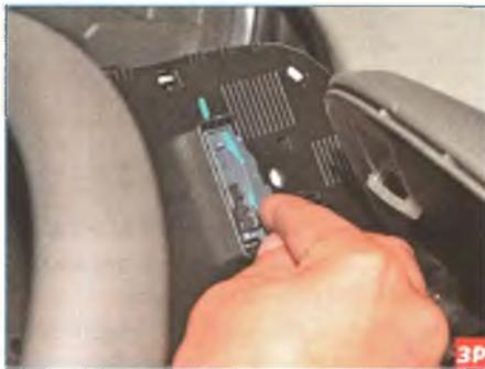
Пальцем нажимаем на стопор фиксатора колодки...
