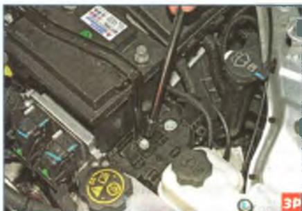
Головкой «на 13» отворачиваем болт...
