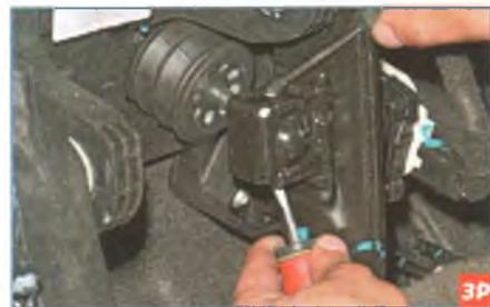
...отвертками через отверстия в корпусе шарового шарнира (расположен-
