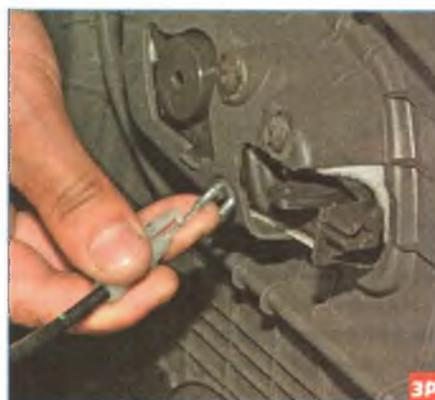
Выводим крючок троса из отверстия рычага ручки...
