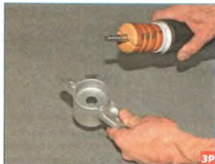
Снимаем верхнюю опору амортизатора с буфера хода сжатия.
