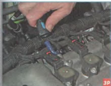
Нажав на фиксатор наконечника трубки, отсоединяем от штуцера клапана трубку подвода картерных газов в впускному трубопроводу.
