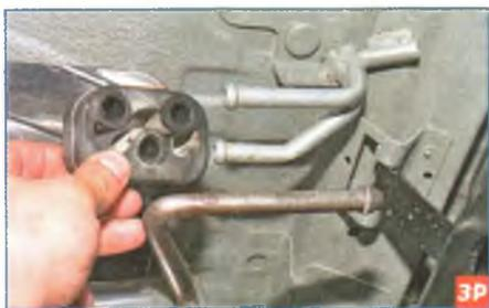
...стягиваем переднюю подушку глушителя с кронштейнов кузова и глушителя.
