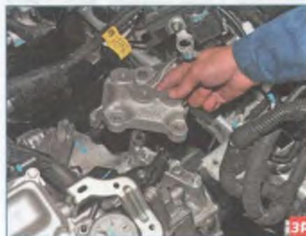
Вынимаем кронштейн из моторного отсека.
