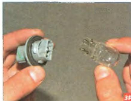
Потянув лампу, вынимаем ее из патрона.
