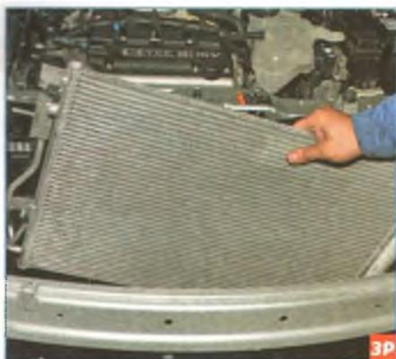
...и снимаем конденсатор.
