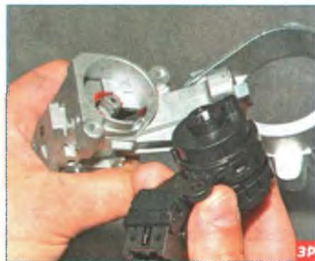
...и снимаем контактную группу выключателя зажигания.
