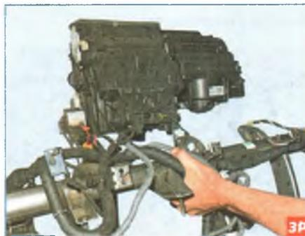
Разъединяем отопитель и каркас панели приборов.
