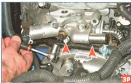
Головкой «на 13» отворачиваем два болта нижнего крепления выпускного патрубка к головке блока цилиндров. Выводим шпильки фланца выпускного патрубка из отверстий фланца трубки системы рециркуляции отработавших газов...
