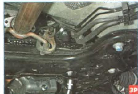
С правой стороны головкой E-18 с удлинителем отворачиваем винт крепления цилиндра рулевого механизма к подрамнику, удерживая гайку накидным ключом «на 18».
