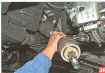
Снимаем привод левого колеса.
