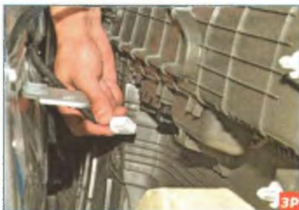
Нажав на фиксатор, отсоединяем колодку жгута проводов от выключателей электростеклоподъемников передних дверей.
