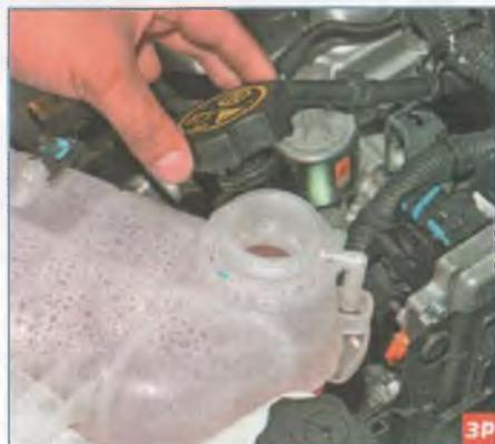
...отворачиваем и снимаем крышку расширительного бачка.
