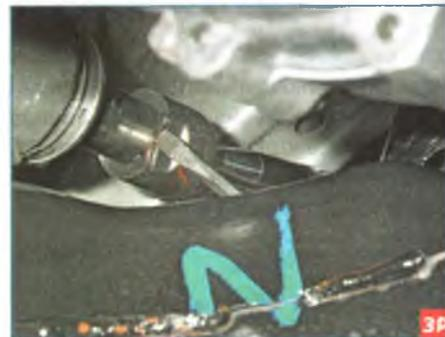
...большой отверткой выпрямляем замятую кромку шайбы.
