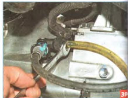
Надеваем на штуцер прозрачный шланг, другой конец которого опускаем в емкость, частично заполненную рабочей жидкостью так, чтобы свободный конец шланга был погружен в жидкость.
