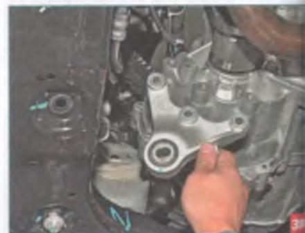
Снимаем кронштейн задней опоры.
