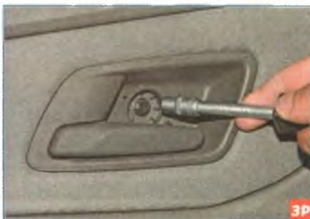
Головкой «на 7» отворачиваем саморез крепления ручки и обивки двери к внутренней панели двери.
