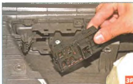
...и вынимаем из ниши обивки двери блок выключателей электростеклоподъемников.
