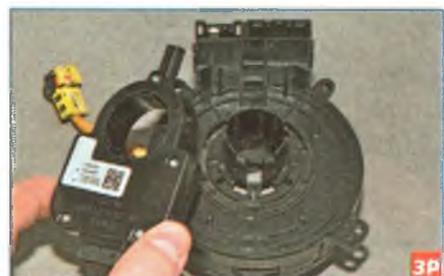
...и снимаем датчик с барабанного устройства.
