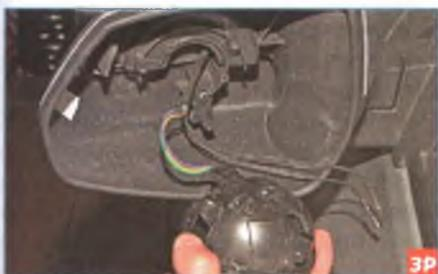
Выводим блок мотор-редукторов из корпуса зеркала.
