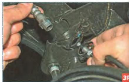
Выводим конец трубки из отверстия наконечника шланга и, вынув наконечник шланга из отверстия в кронштейне рычага балки задней подвески...
