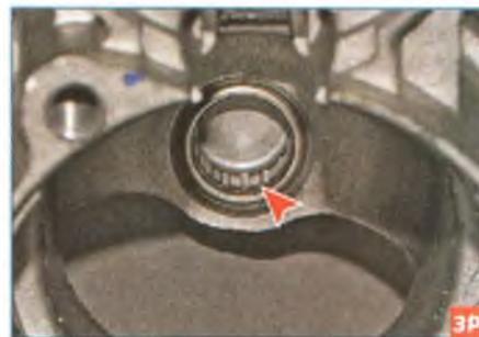
Проверяем состояние игольчатого подшипника в передней крышке стартера.
