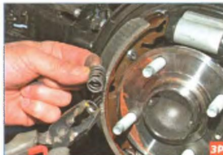
Снимаем опорную чашку с пружиной стойки.
