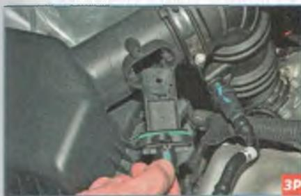
...и вынимаем датчик из отверстия в крышке воздушного фильтра.
