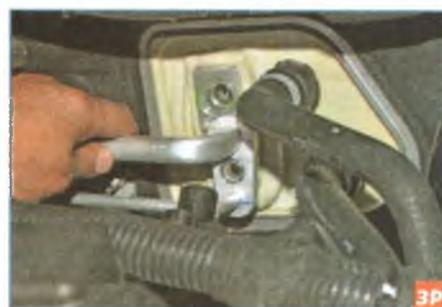
...и отсоединяем трубки системы кондиционирования от редуктора. Дальнейшие операции для наглядности показаны на снятом отопителе.
