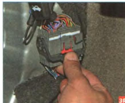
...поворачиваем фиксатор колодок проводов...
