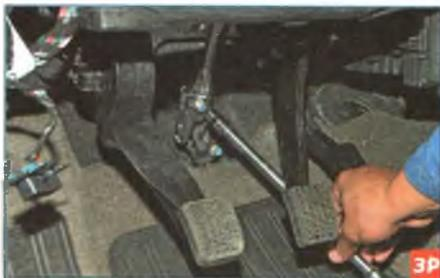
Головкой «на 11» с удлинителем ослабляем затяжку болта крепления клеммного соединения вилки нижнего карданного шарнира с промежуточным валом.
