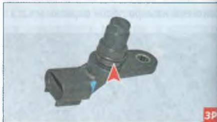
Датчик уплотняется в гнезде головки блока цилиндров резиновым кольцом. Устанавливаем датчик положения распределительного вала впускных клапанов в обратной последовательности. При повреждении уплотнительного кольца датчика (трещины, разрывы, замятия) или потере им эластичных свойств, заменяем кольцо новым.
