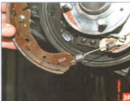
Снимаем переднюю колодку, отсоединив от нее крючок нижней стяжной пружины...
