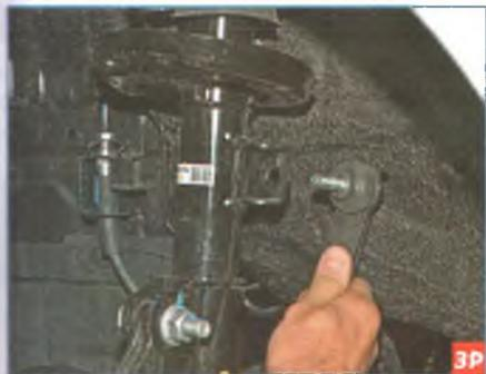
Выводим палец верхнего шарового шарнира стойки стабилизатора из отверстия кронштейна амортизаторной стойки.
