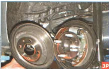
Снимаем барабан тормозного механизма заднего колеса (см. «Замена колодок тормозных механизмов задних колес», с. 180).
