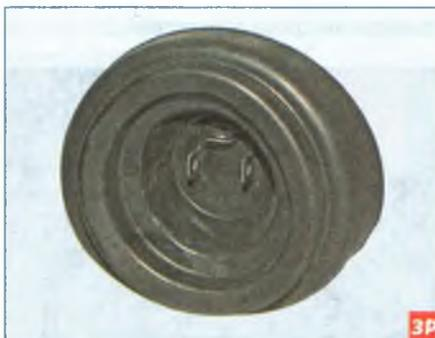
Устанавливаем защитный чехол так, чтобы контакты лампы вошли в отверстие чехла.
