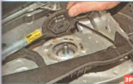
...и снимаем резинометаллическую шайбу верхнего крепления амортизаторной стойки.
