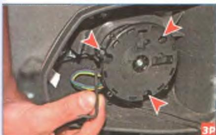
Ключом Torx T-10 отворачиваем три самореза крепления блока к корпусу зеркала.
