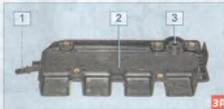
**Крышка катушек зажигания (обратная сторона):** 1 – штуцер трубки подвода картерных газов к дроссельному узлу; 2 – маслоотделитель; 3 – уплотнительная прокладка соединения с крышкой головки блока цилиндров
