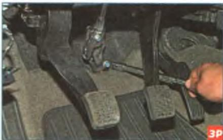
Тем же инструментом отворачиваем болт крепления клеммного соединения вилки нижнего карданного шарнира с валом приводной шестерни рулевого механизма...
