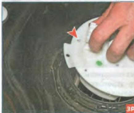
...чтобы метка на крышке модуля была направлена вперед (по направлению движения автомобиля).
