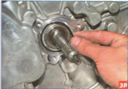
...заменяем его новым, установив в канавку картера сцепления.
