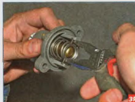
Преодолевая усилие пружины термостата, нажимаем губками пассатижей на запорную пластину...
