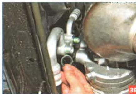
Снимаем уплотнительные кольца с трубок.
