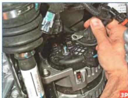
...и снимаем наконечник провода с вывода генератора.
