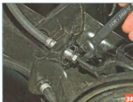
Специальным ключом «на 13» для штуцеров тормозных трубок отворачиваем штуцер крепления тормозной трубки (соединяющейся с колесным цилиндром) к нижнему наконечнику шланга.
