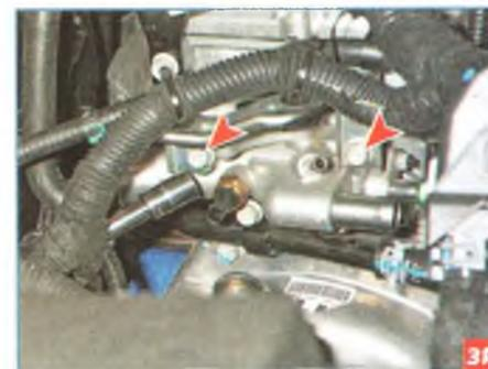
Головкой «на 13» отворачиваем два болта верхнего крепления выпускного патрубка и кронштейна жгута проводов к головке блока цилиндров...
