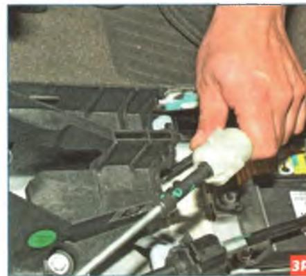
...отсоединяем наконечники тросов от рычага переключения передач и от рычага выбора передач и вынимаем наконечники их оболочек из корпуса механизма управления коробкой передач (см. «Замена тросов механизма управления коробкой передач», с. 134).
