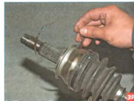
...и, расстегнув замок, снимаем хомут.
