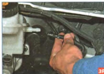
Стягиваем со штуцера бачка наконечник трубки подвода рабочей жидкости к главному цилиндру сцепления.
