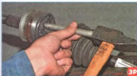
...выколоткой из мягкого металла сбиваем наружный шарнир со шлицов вала привода, нанося удары по торцу обоймы и при этом перемещая выколотку по окружности обоймы.
