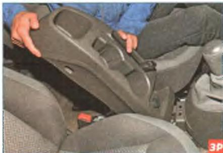
...выводим фиксаторы задней части облицовки из отверстий передней части облицовки туннеля пола.
