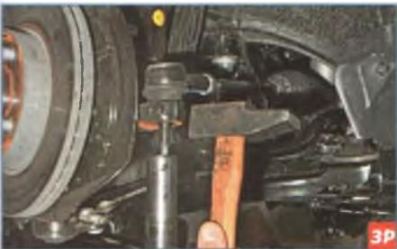
...устанавливаем регулируемый упор под палец и поджимаем его, после чего наносим удары молотком по торцу рычага поворотного кулака...
