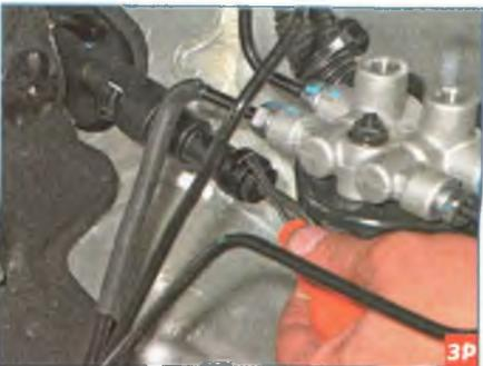
Поддев отверткой фиксатор наконечника трубки подвода жидкости к рабочему цилиндру...
