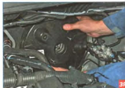
В моторном отсеке отводим вакуумный усилитель тормозов от щитка передка, выводя толкатель усилителя из отверстия в щитке...
