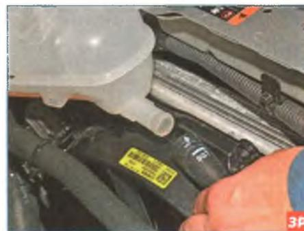
...снимаем шланг с нижнего патрубка бачка.
