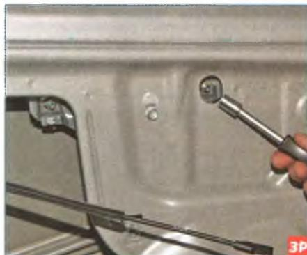
Ослабляем натяжку гаек крепления двух держателей стекла к ползуну стеклоподъемника (см. «Снятие стеклоподъемника задней двери», с. 246).
