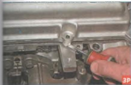
Аккуратно, чтобы не повредить поверхности крышки и головки блока цилиндров, отверткой поддеваем крышку за прилив под болт крепления...
