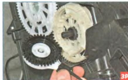
...и снимаем привод распределительных заслонок.
