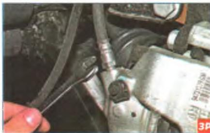
Ключом «на 14» ослабляем затяжку нижнего наконечника шланга тормозного механизма.
