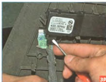
Отверткой поддеваем край разъема блока управления, выводя фиксатор колодки проводов из зацепления...
