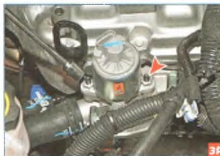
Головкой «на 13» с удлинителем отворачиваем две гайки крепления клапана к выпускному патрубку системы охлаждения.
