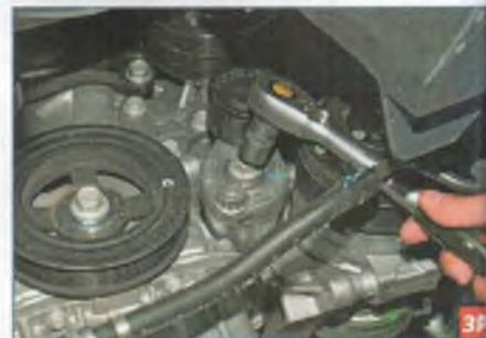
...головкой «на 15» отворачиваем болт крепления натяжного устройства.
