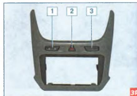
На центральной накладке расположены: 1 – выключатель центрального замка; 2 – выключатель аварийной сигнализации; 3 – заглушка.
