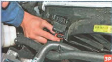
Слева на кожухе вентилятора отжимаем фиксатор колодки жгута проводов и отсоединяем ее от разъема дополнительного резистора вентилятора.
