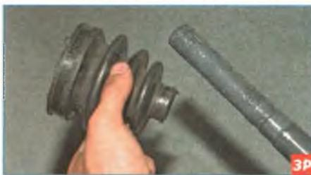
Стягиваем грязезащитный чехол с вала.
