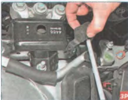
...и снимаем держатель воздушного фильтра.
