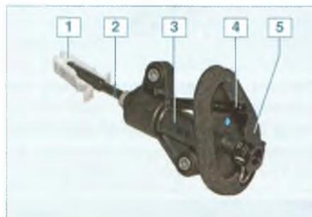
Главный цилиндр сцепления: 1 – фиксатор толкателя; 2 – толкатель; 3 – корпус главного цилиндра; 4 – штуцер для подсоединения трубки подвода жидкости; 5 – прокладка
