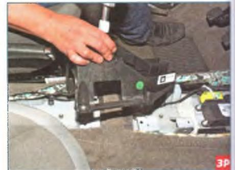
...и снимаем механизм управления коробкой передач.
