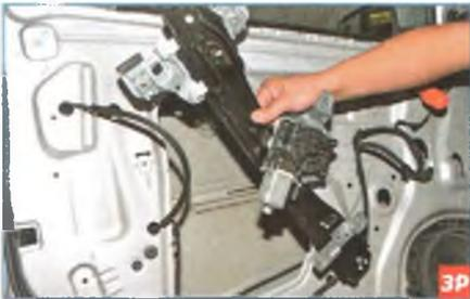
Вынимаем механизм электростеклоподъемника через технологическое отверстие во внутренней панели двери.
