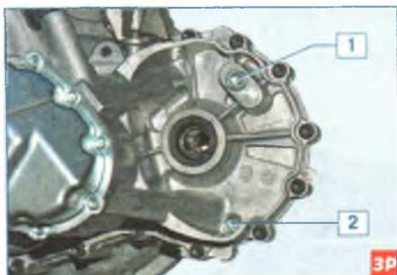
Пробки маслозаливного 1 и маслосливного 2 отверстий
