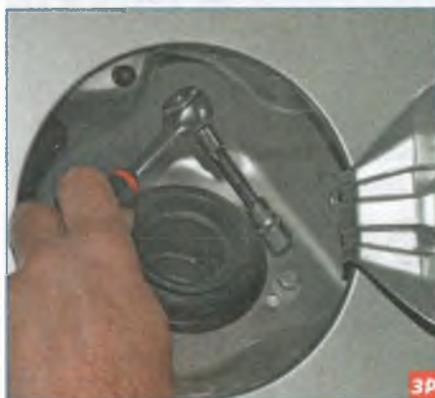
Головкой «на 10» с удлинителем отворачиваем болт верхнего крепления наливной трубы к кузову.
