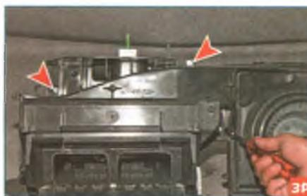
Головкой «на 5,5» отворачиваем три самореза крепления средней части корпуса отопителя.
