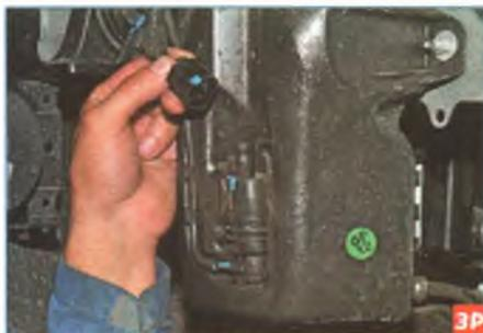
...нажав на фиксатор колодки проводов, отсоединяем колодку от разъема насоса.
