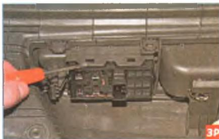
...шлицевой отверткой с тонким лезвием отжимаем стенку ниши обивки двери, выводя ее из зацепления с фиксаторами блока выключателей электростеклоподъемников...
