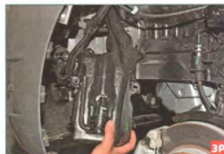
...и вынимаем его, выводя горловину бачка из моторного отсека.
