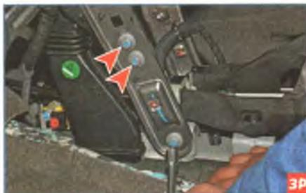
Головкой «на 13» отворачиваем три болта...
