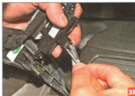
Поддев отверткой край разъема выключателя центрального замка, выводим из зацепления фиксатор колодки проводов...
