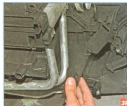
...и снимаем кожух трубок радиатора отопителя.
