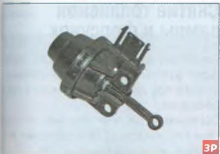
Пневмокамера механизмов изменения геометрии каналов во впускном трубопроводе
