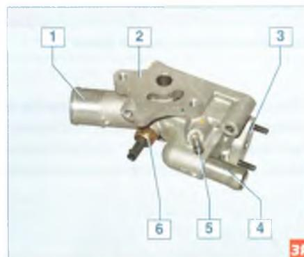
**Выпускной патрубок системы охлаждения:** 1 – патрубок для подвода жидкости к радиатору системы охлаждения; 2 – фланец для установки клапана рециркуляции отработавших газов; 3 – фланец для присоединения трубки рециркуляции отработавших газов; 4 – штуцер для подвода жидкости к радиатору отопителя; 5 – штуцер пароотводящего шланга; 6 – датчик температуры охлаждающей жидкости
