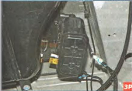
Адсорбер прикреплен к топливному баку справа.
