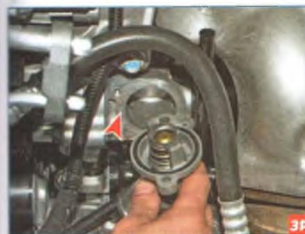
...привалочную поверхность передней крышки блока цилиндров.
