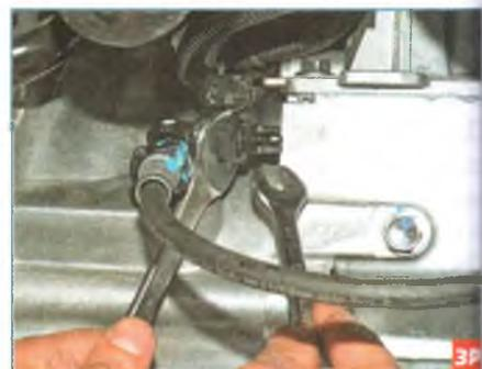
Ключом «на 11» ослабляем затяжку штуцера прокачки, удерживая переходник трубки ключом «на 17».
