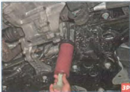
Шприцем (для трансмиссионного масла) доливаем масло в коробку передач до нижней кромки отверстия (масло начнет вытекать из отверстия). Заворачиваем и затягиваем пробку. Удаляем потеки масла с картера коробки передач.
