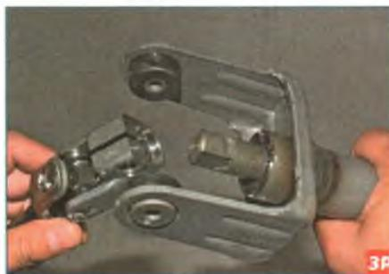
...и снимаем вилку карданного шарнира промежуточного вала с вала рулевого управления.
