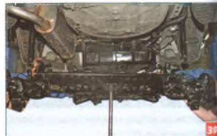
Опускаем балку задней подвески на регулируемом упоре, придерживая ее с обеих сторон.
