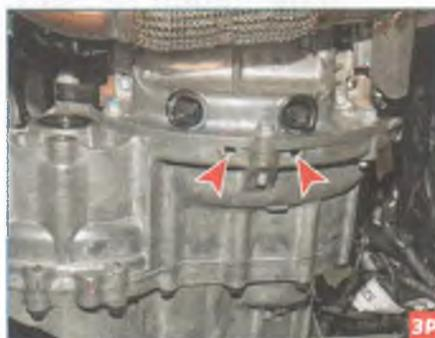
...через отверстия, расположенные снизу в зоне соединения поддона картера двигателя и картера сцепления.
