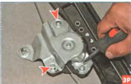
...крестообразной отверткой отворачиваем три самореза крепления мотор-редуктора к кронштейну...
