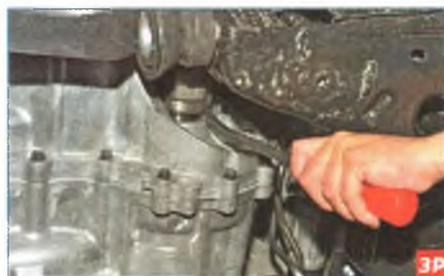
Опираясь монтажной лопаткой на картер коробки передач, преодолеваем сопротивление стопорного кольца и выталкиваем хвостовик корпуса внутреннего шарнира наружу из шлицевого отверстия полуосевой шестерни дифференциала.
