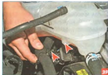
Выводим другой держатель шланга из отверстия в кронштейне расширительного бачка.
