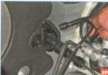
...и снимаем трубку подвода рабочей жидкости со штуцера главного цилиндра сцепления.
