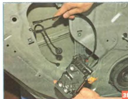
...и снимаем замок двери вместе с тросом внутренней ручки.
