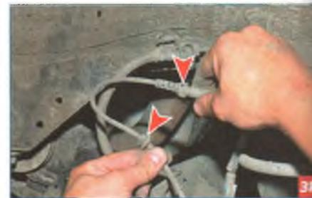
Выводим два резиновых держателя жгута проводов датчика из прорезей кронштейнов на кузове и рычаге балки задней подвески.
