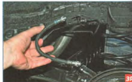
...снимаем шланг тормозного механизма заднего колеса.
