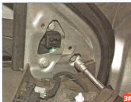
Головкой «на 10» с удлинителем отворачиваем три болта крепления кронштейна наружного зеркала к двери...
