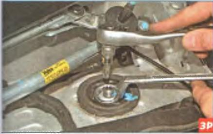
Удерживая шток ключом Torx T-50, не до конца отворачиваем гайку крепления стойки Z-образным ключом «на 24».
