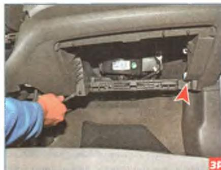
Головкой «на 7» отворачиваем два самореза крепления панели приборов к каркасу.
