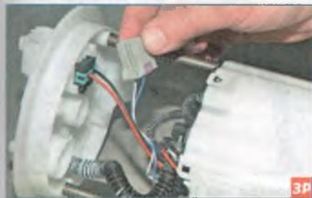
Раскручиваем колодку проводов датчика вокруг проводов топливного насоса, освобождая провода датчика.
