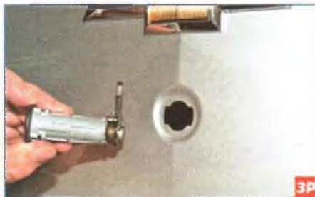
...и вынимаем цилиндр замка из отверстия крышки багажника.
