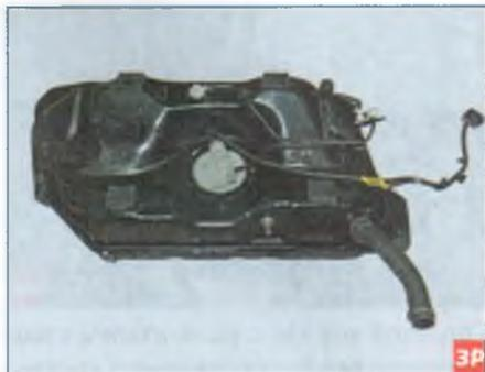
...в сборе с топливным модулем, жгутом проводов, шлангом наливной трубы и теплозащитным экраном.
