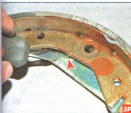
При этом штифт рычага зайдет на основание колодки и будет удерживать рычаг в положении, при котором он не будет надавливать на распорную планку тормозного механизма и раздвигать колодки.
