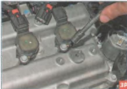
Головкой «на 10» отворачиваем болт крепления катушки зажигания.
