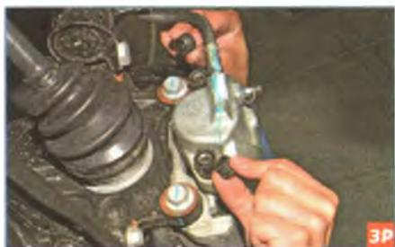
Снимаем крышки противоскрипных втулок обоих направляющих пальцев.
