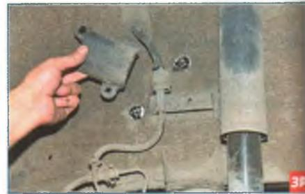
...и снимаем кожу со шпилек кузова.
