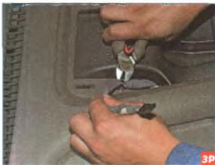
Бокорезами перекусываем держатель жгута проводов блока управления центральным замком.
