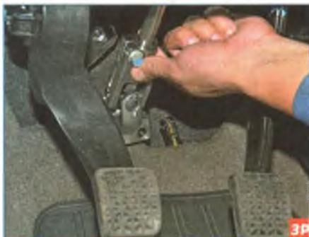
Сдвигаем вилку нижнего карданного шарнира промежуточного вала с вала приводной шестерни (см. «Снятие рулевой колонки», с. 164).
