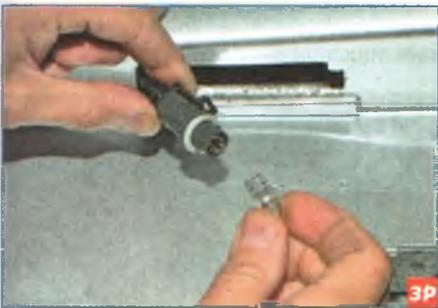
Потянув лампу, вынимаем ее из патрона. Устанавливаем новую лампу W5W в обратной последовательности. Аналогично меняем лампу в другом фонаре освещения номерного знака. Если нужно снять фонарь в сборе...
