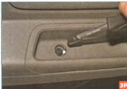
Головкой «на 7» отворачиваем саморез крепления обивки к кронштейну внутренней панели двери.
