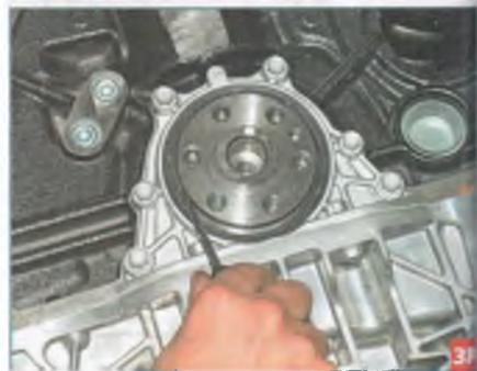
Шлицевой отверткой поддеваем сальник и вынимаем его из гнезда задней крышки блока цилиндров.
