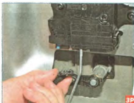
...и отсоединяем колодку жгута проводов от выключателя блокировки замка крышки багажника.
