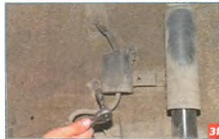
В арке колеса головкой «на 10» отворачиваем две гайки крепления кожуха, защищающего место соединения колодок жгута проводов кузова и жгута проводов датчика скорости вращения колеса...
