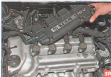
Снимаем крышку, не отсоединяя от нее трубку вентиляции картера...
