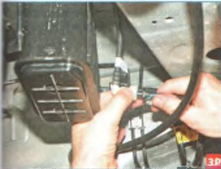
Нажав на фиксатор наконечника (белого цвета) трубки отвода паров топлива из адсорбера...
