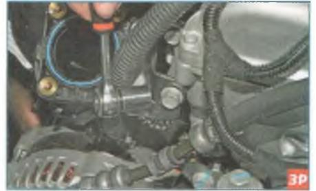
Головкой «на 13» отворачиваем болт крепления к головке блока цилиндров бокового кронштейна впускного трубопровода.
