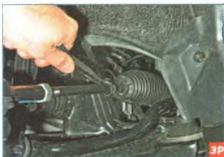
Пассатижами разжимаем малый хомут крепления защитного чехла и снимаем его с чехла.
