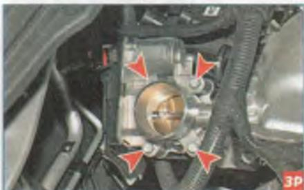
Расположение болтов крепления дроссельного узла к впускному трубопроводу.
