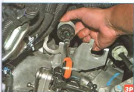
Аналогично вынимаем наконечник оболочки троса выбора передач из кронштейна.
