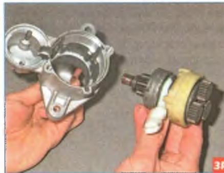
Вынимаем привод из передней крышки.
