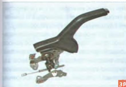
Рычаг стояночного тормоза в сборе с передним тросом
