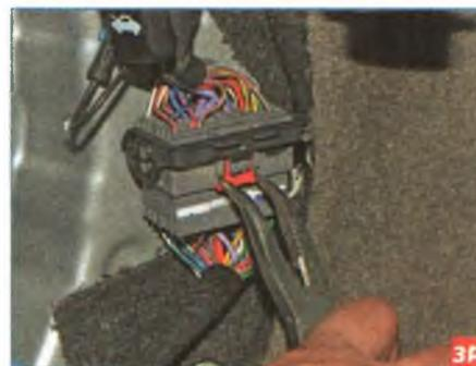
Пассатижами сдвигаем стопор фиксатора...
