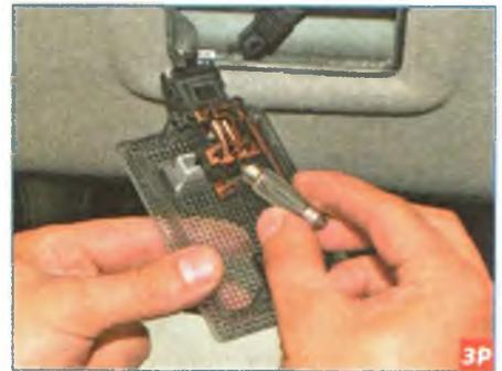
Вынимаем лампу из плафона. Устанавливаем новую лампу C10W (длиной 42 мм) в обратной последовательности.
