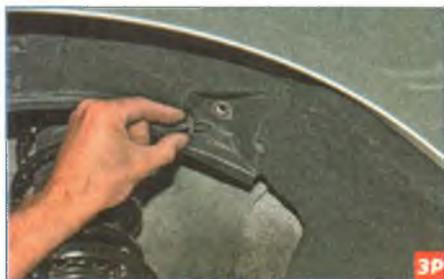
...и вынимаем пистон из отверстия кузова.
