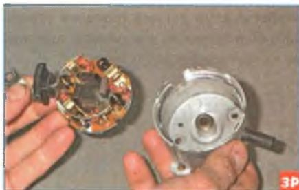
...и вынимаем щеткодержатель из задней крышки.
