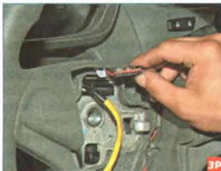
Выводим колодку жгута проводов звукового сигнала через отверстие в ступице рулевого колеса.
