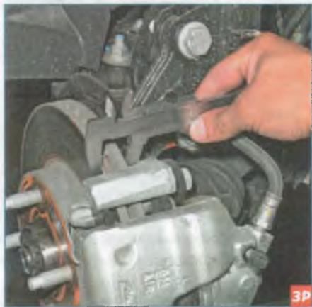
Штангенциркулем измеряем толщину диска, которая не должна быть менее 17,0 мм. При этом в разных частях диска она не должна отличаться более чем на 0,1 мм.
