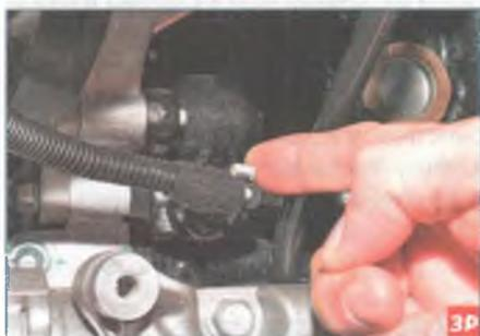
Сдвигаем стопор фиксатора колодки...
