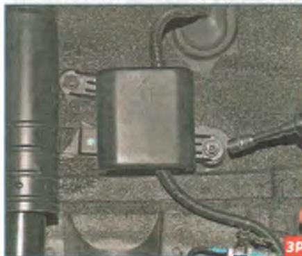
Головкой «на 10» с удлинителем отворачиваем две гайки крепления пластмассового кожуха, закрывающего соединение колодок жгута проводов кузова и жгута проводов топливного бака.
