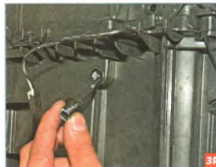
Повернув датчик против часовой стрелки, вынимаем его из корпуса отопителя.
