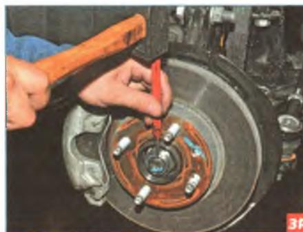
...и бородком заминаем цилиндрический поясок гайки в паз хвостовика наружного шарнира.
