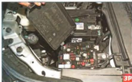
...и снимаем крышку, выводя ее фиксаторы из петель корпуса монтажного блока.
