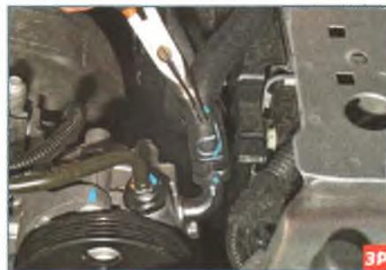
Сжимаем пассатижами концы хомута крепления шланга дополнительной магистрали и, сдвинув его по шлангу...
