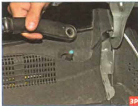
Снимаем с вала рычаг со щеткой очистителя. Аналогично снимаем другой рычаг со щеткой.
