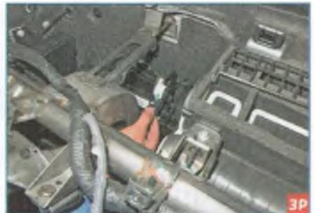
Выдвинув стопор (серого цвета) фиксатора колодки жгута проводов, и нажав на фиксатор...
