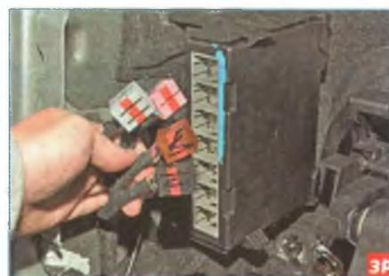
...и отсоединяем четыре колодки от разъемов блока.
