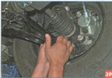
...отжимая вниз рычаг передней подвески, следим за перемещением корпуса шаровой опоры относительно поворотного кулака.
