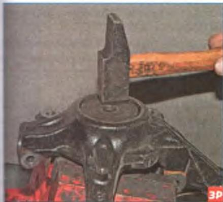
...и выбиваем подшипник из ступицы, используя толстую шайбу подходящего размера.
