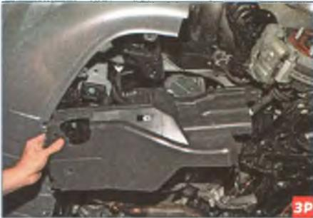
Снимаем левый щиток моторного отсека.
