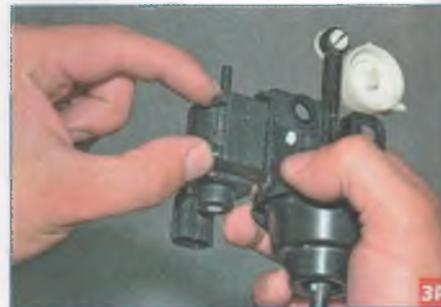
Сжав два фиксатора на кронштейне пневмокамеры механизма...
