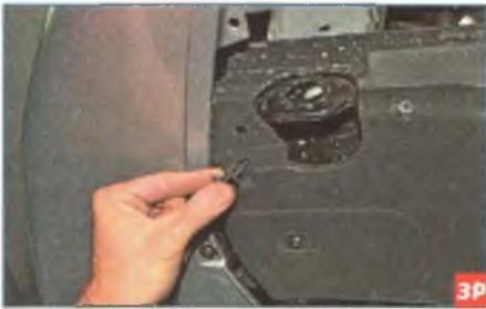
Аналогично вынимаем пистон крепления щитка снизу автомобиля.
