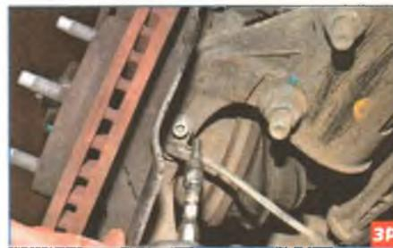
Шестигранником «на 5» отворачиваем винт крепления датчика скорости вращения колеса...
