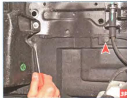
...поддеваем фиксаторы двух пластмассовых пистонов, крепления щитка к левому лонжерону кузова...
