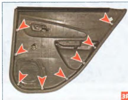
Расположение пистонов с внутренней стороны обивки задней двери. Поврежденные пистоны заменяем новыми. Устанавливаем обивку задней двери в обратной последовательности.
