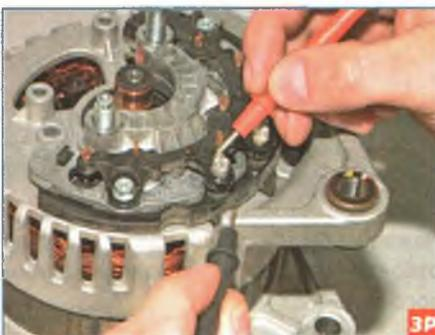
...подсоединяем щупы тестера (в режиме омметра) к выводу обмотки и корпусу генератора.
