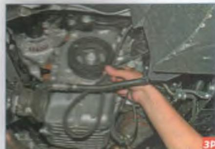
Вынимаем ремень из моторного отсека.
