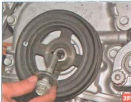
Отвернув, вынимаем болт с шайбой...
