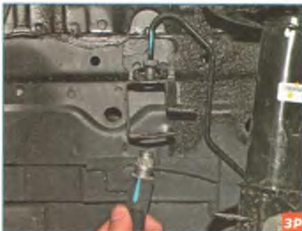
...и извлекаем верхний наконечник шланга из отверстия в кронштейне кузова.
