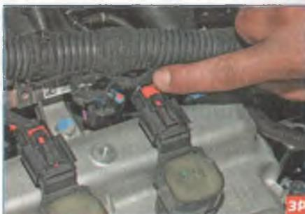
Сдвигаем стопор фиксатора колодки проводов...
