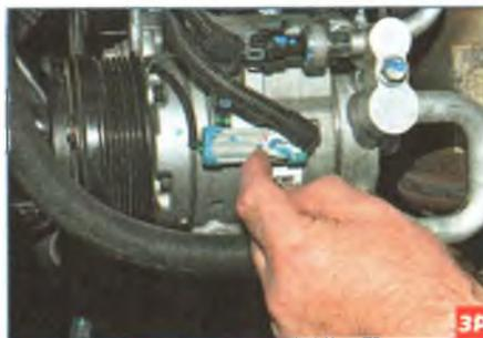
Отжимаем фиксатор колодки проводов...
