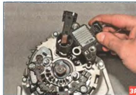
...и снимаем щеткодержатель с регулятором напряжения в сборе. Для проверки регулятора напряжения...
