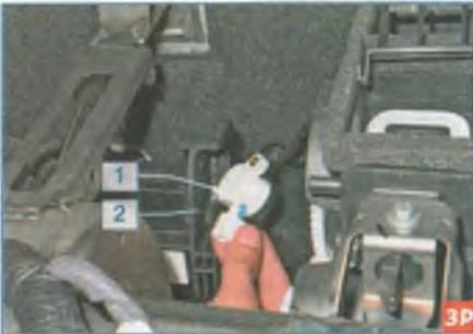
...и снимаем выключатель, выводя штифт 1 корпуса датчика из отверстия 2 в кронштейне педального узла...
