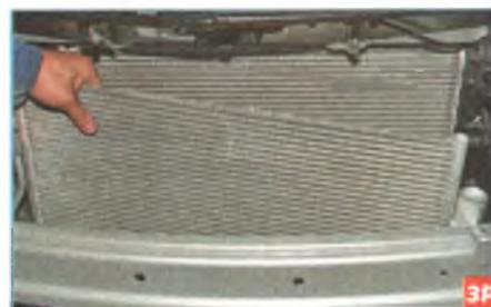
Не отсоединяя от конденсатора трубки, располагаем его перед радиатором.
