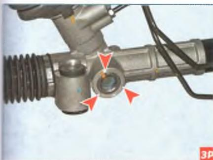
Регулировочная пробка зафиксирована на картере рулевого механизма методом кернения в трех местах
