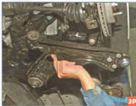
Снимаем рычаг передней подвески.
