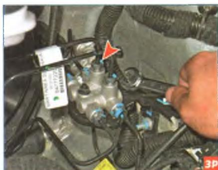
...и из отверстий в блоке регуляторов.
