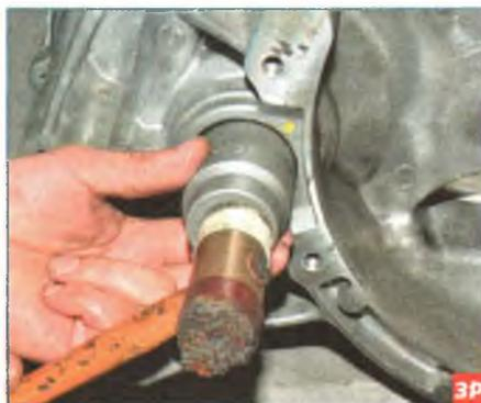
Оправкой подходящего размера запрессовываем сальник в гнездо картера сцепления.
