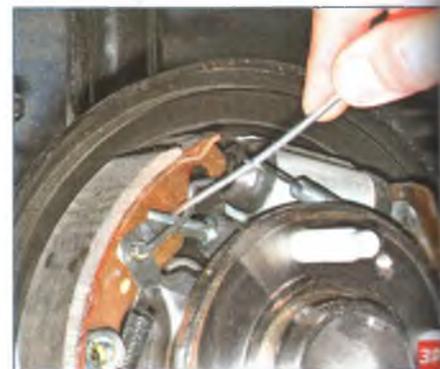
...а затем, зацепив стержнем отверстия другой крючок пружины, натягиваем пружину и вводим крючок в зацепление с серьгой механизма автоматической регулировки зазора.
