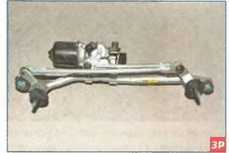
...устанавливаем кривошип на вал мотор-редуктора, как показано на фото. Затягиваем гайку крепления кривошипа. Дальнейшую установку очистителя ветрового стекла проводим в обратной последовательности.
