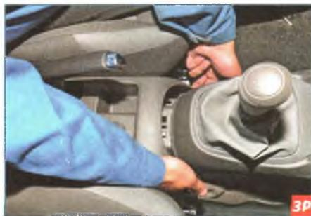
Приподняв заднюю часть облицовки туннеля пола...
