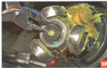
С помощью специальных щипцов для снятия стопорных колец...
