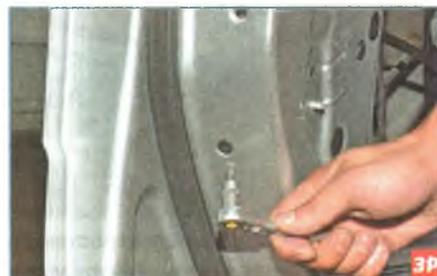
Ключом Torx T-30 отворачиваем винт крепления направляющей к торцу двери...
