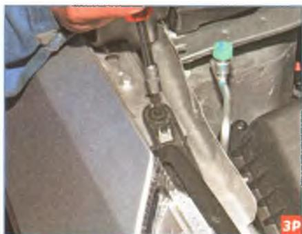
Головкой «на 7» отворачиваем саморез заднего верхнего...
