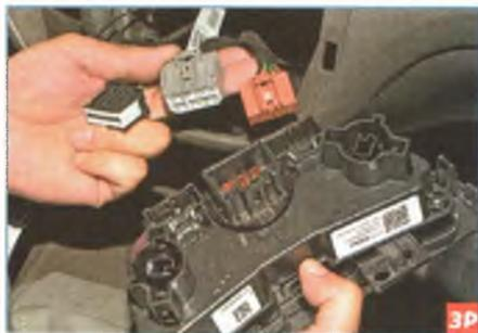
Снимаем с центральной консоли блок управления отоплением, вентиляцией и кондиционированием (см. «Снятие блока управления отоплением, вентиляцией и кондиционированием», с. 259).
