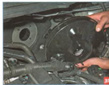
...и извлекаем усилитель из моторного отсека.
