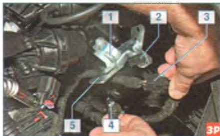
...сдвигаем с держателя 2, закрепленного на кронштейне 1 впускного трубопровода колодку 3 жгута проводов и вынимаем из отверстия 5 кронштейна держатель 4 жгута проводов.
