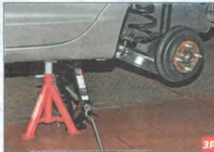
**Не работайте под автомобилем, если он вывешен только на домкрате. Для страховки используйте подставку заводского изготовления.**
