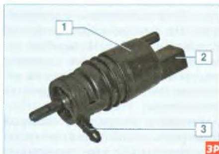
**Насос омывателя ветрового стекла:** 1 – электродвигатель; 2 – электрический разъем; 3 – штуцер подачи жидкости на ветровое стекло
