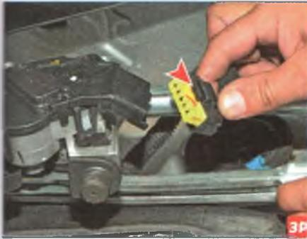
Отжав фиксатор колодки проводов (показан стрелкой), отсоединяем колодку от разъема очистителя...
