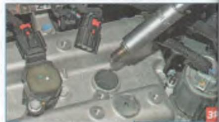
...и вынимаем ее из свечного колодца
