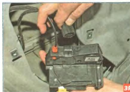
Нажав на фиксатор, отсоединяем колодку жгута проводов от электропривода замка...
