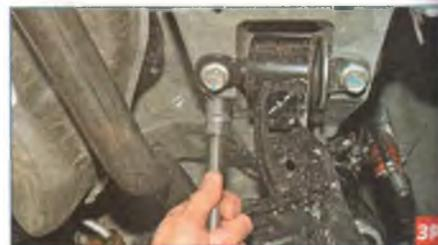
Головкой «на 21» с удлинителем отворачиваем два болта крепления к кузову оси сайлент-блока левого рычага...
