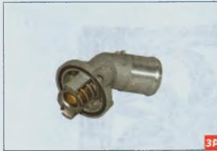
...и вынимаем термостат в сборе.
