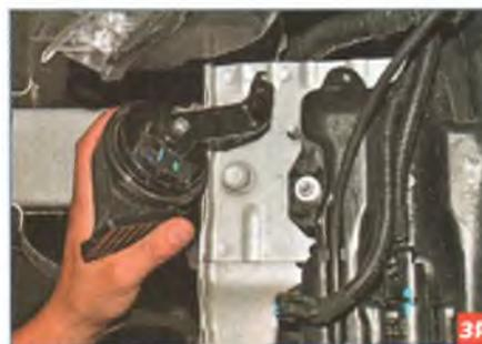
Снимаем сигнал с кронштейном. Устанавливаем звуковой сигнал в обратной последовательности.
