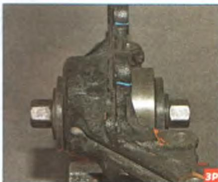
Чашечным съемником запрессовываем новый подшипник в кулак, прикладывая усилие к наружному кольцу подшипника.
