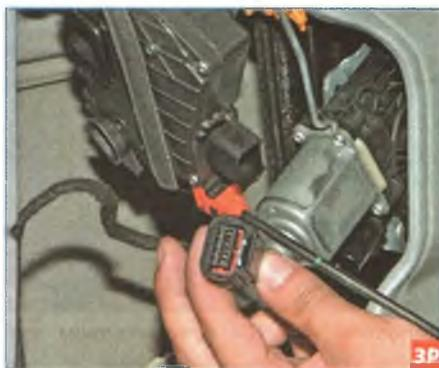
Нажав на фиксатор, отсоединяем колодку жгута проводов от электропривода замка и снимаем замок двери.
