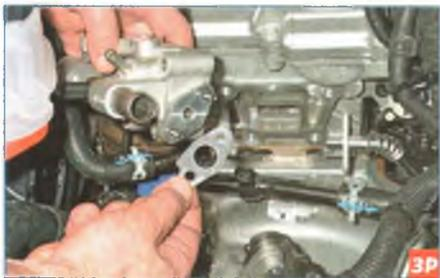
Снимаем уплотнительную прокладку со шпилек фланца выпускного патрубка.
