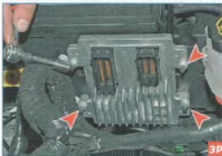
Головкой «на 10» отворачиваем четыре гайки крепления блока управления к его кронштейну...
