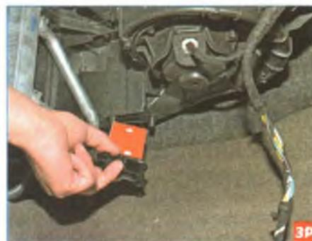
...и вынимаем резистор из корпуса отопителя.
