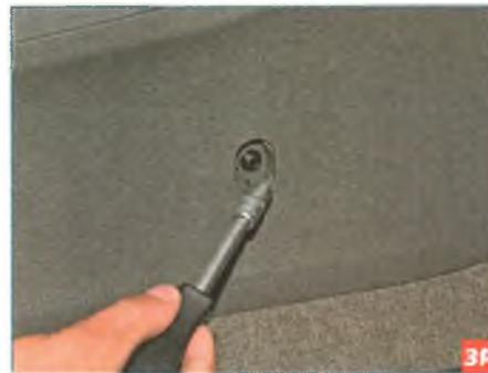
Головкой «на 7» отворачиваем с обеих сторон облицовки саморезы крепления ее передней части.
