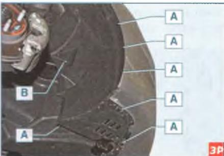
...снизу автомобиля ключом Torx T-20 отворачиваем шесть саморезов А крепления подкрылка и вынимаем пистон В крепления подкрылка кузову.
