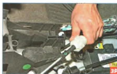
Аналогично вынимаем трос выбора передач из корпуса механизма.
