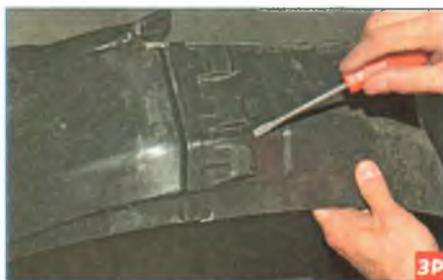
...отверткой освобождаем фиксирующие лепестки передней части подкрылка...
