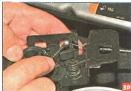
Отверткой выводим шаровой наконечник троса привода из паза рычага замка.
