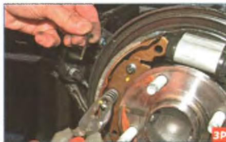
Через отверстие в щите тормозного механизма вынимаем опорную стойку передней колодки.
