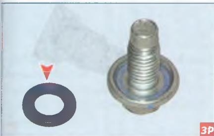
Проверяем состояние резиновой уплотнительной прокладки пробки.
