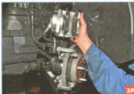
Снимаем суппорт тормозного механизма вместе с колодками и располагаем его на направляющей колодок так, чтобы не был сильно натянут шланг тормозного механизма.
