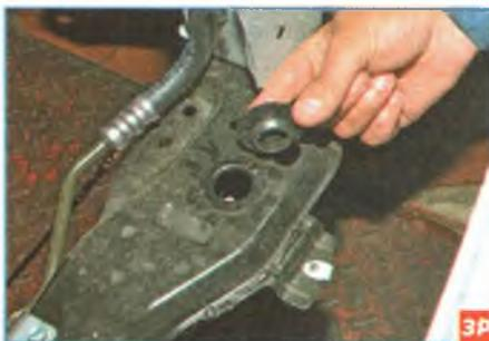
Вынимаем подушки нижних опор радиатора из отверстий в нижней поперечине рамки радиатора.
