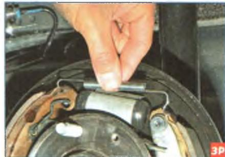
...и снимаем пружину.
