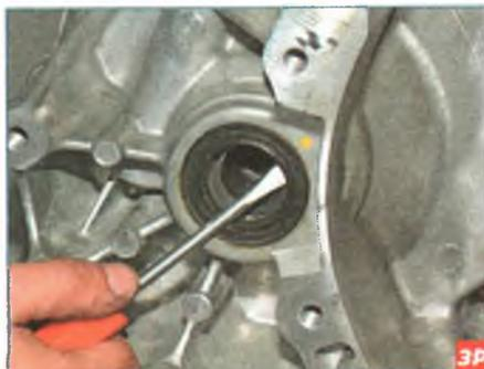
Поддеваем отверткой сальник привода...
