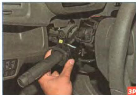
...и вынимаем левый подрулевой переключатель из соединителя.
