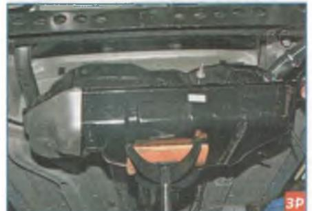
Опускаем на регулируемом упоре топливный бак и снимаем его...
