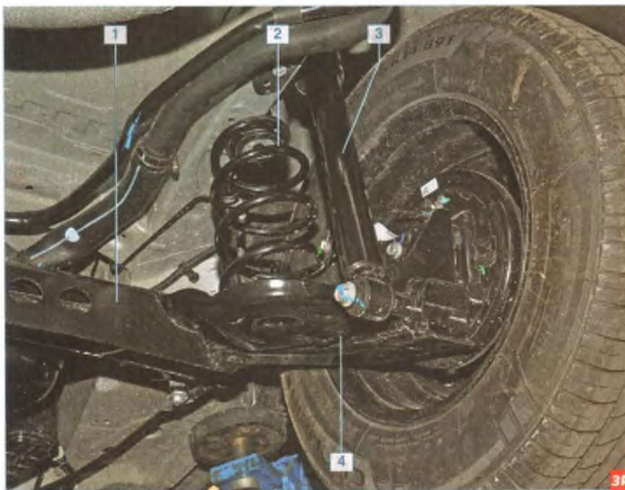
Элементы задней подвески на автомобиле: 1 – балка; 2 – пружина; 3 – амортизатор; 4 – рычаг балки
