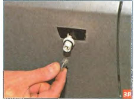
Вынимаем лампу из патрона.
