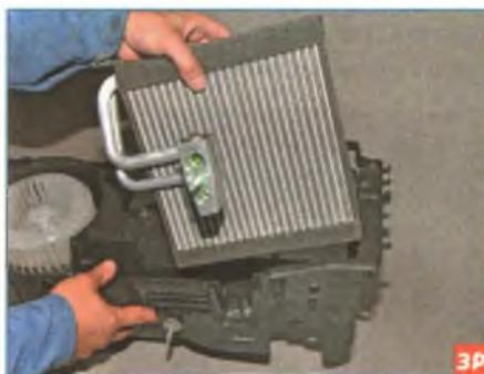
Вынимаем испаритель из нижней части корпуса отопителя.
