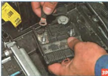
...и отсоединяем провод, идущий к стартеру и генератору...
