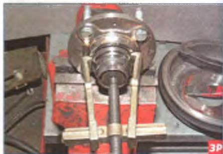
...или используя двухзахватный съемник, спрессовываем...
