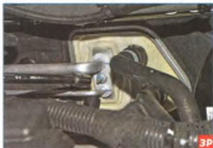
Головкой «на 13» отворачиваем гайку...
