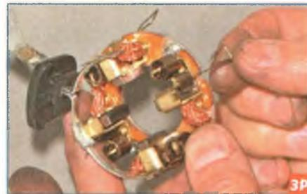
...утапливаем щетки в держатели и вставляем под концы пружин щеток отрезки проволоки (например, канцелярские скрепки).
