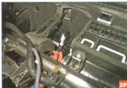
Отсоединяем колодку жгута проводов от выключателя сигналов торможения (см. «Снятие выключателя сигналов торможения», с. 81).
