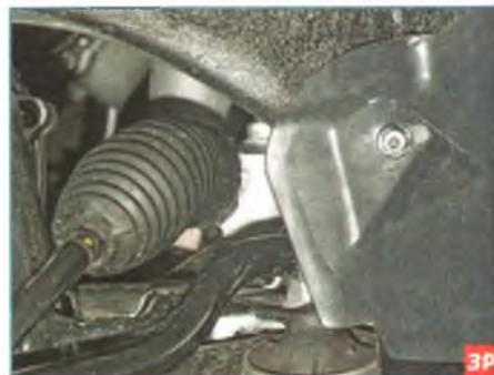
Снимаем чехол рулевого механизма (см. «Замена чехла рулевого механизма», с. 167).
