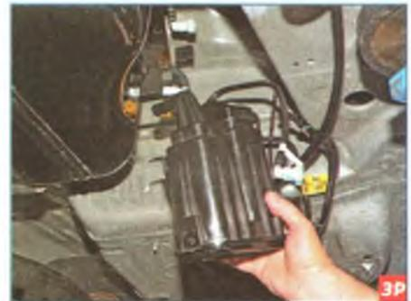
...и снимаем адсорбер в сборе с кронштейном и трубкой отвода паров топлива.
