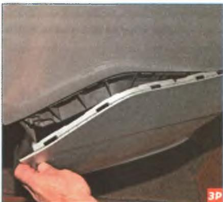
Потянув, отделяем левую боковину бампера от кузова, преодолевая сопротивление фиксаторов пластмассового держателя.
