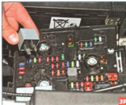
Реле вынимаем из блока рукой.
