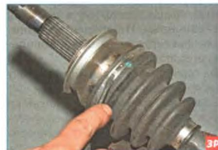
...отверткой поджимаем запорный усик хомута...
