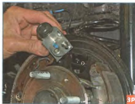
...и снимаем цилиндр.
