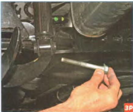
Отворачиваем и вынимаем болт нижнего крепления левого амортизатора к рычагу балки (см. «Снятие амортизатора», с. 157).
