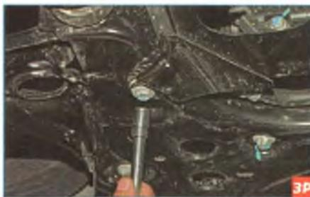
...головкой «на 13» отворачиваем два болта заднего крепления защиты силового агрегата к подрамнику передней подвески.
