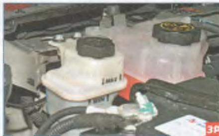
На корпусе бачка нанесены метки MAX и MIN, между которыми должен находиться уровень рабочей жидкости при холодном двигателе.
