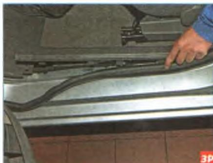
...снимаем облицовку, преодолевая сопротивление фиксаторов.
