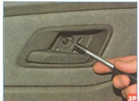
Головкой «на 7» отворачиваем саморез крепления внутренней ручки к панели двери.
