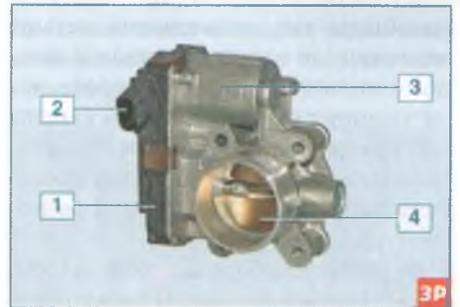
Дроссельный узел: 1 – блок управления дроссельной заслонкой; 2 – электрический разъем; 3 – корпус; 4 – дроссельная заслонка
