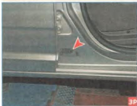
В нижней части стойки двери переднего пассажира наклеена табличка производителя, в которой содержится информация об автомобиле.
