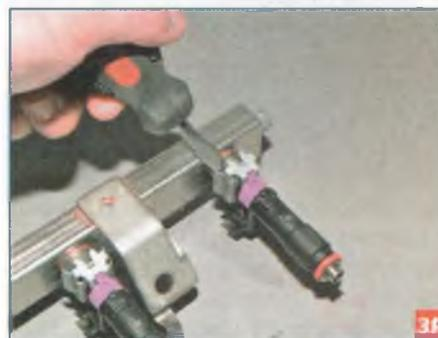
...с двух сторон шлицевой отверткой отжимаем ушки запорной скобы...
