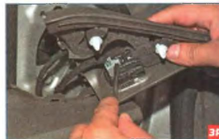
Отверткой нажимаем на фиксатор...
