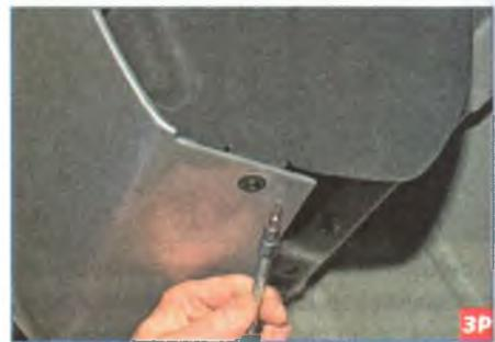
...и один саморез снизу автомобиля.
