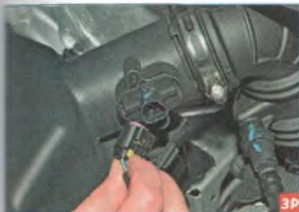
...и, нажав на фиксатор, отсоединяем колодку жгута проводов от разъема датчика.
