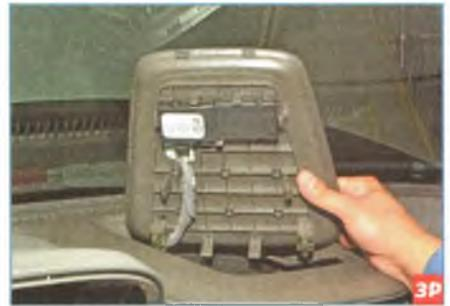
Снимаем верхнюю накладку панели приборов и отсоединяем колодку жгута проводов от блока управления центральным замком (см. «Снятие блоков управления системами автомобиля», с. 229).
