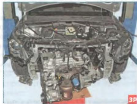
Придерживая силовой агрегат от падения, выкатываем его на тележке из моторного отсека.
