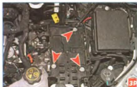
Головкой «на 13» отворачиваем три болта крепления площадки аккумуляторной батареи...
