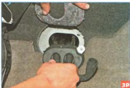
...и снимаем уплотнитель со шпилек щитка передка.
