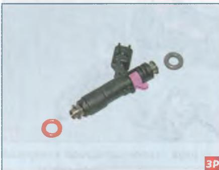
...снимаем уплотнительные кольца форсунки.
