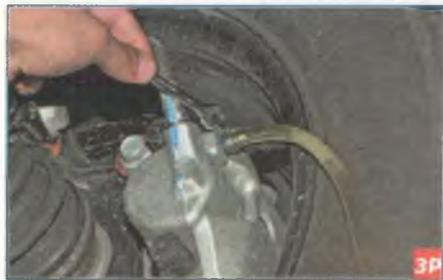
...тормозной механизм левого переднего колеса, отворачивая штуцер прокачки ключом «на 7».
