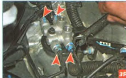
Специальным ключом «на 13» для штуцеров тормозных трубок отворачиваем штуцеры четырех тормозных трубок...
