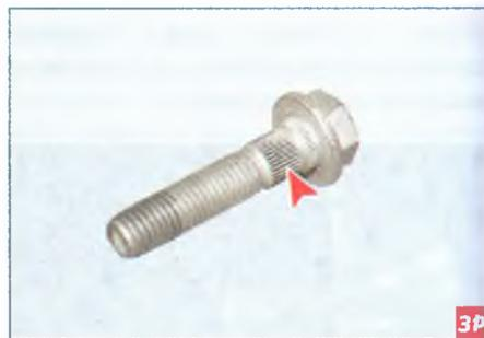
Болты в отверстиях сидят плотно за счет накатки.
