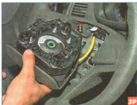
Снимаем подушку безопасности водителя (см. «Снятие подушки безопасности водителя», с. 228).
