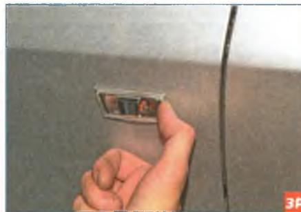
Сдвинув указатель вперед по ходу автомобиля...
