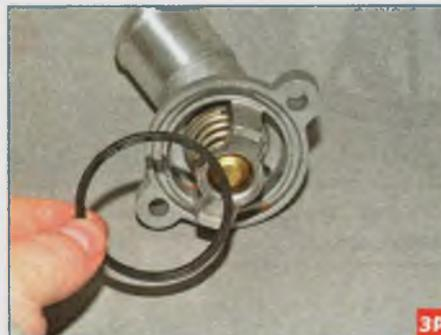
Вынимаем резиновую прокладку из проточки корпуса термостата.
