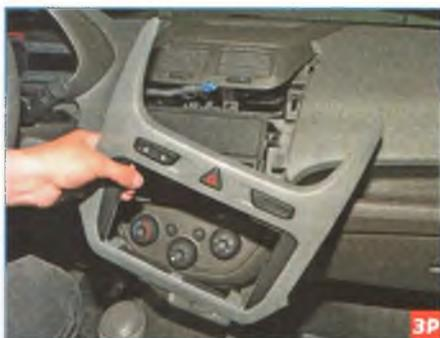
Снимаем центральную накладку панели приборов с выключателями (см. «Снятие выключателей и регуляторов», с. 222).
