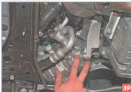
...отводим его от двигателя и оставляем подвешенным на шлангах.
