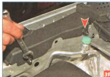
Ключом «на 10» отворачиваем две гайки...
