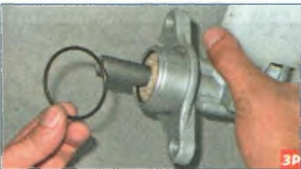
Если кольцо повреждено или потеряло эластичность, вынимаем его из проточки корпуса цилиндра и заменяем новым.
