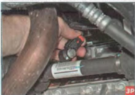
Выдвигаем стопор (красного цвета) фиксатора колодки жгута проводов
