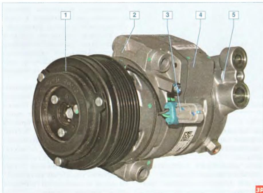
**Компрессор кондиционера с электромагнитной муфтой:** 1 – шкив с электромагнитной муфтой; 2 – передняя крышка; 3 – колодка проводов электромагнитной муфты; 4 – корпус; 5 – задняя крышка
