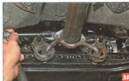
Головкой «на 13» отворачиваем две гайки крепления фланца трубы дополнительного глушителя к фланцу промежуточной трубы...
