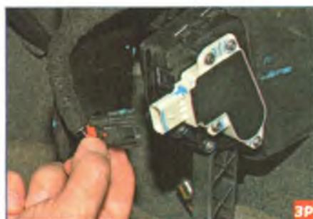
Отсоединяем колодку жгута проводов от модуля педали «газа» (см. «Снятие модуля педали «газа», с. 82).
