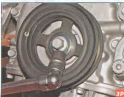
Головкой «на 17» отворачиваем болт крепления шкива привода вспомогательных агрегатов.
