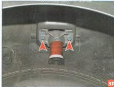
Проверяем и при необходимости подтягиваем болты верхнего крепления заднего амортизатора.
