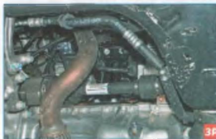
Доступ к датчику детонации затрудняет кронштейн впускного трубопровода.
