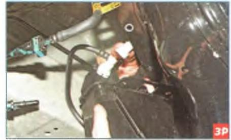
Нажав на фиксатор наконечника трубки подвода паров топлива к адсорберу, снимаем наконечник со среднего штуцера адсорбера.
