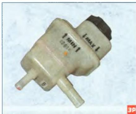
**Бачок гидроусилителя рулевого управления.**
