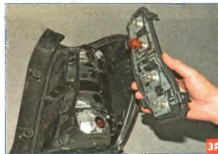
...снимаем держатель с лампами.
