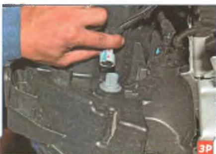
...и, нажав на фиксатор колодки проводов, отсоединяем колодку от патрона лампы дневного ходового огня и габаритного света.
