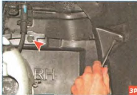
Поддеваем фиксатор пластмассового пистона, соединяющего подкрылок со щитком, и фиксатор пистона крепления щитка к правому лонжерону кузова...
