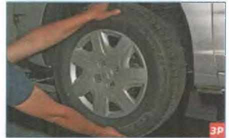
Взявшись за колесо, качаем его в вертикальной плоскости (несколько раз поочередно резко тянем верхнюю часть колеса на себя, а нижнюю – от себя, и наоборот).
