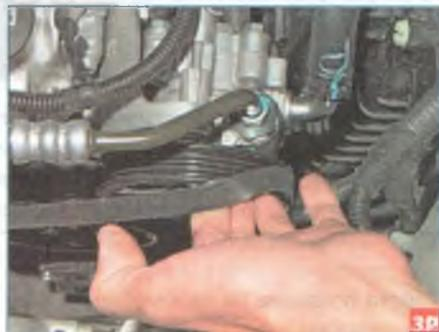
...надеваем ремень на шкив насоса гидроусилителя.
