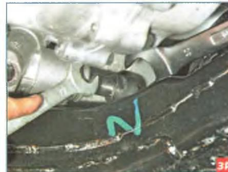
Удерживая рожковым ключом «на 20» рейку рулевого механизма в том месте, где зубья только начинаются, ключом «на 30» выворачиваем резьбовой
