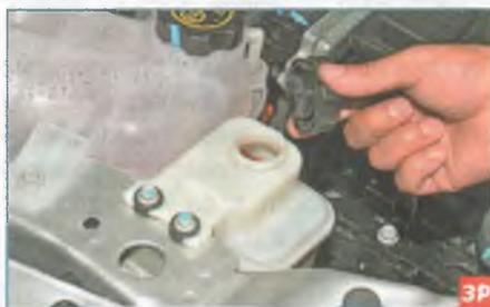
...отворачиваем и снимаем крышку бачка.
