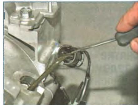
Отверткой отжимаем от трубки два фиксирующих лепестка втулки...
