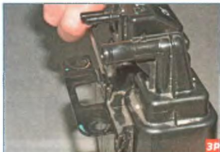
Отжав шлицевой отверткой фиксатор на корпусе адсорбера, сдвигаем кронштейн вниз по направляющим адсорбера...
