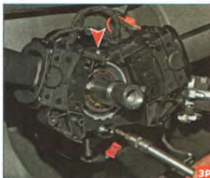
Ключом Torx T-20 отворачиваем два винта крепления соединителя.
