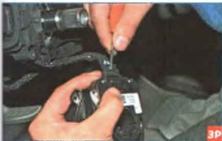
Отжав отверткой край разъема датчика угла поворота рулевого колеса, выводим из зацепления фиксатор колодки проводов...
