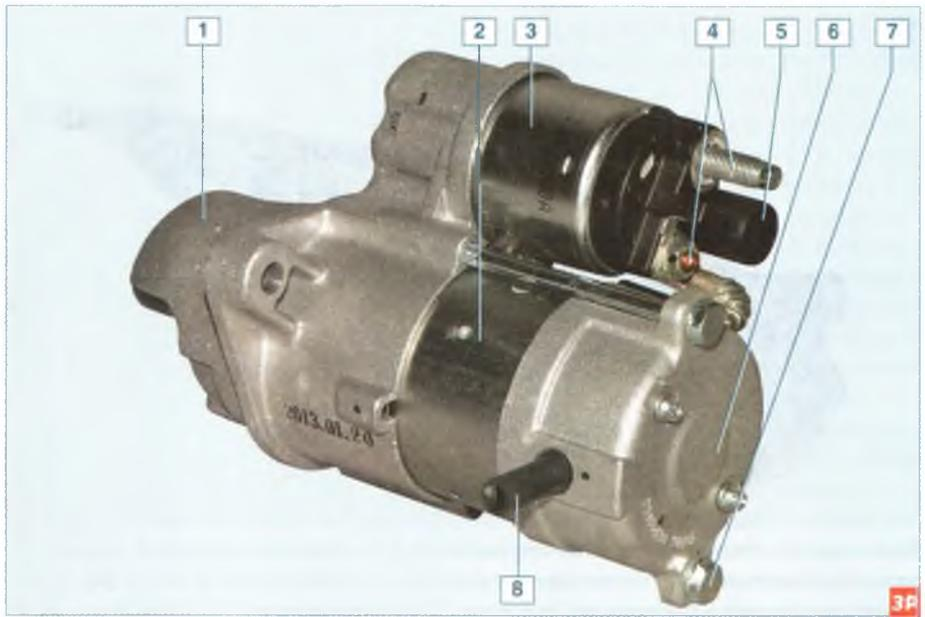
**Стартер:** 1 – передняя крышка; 2 – корпус стартера; 3 – тяговое реле; 4 – контактные болты; 5 – управляющий вывод тягового реле; 6 – задняя крышка; 7 – стяжной болт; 8 – дренажная трубка
