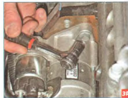
...и верхний болт крепления стартера (впускной трубопровод снят для наглядности).
