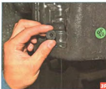
Вынимаем уплотнительную втулку насоса из отверстия бачка.
