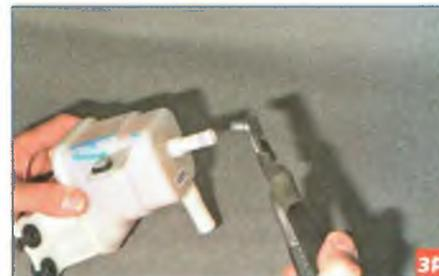
Пассатижами вынимаем обратный клапан из отверстия патрубка сливной магистрали.
