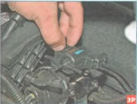
Сжав два фиксатора на кронштейне пневмокамеры механизма...
