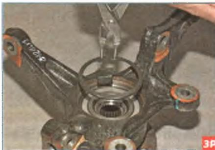
...вынимаем стопорное кольцо из проточки поворотного кулака.
