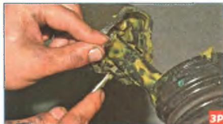
Отверткой поддеваем профилированное стопорное кольцо...
