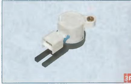
**Выключатель сигналов торможения.** Устанавливаем выключатель сигналов торможения в обратной последовательности.
