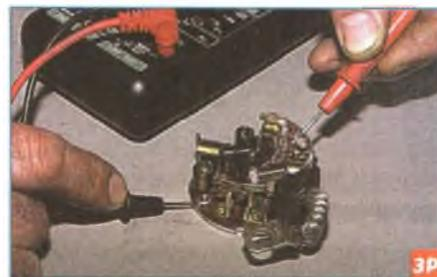
Омметром проверяем держатели изолированных щеток на замыкание с «массой».
