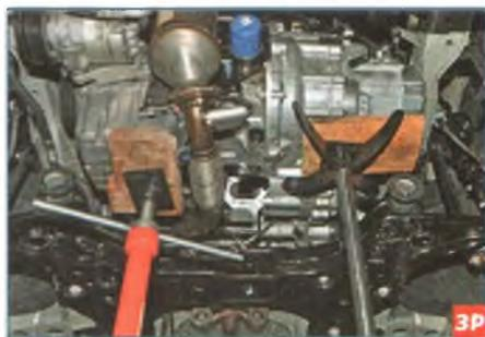
Подставляем регулируемые упоры под поддон картера двигателя и под картер коробки передач, подложив предварительно отрезки досок.
