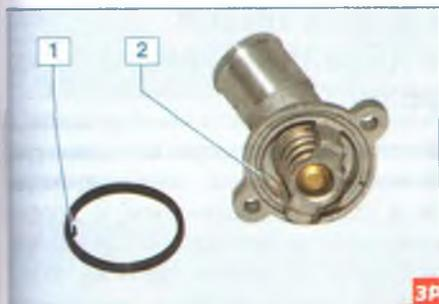
При установке прокладки ее выступ 1 должен войти в соответствующий паз 2 корпуса термостата.
