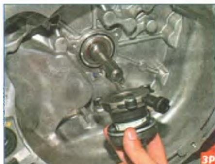
Снимаем рабочий цилиндр с подшипником в сборе.
