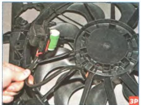
Выводим жгут проводов электродвигателя и дополнительного резистора из держателей на кожухе.
