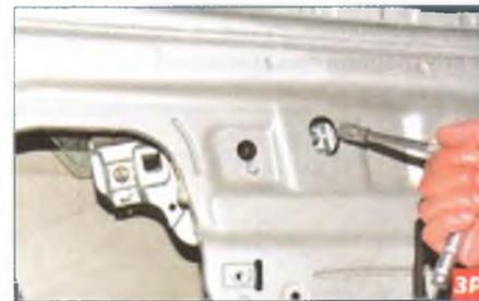
Головкой «на 10» ослабляем затяжку гаек крепления двух держателей стекла к ползуну стеклоподъемника, отворачив их на несколько оборотов.
