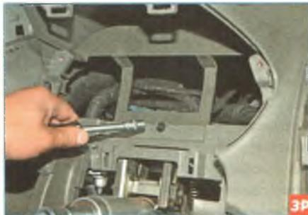
В том месте, где была установлена комбинация приборов, головкой «на 7» отворачиваем один саморез.
