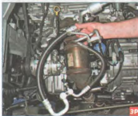
Снимаем со шпильки лонжерона соединитель трубок и вынимаем трубки из моторного отсека.
