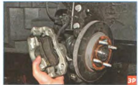
...и снимаем с диска тормозного механизма суппорт (не отсоединяя от него шланг) в сборе с направляющей колодок и тормозными колодками.
