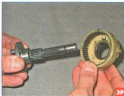
Снимаем коронную шестерню планетарного редуктора.
