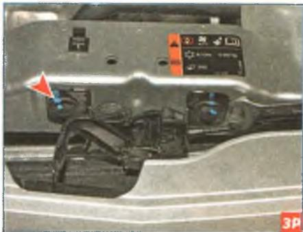
Ключом «на 13» отворачиваем два болта крепления замка капота к верхней поперечине рамки радиатора...
