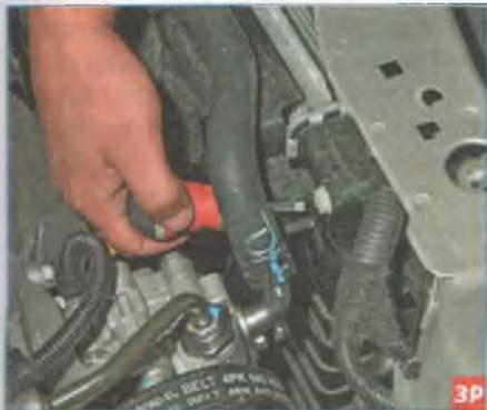
Отверткой отворачиваем пробку.
