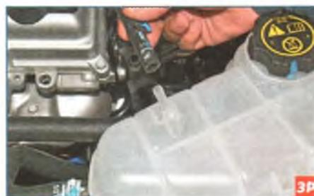
...снимаем шланг с верхнего патрубка бачка.
