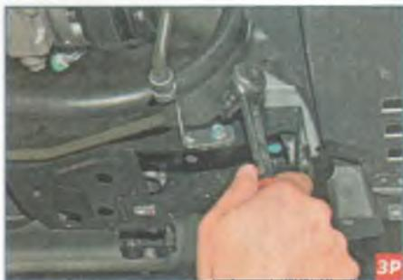
Тем же инструментом отворачиваем с правой задней стороны поперечины еще один болт крепления этой трубки...
