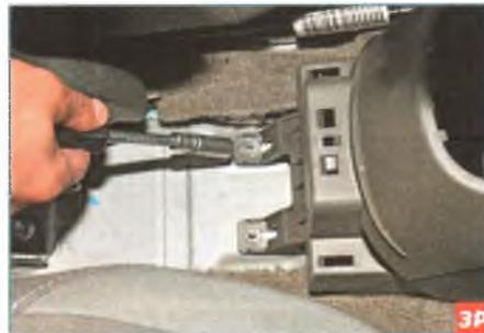
Высокой головкой «на 10» отворачиваем две гайки крепления передней части облицовки туннеля пола.
