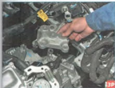
...и ее кронштейн (см. «Замена опор силового агрегата», с. 61).
