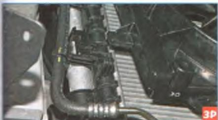
...сдвигаем кожух вверх, выводя его лапки из нижних и верхних держателей на бачках радиатора.
