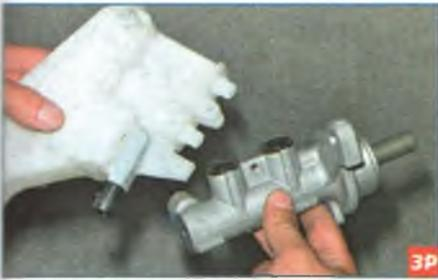
Преодолевая сопротивление резиновых втулок, разъединяем бачок с главным тормозным цилиндром.
