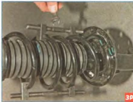
Равномерно вращая винты стяжек, сжимаем пружину до тех пор, пока ее нижний и верхний витки не перестанут давить на опоры.
