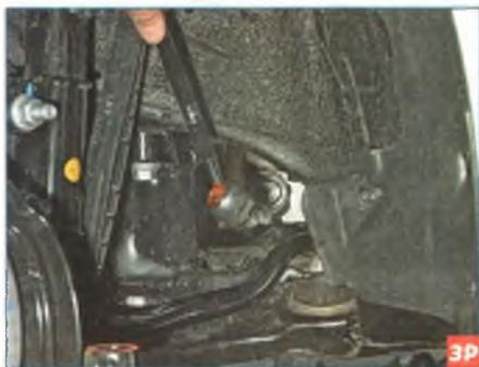
Снимаем рулевую тягу.
