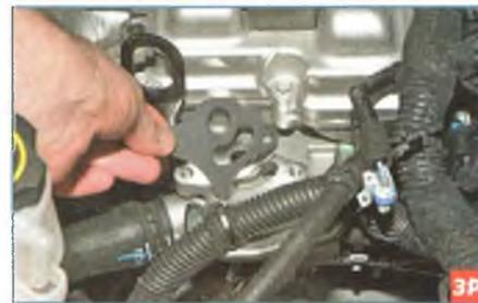
...и его уплотнительную прокладку. Перед установкой клапана очищаем от нагара и загрязнений привалочные поверхности...
