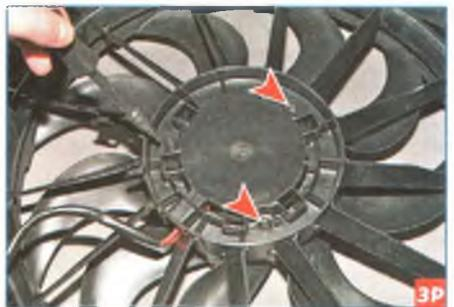
Ключом Torx T-25 отворачиваем три винта крепления электродвигателя вентилятора к кожуху...
