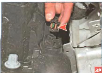
Нажав на пружинный фиксатор колодки проводов (показан стрелкой), отсоединяем колодку от патрона лампы указателя поворота.
