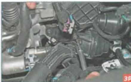
Ключом Torx T-20 отворачиваем два самореза крепления к впускному трубопроводу упорной пластины кулисы механизма...
