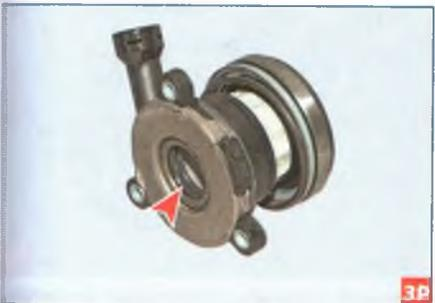
С первичным валом подшипниковый узел уплотняется сальником, который можно заменить только в сборе с узлом. Устанавливаем снятые детали в обратной последовательности. Уплотнительные кольца наконечников трубки подвода жидкости к рабочему цилиндру заменяем новыми. Прокачиваем гидропривод сцепления (см. «Прокачка гидропривода сцепления», с. 124).
