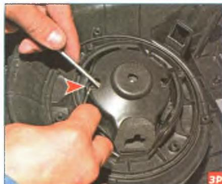
Отжав отверткой фиксатор (показан стрелкой) на корпусе отопителя, второй отверткой нажимаем на вентилятор, выводя его из зацепления с фиксатором.
