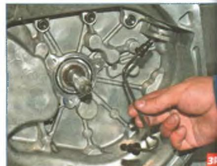
Снимаем трубку подвода жидкости к рабочему цилиндру.
