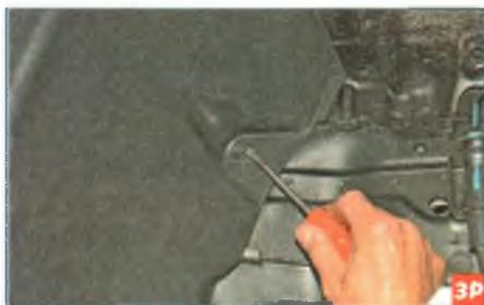
Шлицевой отверткой поддеваем фиксатор пистона, крепящий левый щиток моторного отсека и переднюю часть подкрылка к лонжерону кузова...
