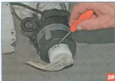
Шлицевой отверткой освобождаем три фиксатора...
