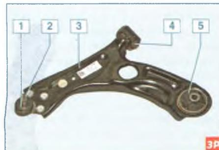
Рычаг передней подвески с шаровой опорой: 1 – чехол шаровой опоры; 2 – палец шаровой опоры; 3 – рычаг; 4 – сайлент-блок переднего крепления рычага к подрамнику; 5 – сайлент-блок заднего крепления рычага к подрамнику
