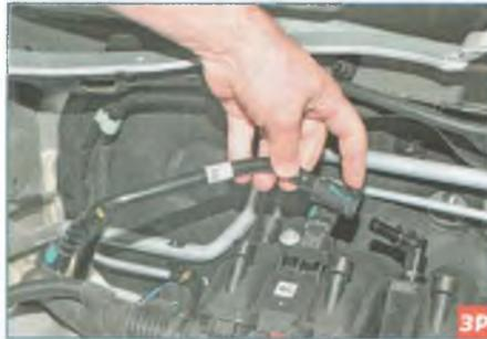
Нажав на фиксатор наконечника трубки системы вентиляции картера, отсоединяем наконечник от штуцера впускного трубопровода и снимаем трубку.
