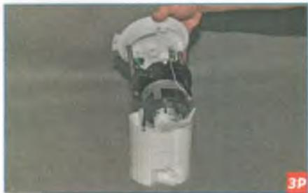
...и вынимаем из корпуса модуля узел – фильтр тонкой очистки топлива в сборе с насосом, сетчатым фильтром и крышкой модуля.
