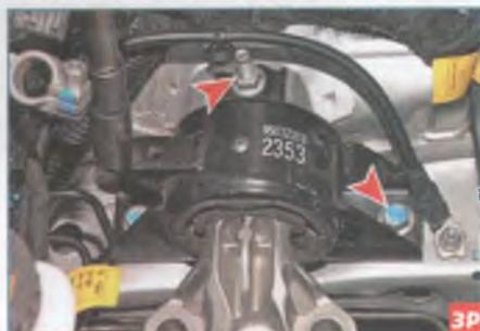
Высокой головкой «на 15» отворачиваем два болта и гайку крепления левой опоры.
