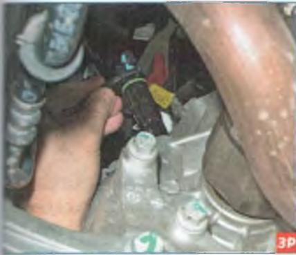
...и вынимаем датчик из отверстия в картере сцепления.
