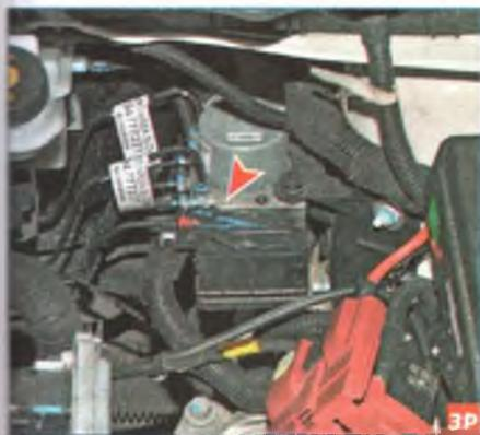
Расположение блока ABS на автомобиле.
