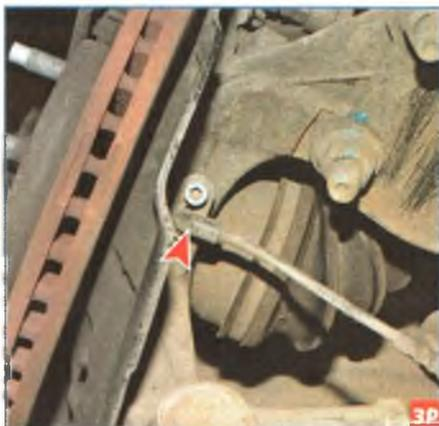
...на поворотном кулаке установлен датчик скорости вращения колеса...
