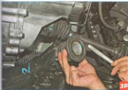
...вынимаем болт и снимаем антивибрационный груз.
