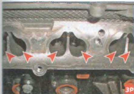
Впускные каналы головки блока цилиндров
