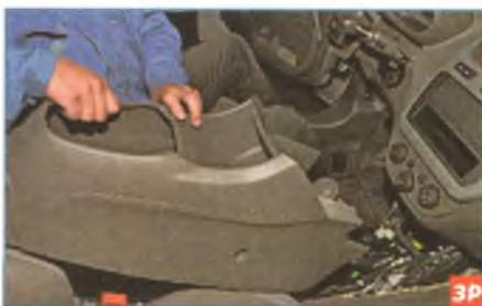
Снимаем облицовку туннеля пола (см. «Снятие облицовки туннеля пола», с. 250).
