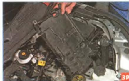
...и снимаем ее. Устанавливаем площадку аккумуляторной батареи в обратной последовательности.
