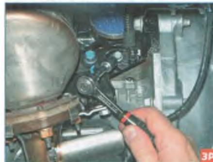
Головкой «на 10» отворачиваем болт крепления датчика...
