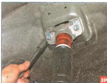
Головкой «на 15» с удлинителем отворачиваем два болта верхнего крепления амортизатора к кузову.
