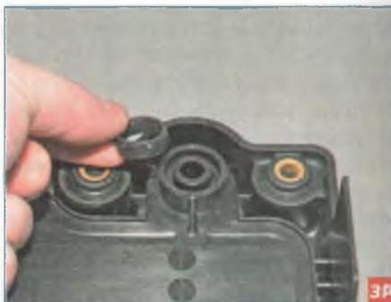
Вынимаем из крышки резиновый уплотнитель маслоотделителя.
