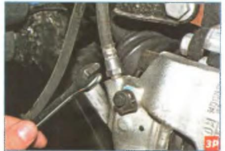
Ключом «на 14» выворачиваем нижний наконечник шланга из резьбового отверстия в суппорте...
