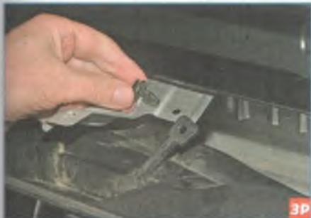
Вынимаем пистон крепления кронштейна облицовки щитка передка к кронштейну кузова.
