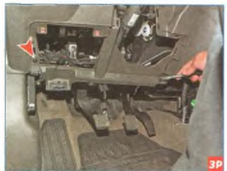
Снизу, с левой стороны панели приборов отворачиваем два самореза.
