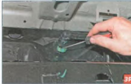
Шлицевой отверткой выдвигаем фиксатор наконечника вентиляционной трубки...
