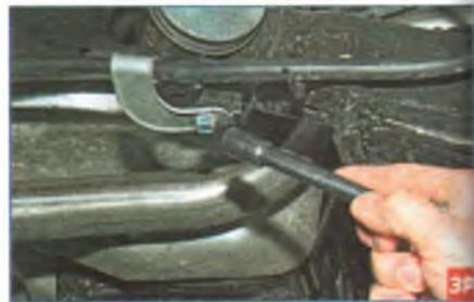
Головкой «на 13» отворачиваем болт крепления держателя троса к рычагу балки задней подвески.
