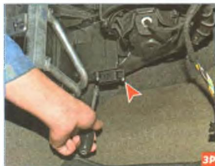
Головкой «на 5,5» отворачиваем два самореза...
