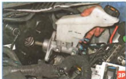
Снимаем главный тормозной цилиндр в сборе с бачком гидроприводов тормозов и сцепления (см. «Снятие главного тормозного цилиндра и бачка гидроприводов тормозов и сцепления», с. 183).
