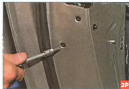
Ключом Torx T-30 отворачиваем винт крепления направляющей к торцу двери...
