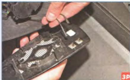
Отсоединяем два наконечника проводов от контактов обогрева...
