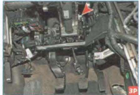
Расположение выключателя сигналов торможения.
