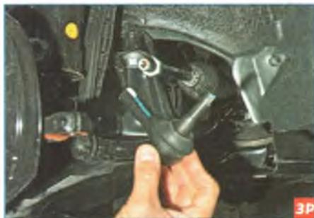
Снимаем наконечник рулевой тяги (см. «Замена наконечника рулевой тяги», с. 166).
