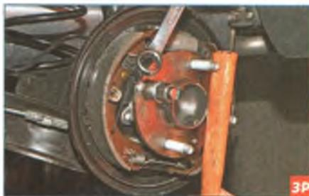
Ключом «на 19» затягиваем гайку, тем самым запрессовывая шпильку в ступицу. Ступицу от проворачивания удерживаем рукояткой молотка, упревая ее между двумя шпильками.
