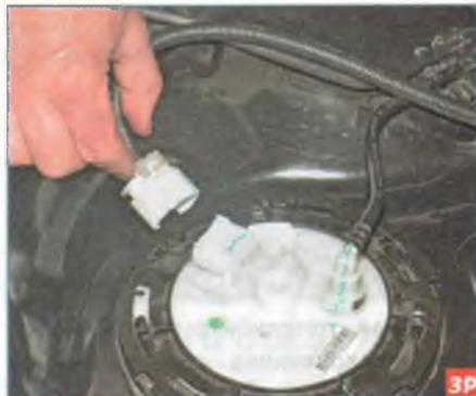
...и, нажав на фиксатор, отсоединяем колодку от разъема крышки топливного модуля.
