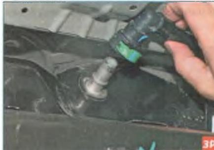
...и снимаем наконечник трубки с патрубка топливного бака.
