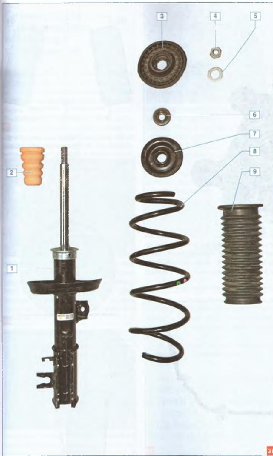
Детали амортизаторной стойки: 1 – амортизаторная стойка; 2 – буфер хода сжатия; 3 – верхняя опора стойки; 4 – гайка; 5 – шайба; 6 – подшипник; 7 – чашка верхней опоры; 8 – пружина; 9 – грязезащитный чехол
