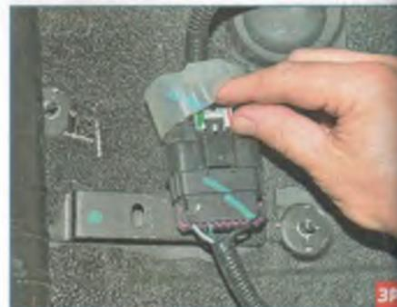
Выдвигаем стопорный элемент фиксатора колодки жгута проводов кузова...
