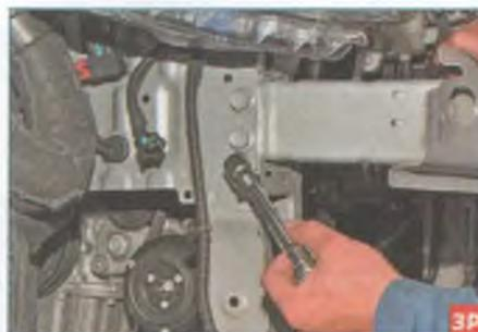
Головкой «на 19» отворачиваем два болта крепления поперечной балки кузова к правому лонжерону с одной его стороны...
