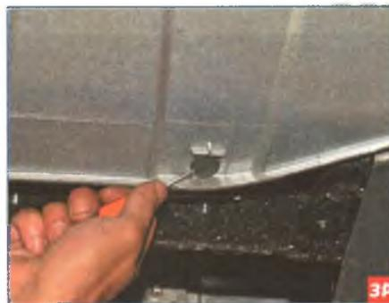
Поддеваем фиксаторы трех пластмассовых пистонов крепления бампера к нижней поперечине рамки радиатора...
