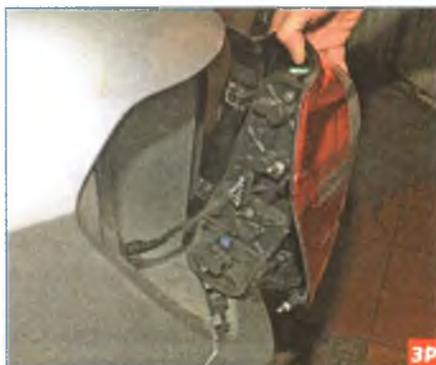
Отводим фонарь от кузова автомобиля.
