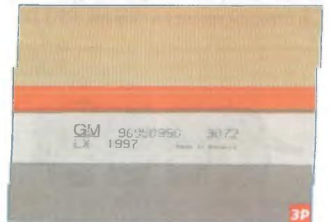
Маркировка сменного элемента воздушного фильтра.
