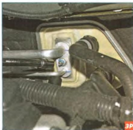
Головкой «на 13» отворачиваем гайку...
