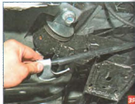
Выводим трос из прорези кронштейна рычага балки.
