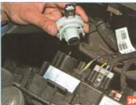
Аналогично снимаем привод заслонки регулятора температуры.
