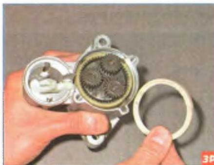
Вынимаем уплотнительную прокладку привода.
