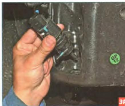
...и снимаем насос.
