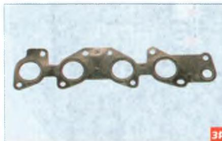
Уплотнительная прокладка в соединении выпускного коллектора с головкой блока цилиндров
