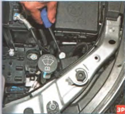
Поворачивая крестообразной отверткой регулятор, расположенный ближе к середине моторного отсека, изменяем положение светового пучка в вертикальной плоскости.
