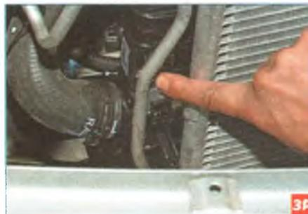
На правом бачке радиатора нажимаем на фиксатор нижнего держателя конденсатора...
