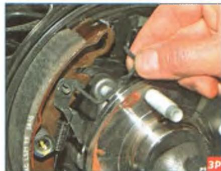
Снимаем серьгу механизма автоматической регулировки зазора между колодками и барабаном.
