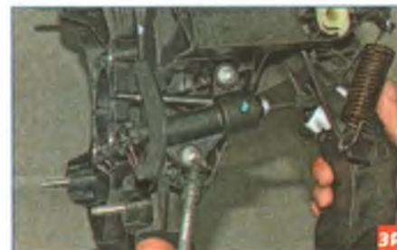
Ключом Torx T-30 отворачиваем два самореза крепления главного цилиндра к педальному узлу...
