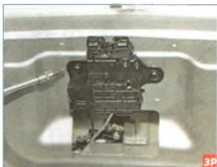
Ключом Torx T-30 отворачиваем два винта крепления замка к внутренней панели крышки багажника...
