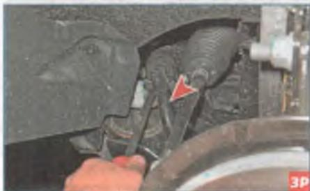
**Монтажной лопаткой пытаемся сдвинуть штангу стабилизатора относительно подрамника.**
