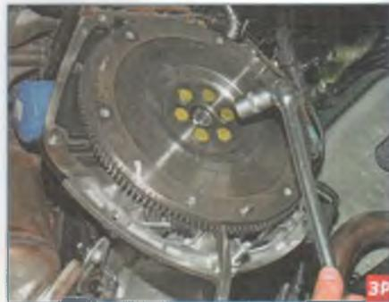
Головкой «на 17» отворачиваем шесть болтов крепления маховика к фланцу коленчатого вала, удерживая вал от проворачивания монтажной лопаткой, вставленной между зубьями маховика и опирающейся на болт, установленный в отверстие блока цилиндров и закрепленный гайкой (при отворачивании последнего болта придерживаем маховик от падения).
