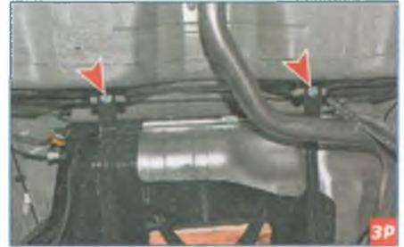
Головкой «на 13» с удлинителем отворачиваем два болта переднего крепления хомутов топливного бака.
