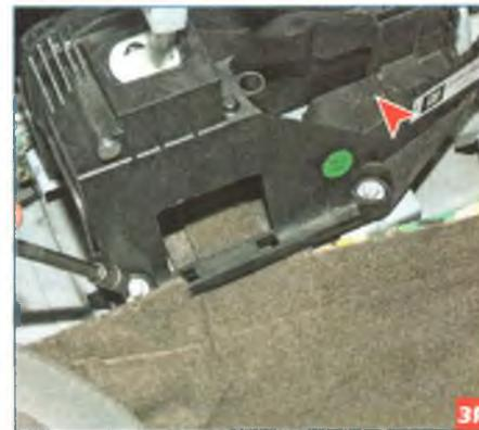
Головкой «на 10» с удлинителем отворачиваем четыре болта крепления
