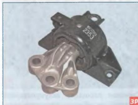
Левая опора силового агрегата.
