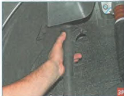
Выводим верхний конец наливной трубы из-под подкрылка колеса...
