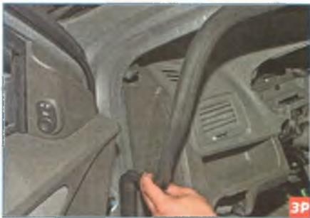
Снимаем уплотнитель двери водителя с отбортовки кузова в зоне передней стойки и панели приборов.
