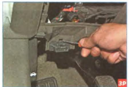
Отверткой нажимаем на фиксатор колодки диагностического разъема...
