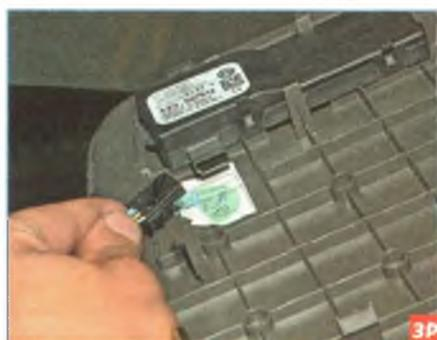
...и отсоединяем колодку от разъема блока.
