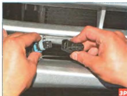
Отжав фиксатор колодки проводов, отсоединяем колодку от разъема датчика.
