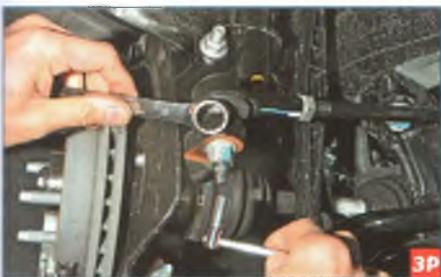
Накидным ключом «на 18» отворачиваем гайку крепления пальца шарнира наконечника к рычагу поворотного кулака, удерживая палец от проворачивания головкой «на 8».
