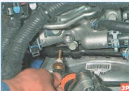
...и вынимаем датчик температуры охлаждающей жидкости.
