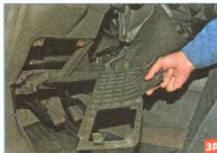
Снимаем нижнюю накладку панели приборов (см. «Снятие панели приборов», с. 251).
