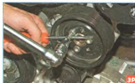
Ключом Torx T-45 поочередно ослабляем затяжку трех винтов крепления шкива насоса охлаждающей жидкости, удерживая шкив от вращения отверткой, вставленной враспор между головкой винта и ключом. Полностью отвернув винты...
