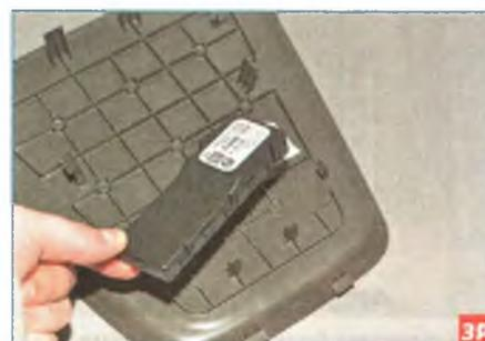
...и снимаем блок управления.
