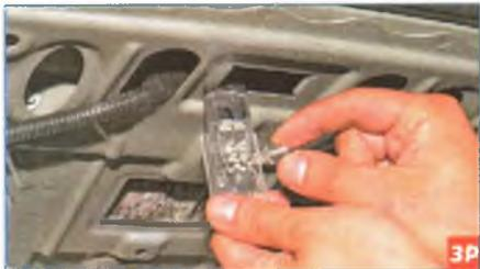
Вынимаем лампу из плафона. Устанавливаем новую лампу W8W в обратной последовательности.
