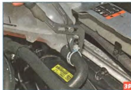
Раздвижными пассатижами сжимаем концы хомута крепления наливного шланга и, сдвинув хомут по шлангу...
