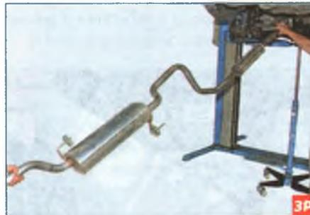
Снимаем основной глушитель с дополнительным глушителем и соединяющими их трубами.
