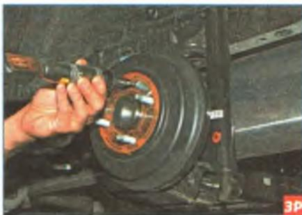
С помощью ударной отвертки со вставленным ключом Torx T-30 отворачиваем винт крепления барабана...
