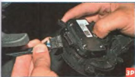
...и отсоединяем колодку от датчика угла поворота рулевого колеса.
