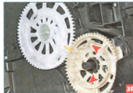
...в соответствующие выемки зубчатого колеса.
