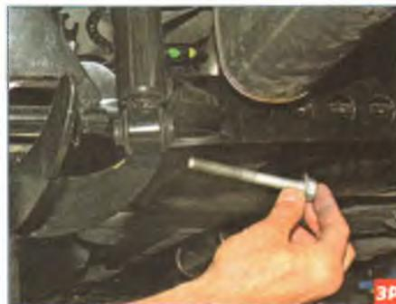
Отсоединяем нижние крепления амортизаторов от рычагов балки (см. «Снятие амортизатора», с. 157)...
