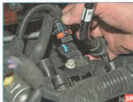
Нажав на фиксатор колодки жгута проводов системы управления двигателем, отсоединяем колодку от разъема датчика.
