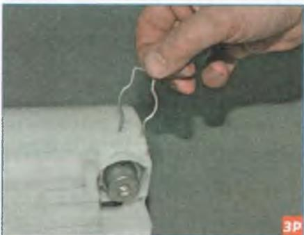
...вынимаем запорную скобу регулятора давления топлива.
