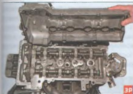
...и снимаем крышку.
