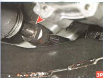
Стопорная шайба корпуса шарнира рулевой тяги
