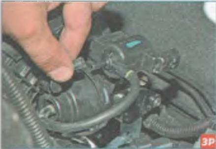
Отсоединяем от центрального штуцера клапана шланг, соединяющий клапан с впускным трубопроводом.
