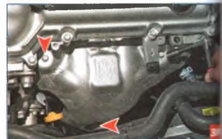
Головкой «на 10» отворачиваем болта крепления теплозащитного экрана к выпускному коллектору...
