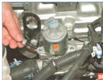
При отворачивании гаек могут вывернуться шпильки из резьбовых отверстий выпускного патрубка.
