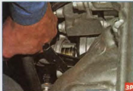
Отводим термостат на шланге радиатора от передней крышки блока цилиндров.
