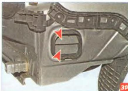
Клапаны для выпуска воздуха из салона автомобиля (задний бампер снят)
