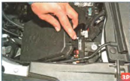
...нажав на защелку, приподнимаем крышку монтажного блока...
