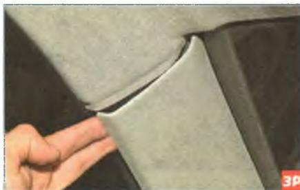
Преодолевая сопротивление фиксаторов, отжимаем обивку левой передней стойки.
