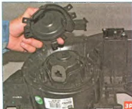
...и снимаем крышку вентилятора.
