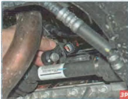
...отсоединяем колодку жгута проводов от разъема датчика детонации.
