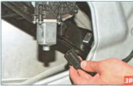
...отсоединяем колодку жгута проводов от мотор-редуктора стеклоподъемника, нажав на фиксатор колодки.
