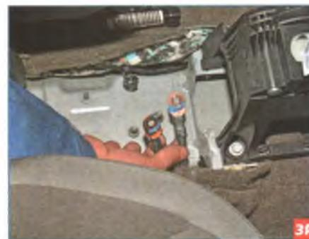
...и снимаем наконечники двух «массовых» проводов со шпилек на туннеле пола.
