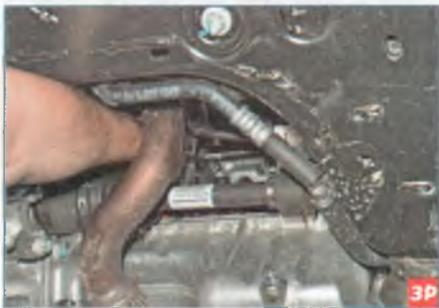
Накидным ключом «на 13» отворачиваем болт крепления датчика к блоку цилиндров...
