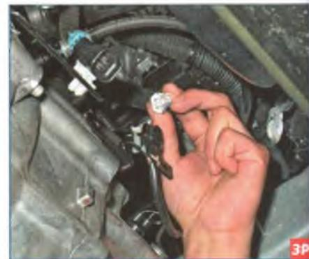
Нажав на фиксатор колодки проводов, отсоединяем колодку проводов выключателя от колодки жгута проводов. Включив зажигание, отрезком провода замыкаем контакты колодки жгута проводов. Если при этом лампы света заднего хода не загорелись, следует проверить электрическую цепь. Если лампы загорелись, значит, выключатель неисправен и его нужно заменить.
