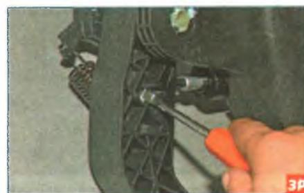
Отверткой поджимаем с обеих сторон педали сцепления лапки пластмассового фиксатора толкателя главного цилиндра...
