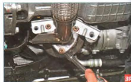
Тем же инструментом отворачиваем три гайки, крепящих одновременно кронштейн и фланец промежуточной трубы к фланцу каталитического нейтрализатора.
