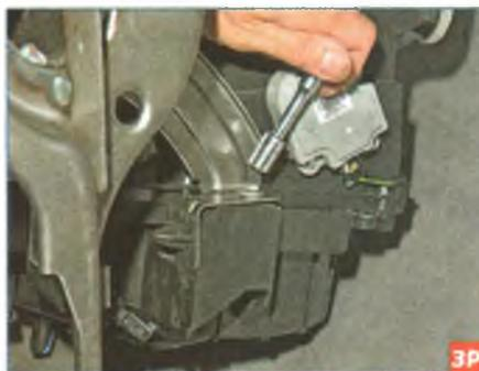
...и болт правого крепления отопителя к каркасу панели приборов.
