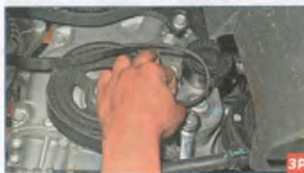
Снимаем ремень с ролика натяжного устройства и со шкивов.
