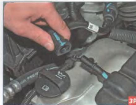
...отсоединяем наконечник трубки от штуцера крышки катушек зажигания.
