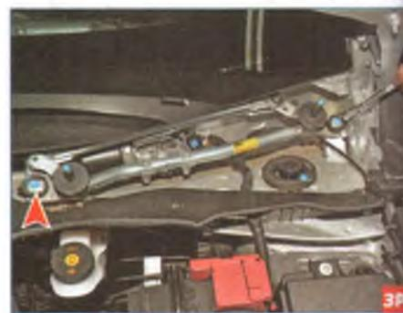
Головкой «на 10» отворачиваем два болта крепления очистителя.
