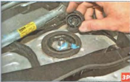
Снимаем защитную пластмассовую крышку с гайки крепления стойки.
