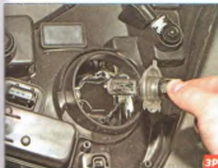
...и вынимаем лампу из корпуса блок-фары.
