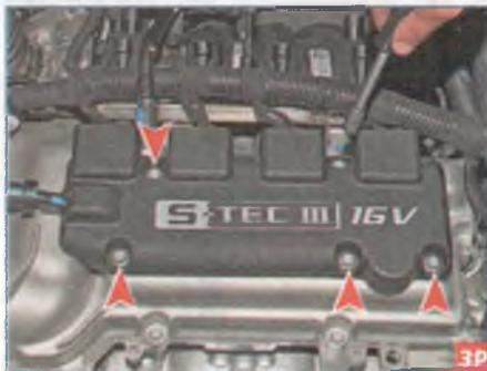
Головкой «на 10» отворачиваем пять болтов крепления крышки катушек зажигания.
