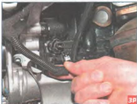
...и, нажав на фиксатор колодки провода, отсоединяем колодку от разъема датчика сигнализатора недостаточного давления масла.
