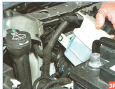
...и выведя палец бачка из отверстия кронштейна на верхней поперечине рамки радиатора, снимаем бачок.
