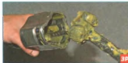
Снимаем корпус шарнира с трехшариковика.
