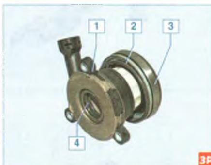
Рабочий цилиндр с подшипником выключения сцепления: 1 – рабочий цилиндр; 2 – прижимная пружина подшипника; 3 – подшипник выключения сцепления; 4 – сальник первичного вала коробки передач
