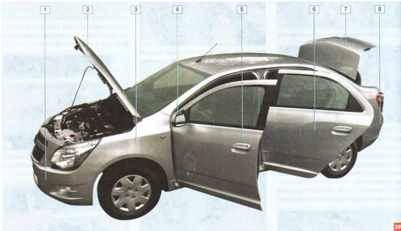
Съемные элементы автомобиля: 1 – передний бампер; 2 – капот; 3 – переднее крыло; 4 – наружное зеркало заднего вида; 5 – передняя дверь; 6 – задняя дверь; 7 – крышка багажника; 8 – задний бампер
