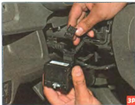
Нажав на фиксатор колодки проводов, отсоединяем колодку от переключателя...
