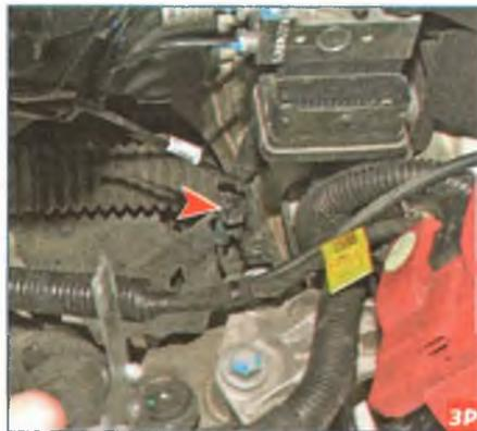
Крепление на левом лонжероне колодок жгута проводов моторного отсека и жгута проводов датчика скорости вращения колеса.
