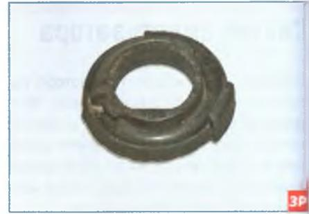
...и нижнюю прокладки пружины. Убеждаемся в отсутствии деформаций и разрывов на прокладках. Поврежденные прокладки заменяем новыми.
