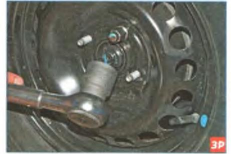
Головкой «на 36» и мощным воротком ослабляем затяжку гайки крепления подшипника ступицы колеса...
