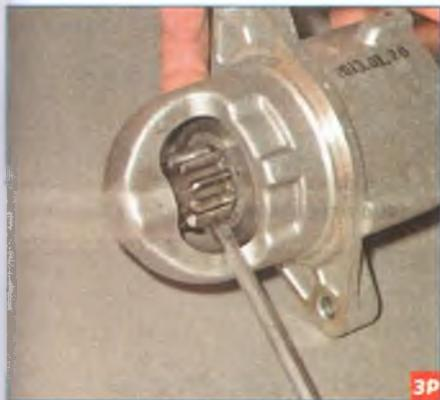
Отверткой сдвигаем шестерню привода по валу.
