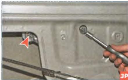
Головкой «на 10» ослабляем натяжку гаек крепления двух держателей стекла к ползуну стеклоподъемника, отвернув их на несколько оборотов.
