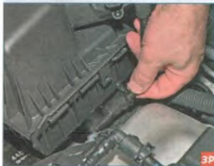
Выводим держатель жгута проводов из отверстия в крышке воздушного фильтра.
