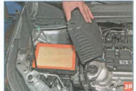
Приподнимаем крышку фильтра...
