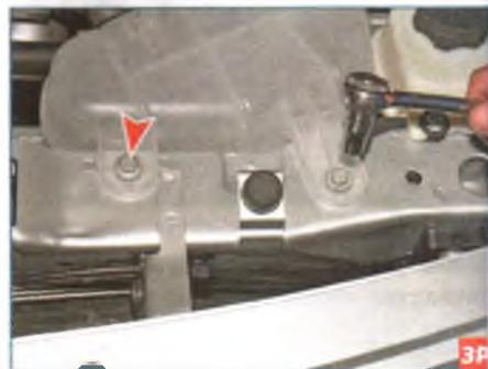
Головкой «на 10» отворачиваем два болта крепления бачка к верхней поперечине рамки радиатора.
