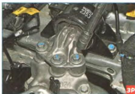
Головкой «на 15» отворачиваем три болта крепления кронштейна левой опоры силового агрегата к опоре.
