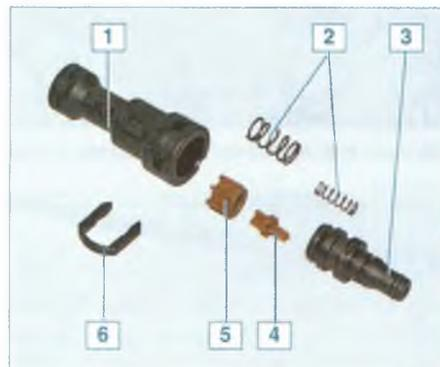
Дроссельный клапан: 1 – корпус; 2 – пружина клапана; 3 – наконечник трубки; 4 – клапан; 5 – седло клапана; 6 – фиксатор
