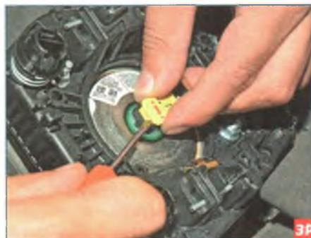
Поддев отверткой, выдвигаем фиксатор колодки проводов...
