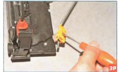
...вставляем тонкую шлицевую отвертку в паз флажка фиксатора (для наглядности показано на снятом замке)...
