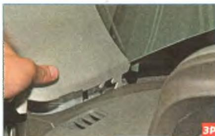
Выводим нижние фиксаторы из отверстий в панели приборов и отводим обивку от левой передней стойки. Аналогично снимаем обивку правой передней стойки. Открываем вещевой ящик.
