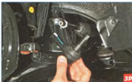
...отворачиваем и снимаем наконечник рулевой тяги.
