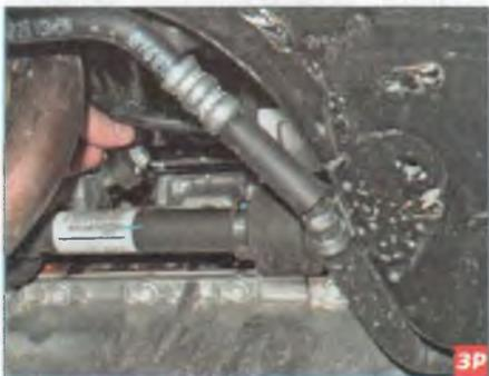
...и отводим датчик с болтом и жгутом проводов от блока цилиндров.
