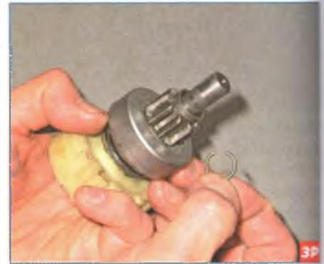
...снимаем запорное кольцо.
