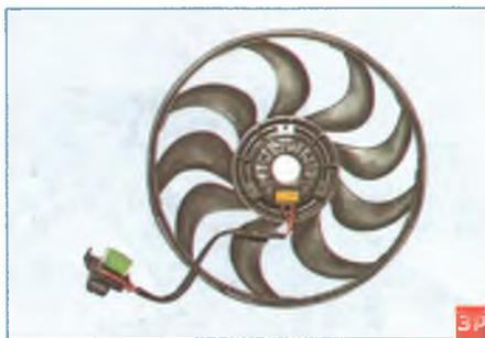
Электродвигатель с крыльчаткой вентилятора и дополнительным резистором представляют собой неразборное соединение.
