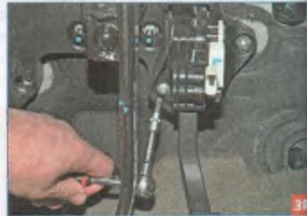
Ключом Torx T-30 отворачиваем саморез крепления модуля педали «газа» к кронштейну педального узла...
