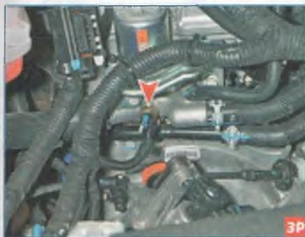
Датчик установлен в отверстии выпускного патрубка системы охлаждения, который прикреплен к левому торцу головки блока цилиндров.
