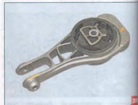
Задняя опора силового агрегата.
