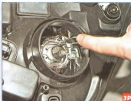
Нажав на конец пружинного фиксатора лампы, выводим его из зацепления с крючком отражателя...
