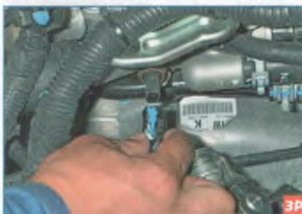
...отсоединяем колодку жгута проводов от разъема датчика.
