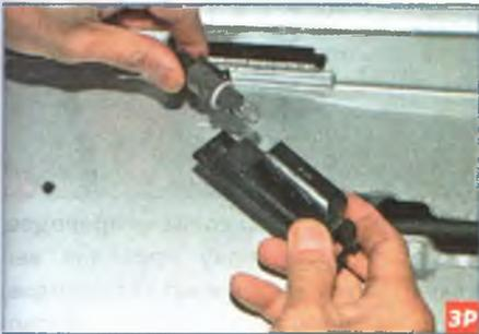
Повернув против часовой стрелки, вынимаем патрон с лампой из корпуса фонаря.
