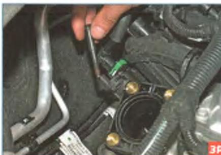
...и вынимаем болт из проушин клапана.
