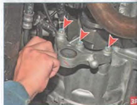
Головкой «на 18» отворачиваем три болта крепления кронштейна задней опоры к картеру сцепления.
