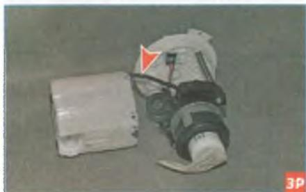
При этом штуцер предохранительного клапана топливного насоса остается связанным гофрированной пластмассовой трубкой с наконечником, закрепленным на днище корпуса модуля.
