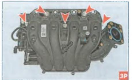
Расположение болтов крепления впускного трубопровода к головке блока цилиндров (для наглядности показано на снятом трубопроводе). Приподняв левую часть трубопровода...
