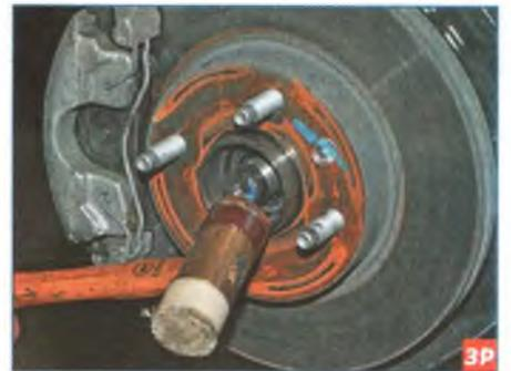
Молотком с пластмассовым бойком наносим удары по торцу хвостовика корпуса наружного шарнира привода колеса, выбивая его из ступицы колеса.
