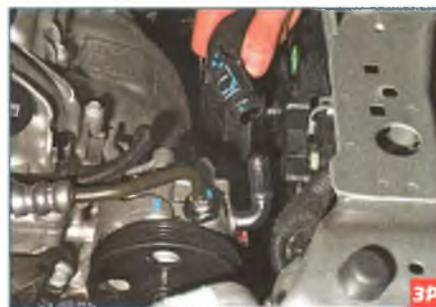
...снимаем шланг с патрубка насоса.
