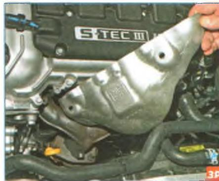
Снимаем теплозащитный экран (см. «Снятие выпускного коллектора», с. 120).
