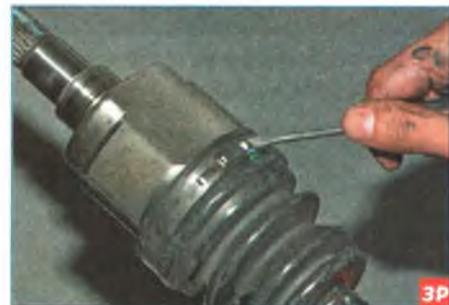
...отверткой поджимаем запорный усик хомута...
