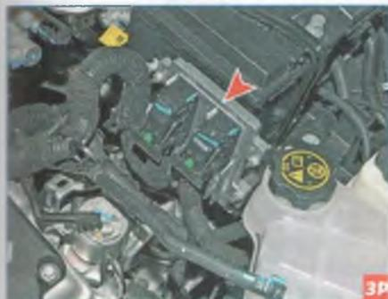
Расположение ЭБУ в моторном отсеке.
