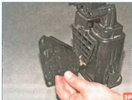
...и снимаем кронштейн. Устанавливаем адсорбер в обратной последовательности.
