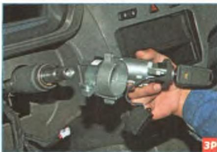
...и снимаем выключатель зажигания с рулевой колонки.
