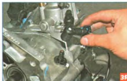
...и снимаем переходник с наконечника трубки.
