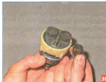
Снимаем три сателлита планетарного редуктора.
