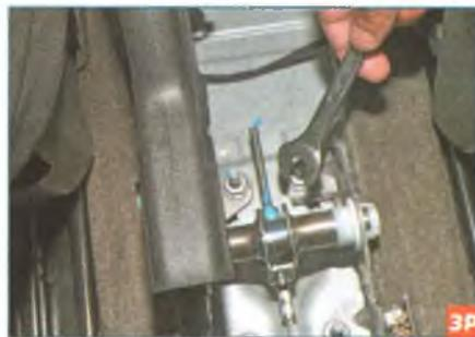
Ключом «на 13» вращаем регулировочную гайку на наконечнике переднего троса, регулируя натяжение тросов. Полный ход рычага стояночного тормоза должен составлять 6–8 зубцов (щелчков) храпового устройства сектора. При полностью опущенном рычаге стояночного тормоза вывешенные задние колеса автомобиля должны вращаться свободно, а при поднятом рычаге – должны быть заблокированы.
