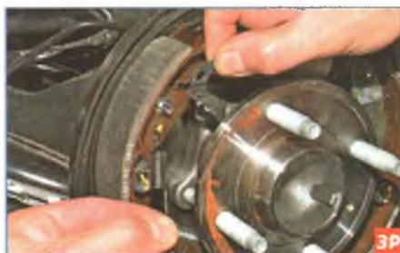
Снимаем рычаг и пружину механизма автоматической регулировки зазора между колодками и барабаном.
