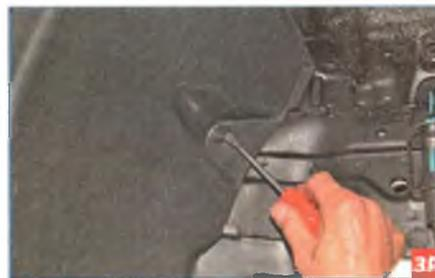
Шлицевой отверткой поддеваем фиксатор пистона, соединяющего между собой левый щиток моторного отсека и переднюю часть подкрылка в арке колеса...
