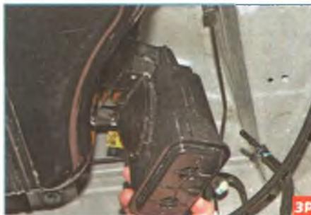
Отводим от бака адсорбер и опускаем его.
