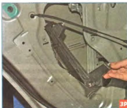
Извлекаем направляющую стекла через технологическое отверстие во внутренней панели двери (см. «Снятие стекла задней двери», с. 247).
