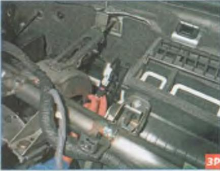
...отсоединяем колодку жгута проводов от разъема выключателя.
