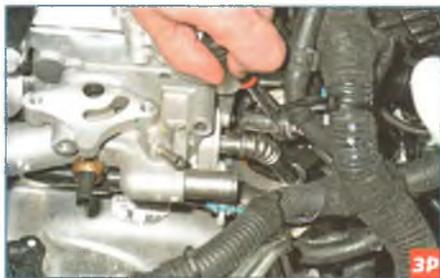
Головкой «на 10» отворачиваем две гайки крепления фланца трубки системы рециркуляции отработавших газов к фланцу выпускного патрубка.
