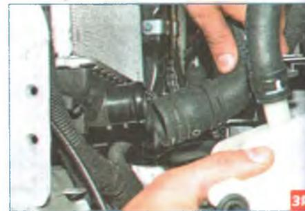
...снимаем шланг с патрубка левого бачка радиатора.
