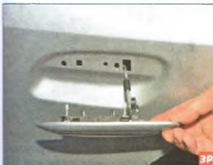
...и снимаем наружную ручку вместе с тягой, извлекая ее через отверстие в двери.
