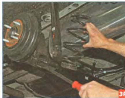
Вынимаем нижнюю часть пружины из опоры рычага балки и снимаем пружину с опорного кронштейна на кузове.
