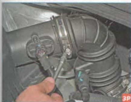
Головкой «на 8» ослабляем затяжку гомута крепления шланга подвода воздуха к дроссельному узлу...
