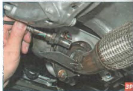
...и выворачиваем датчик из резьбового отверстия промежуточной трубы.
