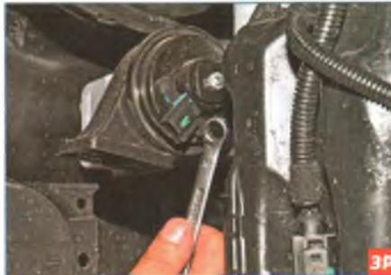
Ключом «на 10» отворачиваем гайку крепления звукового сигнала к кронштейну.
