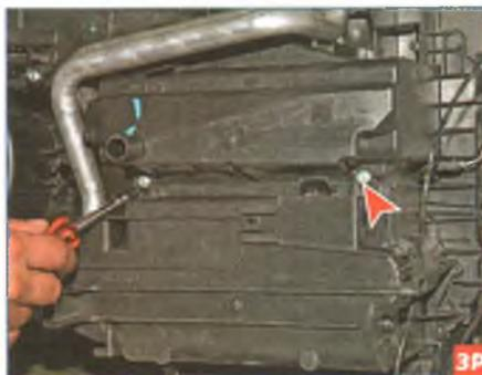
Головкой «на 5,5» отворачиваем два самореза снизу...
