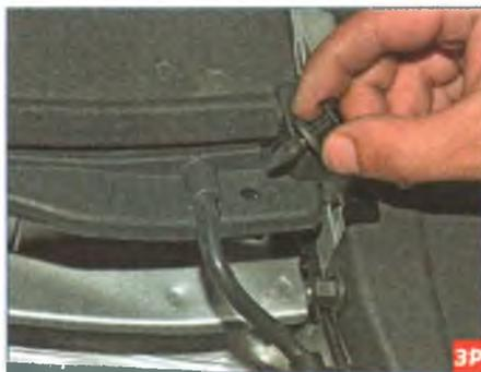
...и вынимаем пистон крепления облицовки ветрового окна.
