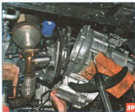
...и снимаем коробку передач.
