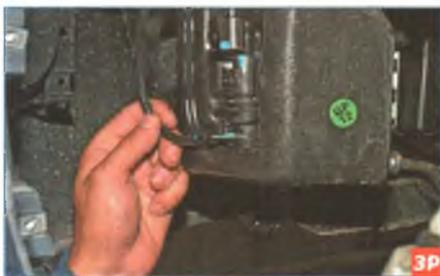
Отсоединяем шланг подачи жидкости на ветровое стекло от штуцера насоса...
