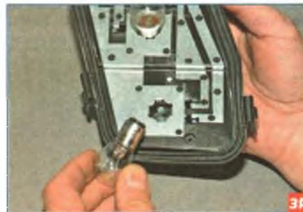
Нажав на лампу противотуманного и габаритного света, поворачиваем ее против часовой стрелки и вынимаем лампу из держателя.
