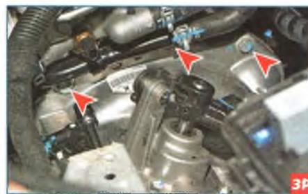
Головкой «на 15» отворачиваем три болта верхнего крепления коробки передач к блоку цилиндров двигателя.
