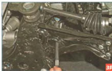
С левой стороны через отверстие в рычаге подвески головкой «на 21» с удлинителем отворачиваем передний болт крепления подрамника к лонжерону кузова.
