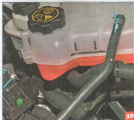
Уровень жидкости должен находиться около сварного шва бачка, на это указывают две стрелки на стенке бачка (метка MAX).
