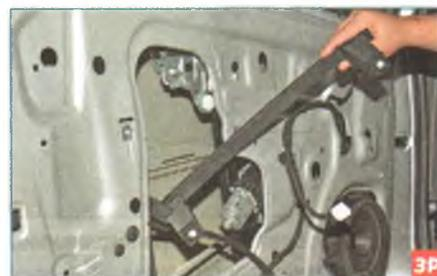
...и извлекаем направляющую стекла через технологическое отверстие во внутренней панели двери.
