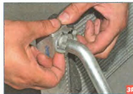
...разжимая пружинный держатель, сдвигаем его вверх...
