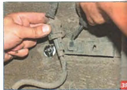
Нажимаем шлицевой отверткой на фиксатор держателя колодки жгута проводов кузова и сдвигаем колодку с держателя вверх.
