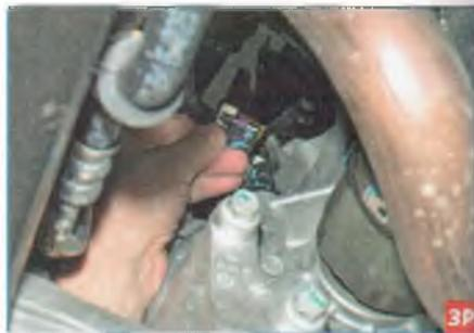
...и отсоединяем колодку жгута проводов от разъема датчика скорости.
