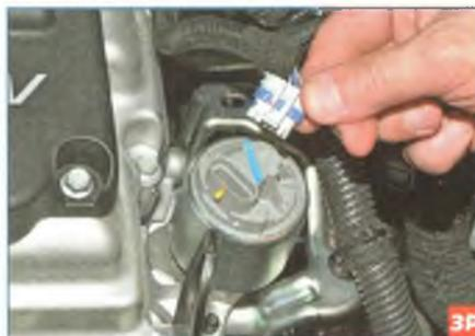
...отсоединяем колодку от разъема клапана.
