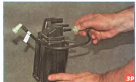
Нажав на фиксатор наконечника трубки отвода паров топлива из адсорбера, снимаем наконечник с переднего штуцера адсорбера.
