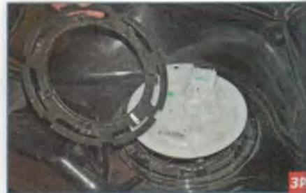
...и снимаем прижимное кольцо крышки модуля.
