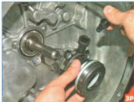
...и вынимаем наконечник трубки из наконечника рабочего цилиндра.
