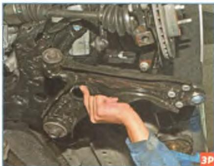
Снимаем рычаг передней подвески (см. «Снятие рычага», с. 150).
