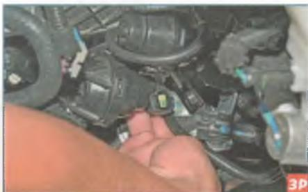
...отсоединяем колодку от разъема клапана.
