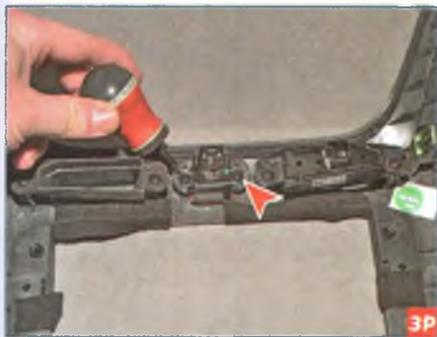
Крестообразной отверткой отворачиваем два самореза крепления выключателя аварийной сигнализации.
