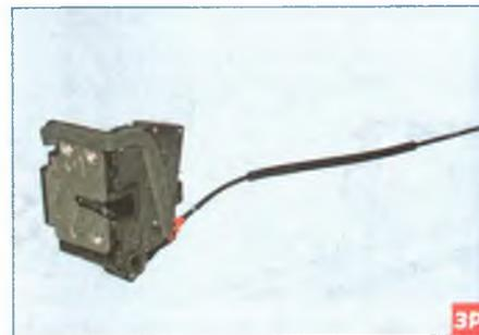
Замок задней двери с электроприводом и тросом внутренней ручки. Устанавливаем замок задней двери в обратной последовательности.
