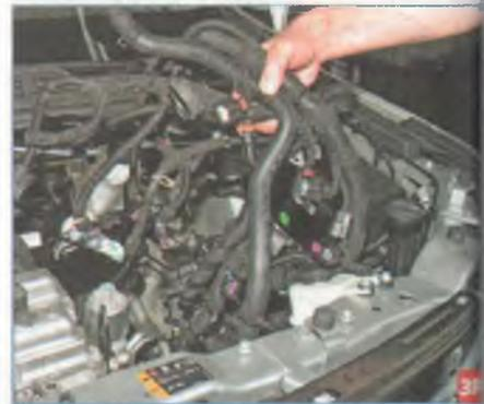
Отводим жгуты проводов в сторону от силового агрегата.
