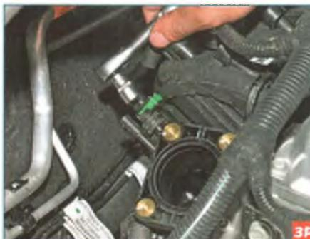
Головкой «на 10» отворачиваем болт крепления клапана к впускному трубопроводу...
