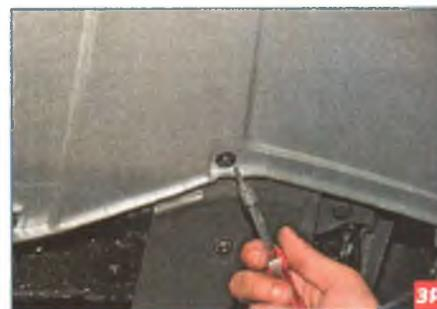
Ключом Torx T-20 отворачиваем саморез крепления переднего бампера с правой стороны.
