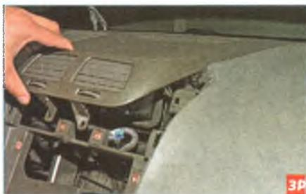
Приподнимаем край корпуса дефлекторов вверх и, преодолев сопротивление фиксаторов...
