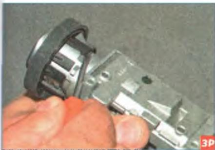
Отверткой поочередно отжимаем три фиксатора катушки, выводя их из зацепления с корпусом выключателя зажигания (для наглядности показано на снятом выключателе зажигания)...
