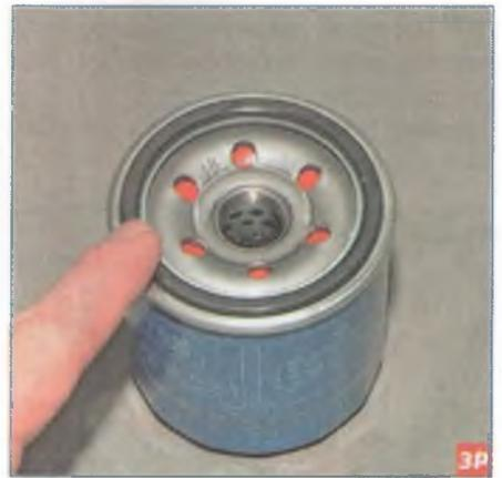
Наносим моторное масло на уплотнительное кольцо фильтра.
