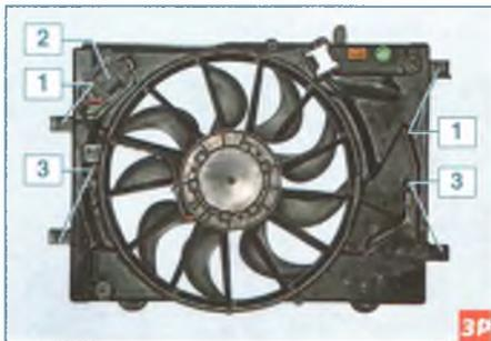
Вентилятор с кожухом в сборе: 1 – кронштейны верхнего крепления кожуха; 2 – дополнительный резистор вентилятора; 3 – кронштейны нижнего крепления кожуха
