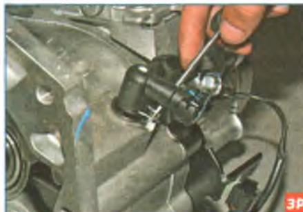
Поддев отверткой, выдвигаем фиксатор переходника трубки подвода жидкости к рабочему цилиндру (для наглядности показано на снятой коробке передач) ...
