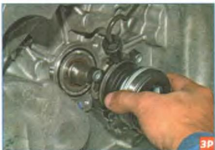
...и отводим его от торца картера сцепления.
