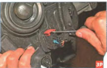
Отверткой сдвигаем фиксатор колодки проводов...
