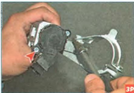
Ключом Torx T-20 отворачиваем два винта...
