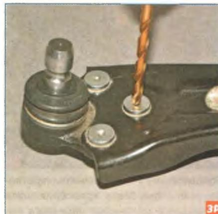
Сверлом  $\varnothing 12$  мм высверливаем головки трех заклепок, крепящих корпус шаровой опоры к рычагу.
