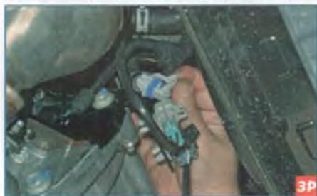
Снизу автомобиля отжимаем фиксатор колодки (серого цвета) жгута проводов системы управления двигателем и отсоединяем колодку от колодки жгута проводов управляющего датчика концентрации кислорода.
