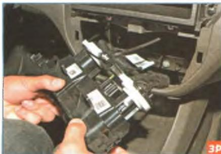
Вынимаем блок управления отоплением, вентиляцией и кондиционированием из ниши панели приборов.
