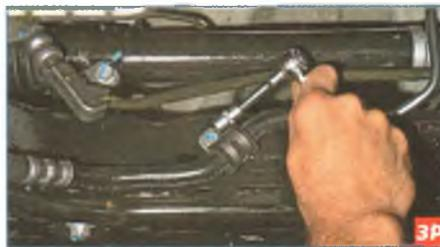
Тем же инструментом отворачиваем болт крепления другого держателя шланга...
