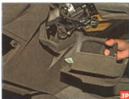
...и снимаем нижний кожух рулевой колонки.
