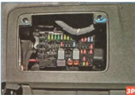
Пинцетом (из монтажного блока в моторном отсеке) вынимаем перегоревший предохранитель малого размера.
