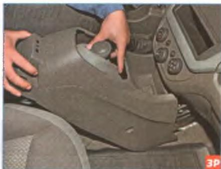
Снимаем переднюю часть облицовки туннеля пола, продев рамку с декоративным чехлом рычага переключения передач через отверстие в облицовке. Устанавливаем обе части облицовки туннеля пола в обратной последовательности.
