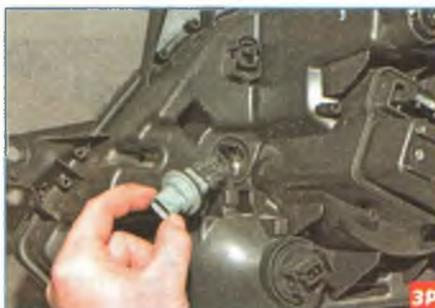
...и вынимаем патрон с лампой из корпуса блок-фары.
