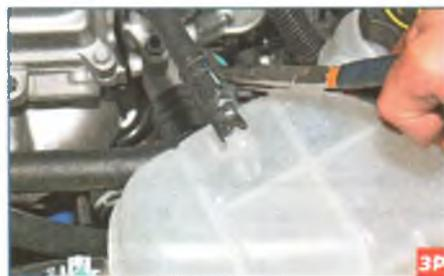
Пассатижами сжимаем концы хомута крепления паротводящего шланга и, сдвинув хомут по шлангу...
