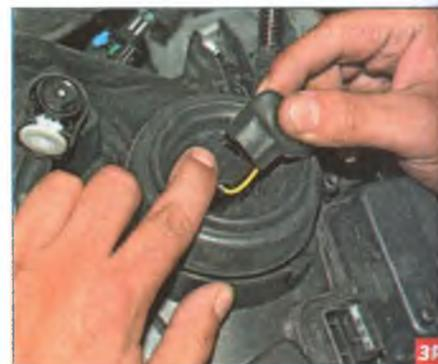
...снимаем защитный колпачок с колодки проводов.
