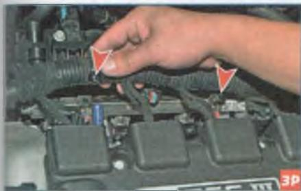
Выводим усики двух держателей жгута проводов из отверстий в топливной рампе.
