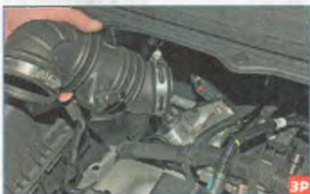
...и вынимаем шланг. Для наглядности дальнейшие операции показываем при демонтированном воздушном фильтре.
