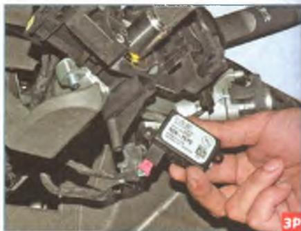
...и снимаем блок управления иммобилайзером.
