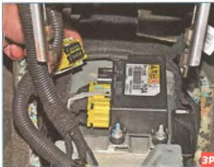
...и отсоединяем колодку от разъема блока.
