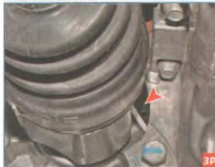
...через щель в месте соединения картера сцепления с поддоном картера двигателя (рядом с корпусом внутреннего шарнира привода правого колеса)...
