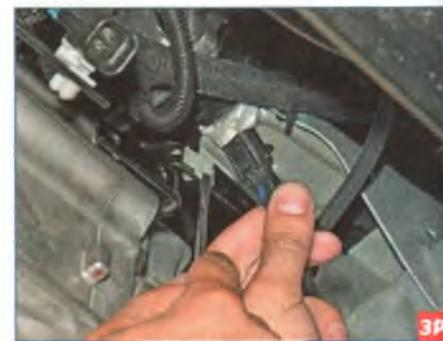
Нажав отверткой на край держателя колодки, снимаем колодку проводов выключателя с держателя.
