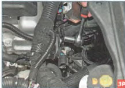
Головкой «на 10» отворачиваем болт крепления датчика...
