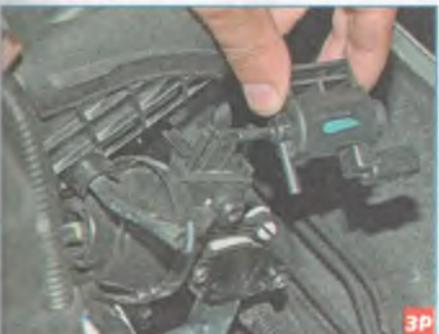
...сдвигаем клапан с кронштейна...
