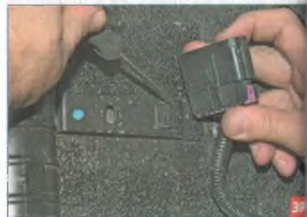
Нажав шлицевой отверткой на фиксатор, сдвигаем вверх с держателя колодку жгута проводов топливного бака.
