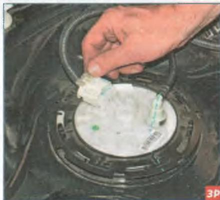
Выдвигаем фиксатор колодки жгута проводов топливного бака...
