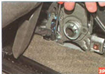
Отжав тонкой шлицевой отверткой фиксатор на выключателе сигнала тормоза стояночного тормоза...
