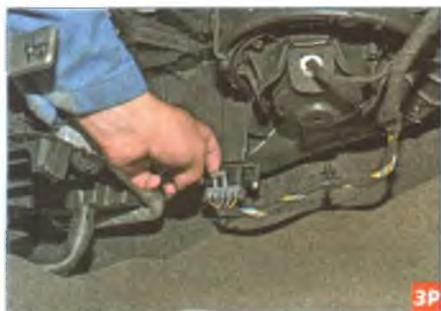
Отжав фиксатор колодки проводов...
