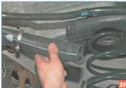
...и, сдвинув хомут по шлангу, снимаем шланг с наливной трубы.
