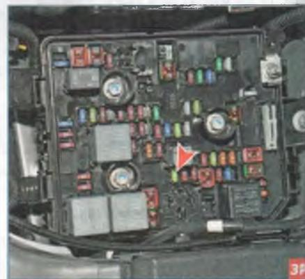
...вынимаем из монтажного блока предохранителей и реле в моторном отсеке предохранитель топливного насоса. Пускаем двигатель и даем ему поработать на холостом ходу до остановки из-за выработки топлива в системе. Затем включаем стартер на 2–3 с. При этом давление в трубопроводах системы питания будет сброшено и трубопроводы можно разъединять.
