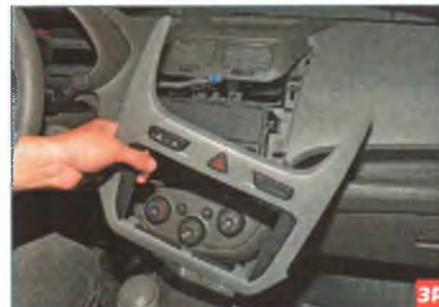
...и снимаем центральную накладку панели приборов с выключателями.
