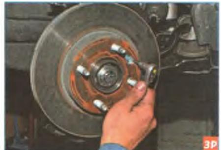
Ключом Torx T-30 отворачиваем винт крепления диска...
