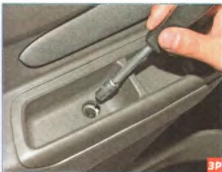
Головкой «на 7» отворачиваем саморез крепления обивки к кронштейну ручки из паза основания ручки (показан стрелкой).
