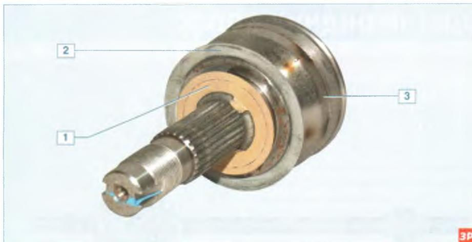
Наружный шарнир в сборе: 1 – металлическая шайба; 2 – грязезащитное кольцо; 3 – корпус
