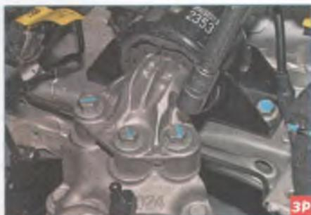
Головкой «на 15» отворачиваем три болта крепления левой опоры силового агрегата к ее кронштейну на коробке передач (трос управления коробкой передач снят для наглядности).
