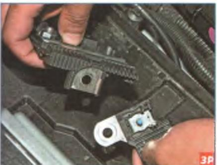
Снимаем предохранитель монтажного блока в салоне.
