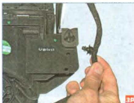
Вынимаем держатель жгута проводов из кронштейна вентилятора.
