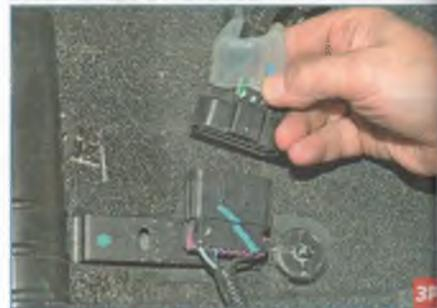
...и, нажав на фиксатор, отсоединяем колодку от колодки жгута проводов топливного бака.
