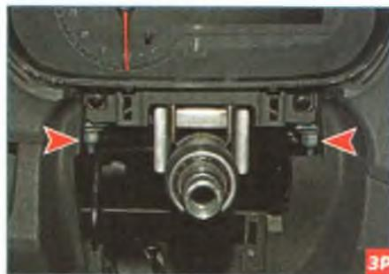
Той же головкой с удлинителем отворачиваем две гайки крепления кронштейна рулевой колонки к каркасу панели приборов.
