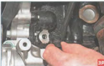
...и снимаем датчик. Устанавливаем датчик сигнализатора недостаточного давления масла в обратной последовательности. Затягиваем датчик моментом 20 Н·м.
