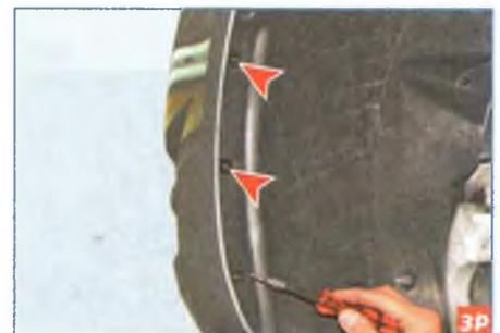
В арке колеса ключом Torx T-20 отворачиваем три самореза крепления передней части подкрылка к переднему бамперу...
