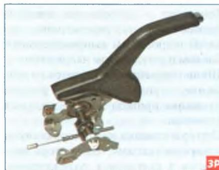
Рычаг стояночного тормоза с передним тросом в сборе.
