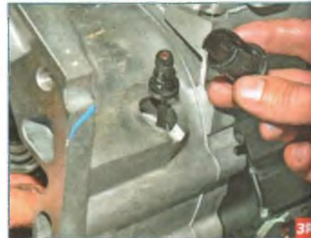
...и снимаем втулку с наконечника трубки.
