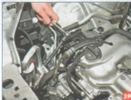
Головкой на «13» отворачиваем гайку крепления к шпильке левого лонжерона соединителя трубок системы кондиционирования воздуха.
