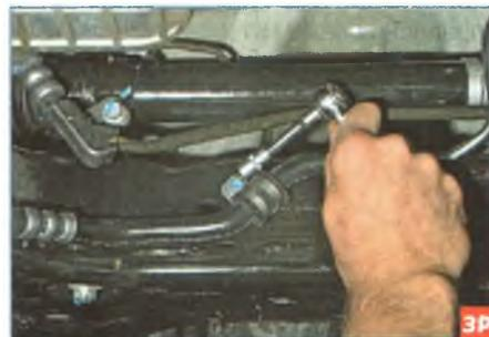
Головкой «на 10» с удлинителем отворачиваем болт крепления держателя шланга сливной магистрали гидроусилителя к подрамнику передней подвески.
