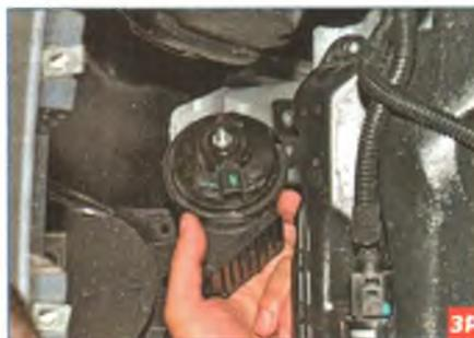
Снимаем сигнал с кронштейна. Если нужно снять сигнал с кронштейном...
