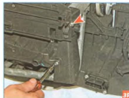
Головкой «на 5,5» отворачиваем два самореза...
