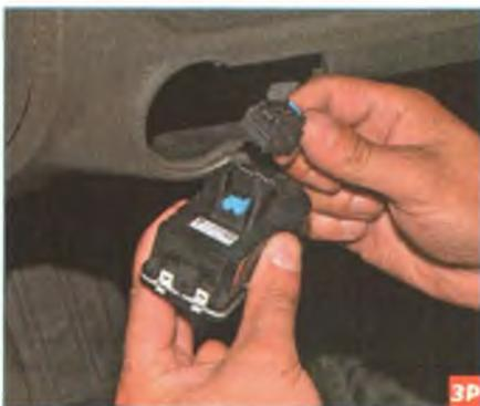
Нажав на фиксатор колодки проводов, отсоединяем колодку от разъема блока...
