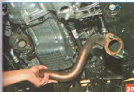
Снимаем промежуточную трубу.
