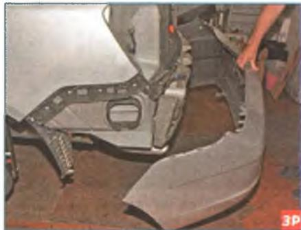
...и снимаем задний бампер.
