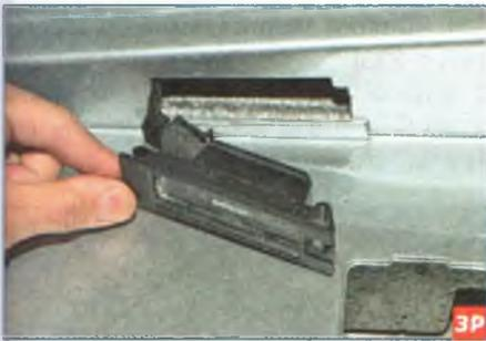
...и вынимаем фонарь из бампера.
