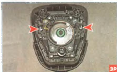
...двумя пружинными фиксаторами, которые входят в зацепление...
