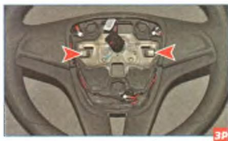
...с двумя крючками на рулевом колесе (для наглядности показано со снятой подушкой).
