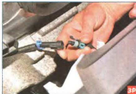
...разъединяем колодки жгута проводов фонарей подсветки номерного знака. Поддерживая левую сторону бампера, аналогично отделяем правую сторону бампера от кузова...
