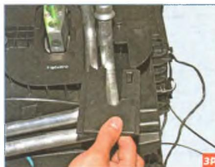
...и снимаем крышку трубок радиатора отопителя.
