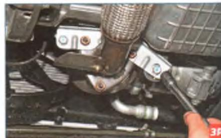
Головкой «на 13» отворачиваем два болта крепления кронштейна промежуточной трубы к кронштейну двигателя.
