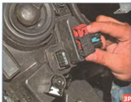
...и отсоединяем колодку от мотор-редуктора регулятора направления пучка света фар.
