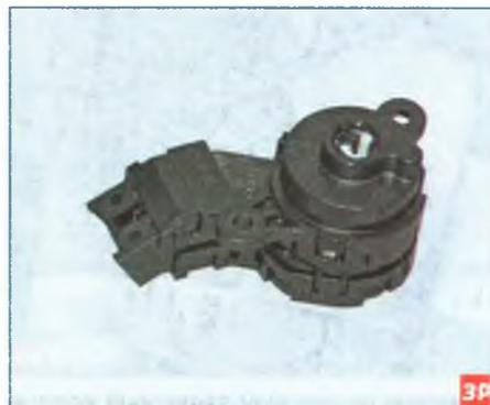
**Контактная группа выключателя зажигания.**
