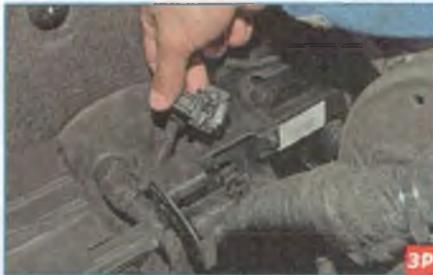
...и вынимаем датчик из отверстия кронштейна pedalного узла.
