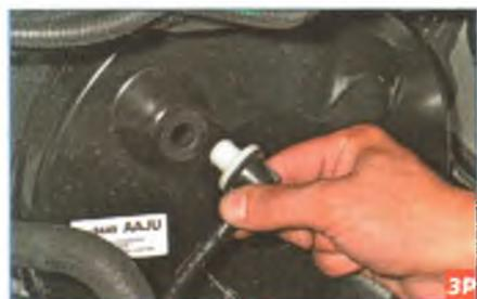
Вынимаем штуцер обратного клапана из отверстия резиновой втулки в корпусе вакуумного усилителя тормозов. В салоне автомобиля под панелью приборов (для наглядности операцию показываем при снятой панели приборов)...
