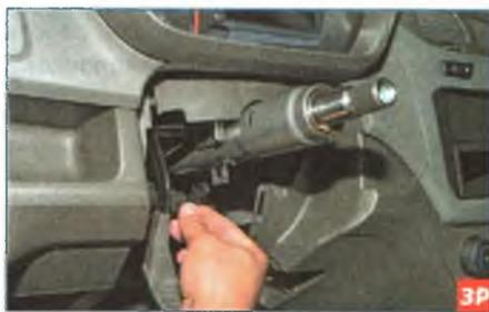
Снимаем пластмассовый держатель жгута проводов с рулевой колонки.
