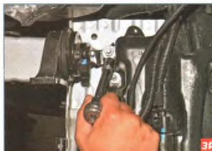
...головкой «на 13» отворачиваем гайку (для наглядности показано при снятом бампере).
