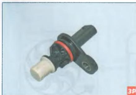
Датчик положения коленчатого вала
