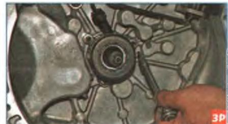
Шестигранником «на 5» отворачиваем три винта крепления рабочего цилиндра...
