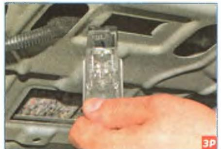
...и вынимаем его из основания задней полки.
