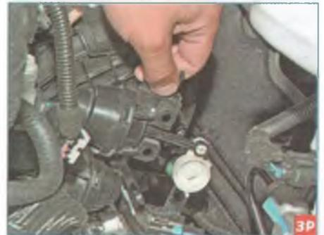
Сдвинув кулису механизма с вала за-слонок, снимаем пневмокамеру с кулисой в сборе.
