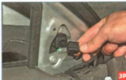
Нажав на фиксатор колодки, отсоединяем колодку жгута проводов от колодки наружного зеркала.
