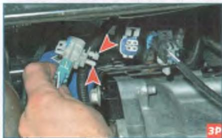
Выводим два фиксатора колодки жгута проводов датчика из отверстий кронштейна.
