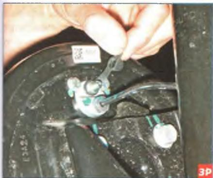
Снимаем защитный колпачок со штуцера прокачки цилиндра.
