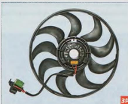
**Электродвигатель в сборе с крыльчаткой и дополнительным резистором образуют неразборное соединение.**
