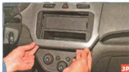
...отжимаем накладку от панели приборов, выводя из зацепления фиксаторы накладки...
