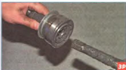
Снимаем наружный шарнир с вала.
