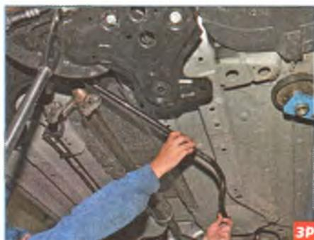
...и снимаем штангу стабилизатора поперечной устойчивости.
