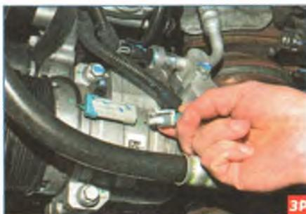
...и отсоединяем колодку жгута проводов от колодки проводов электромагнитной муфты компрессора.
