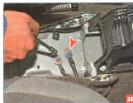
Головкой «на 10» отворачиваем две гайки...
