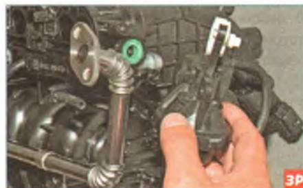
...демонтируем пневмокамеру с кулисой механизма и клапаном в сборе (см. «Снятие электромагнитных клапанов и пневмокамер системы изменения геометрии каналов впускного трубопровода», с. 96).
