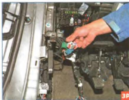
Поочередно нажав на фиксаторы колодок проводов, отсоединяем пять колодок от коммутационного блока.
