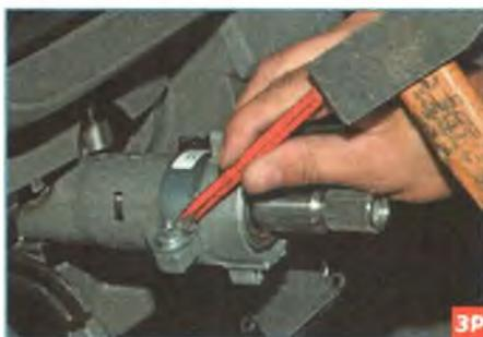
...с помощью зубила отворачиваем на несколько оборотов болт...
