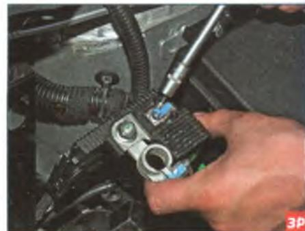
Головкой «на 8» отворачиваем гайку...
