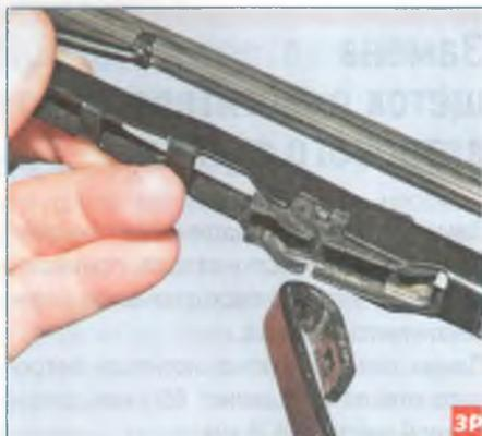
**Снимаем щетку с рычага.**
