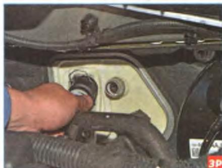
...и отсоединяем отводящий шланг от трубки радиатора отопителя.
