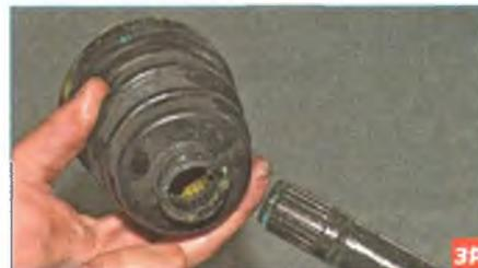
Снимаем с вала грязезащитный чехол.
