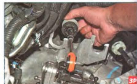
Отсоединяем тросы выбора и включения передач от рычагов механизма переключения передач и выводим наконечники оболочек тросов из кронштейна коробки передач (см. «Замена тросов механизма управления коробкой передач», с. 134).
