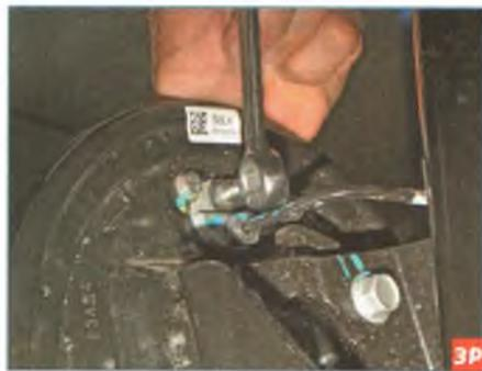
Специальным ключом «на 13» для штуцеров тормозных трубок отворачиваем штуцер тормозной трубки.
