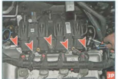
Головкой «на 13» отворачиваем пять болтов крепления впускного трубопровода к головке блока цилиндров. Из отверстий трубопровода болты полностью не вынимаются.
