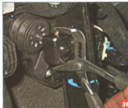
...и, надавив на фиксатор через упор с помощью раздвижных пассатижей, выводим фиксатор вкладыша из зацепления с корпусом шарнира.
