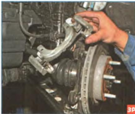
...и снимаем направляющую колодок. При втором способе демонтируем направляющую колодок в сборе с суппортом и колодками. Для этого снимаем пружинный фиксатор наружной колодки и, вставив шлицевую отвертку в окно суппорта между поршнем и колодкой, утапливаем поршень в цилиндре и сдвигаем суппорт (см. «Замена колодок тормозных механизмов передних колес», с. 177).
