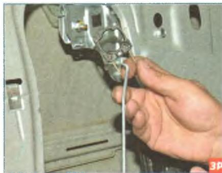
Снимаем пластмассовый фиксатор с цилиндра замка...
