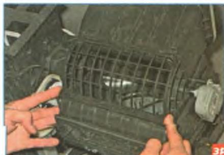
Сжимаем фиксаторы с двух сторон решетки...
