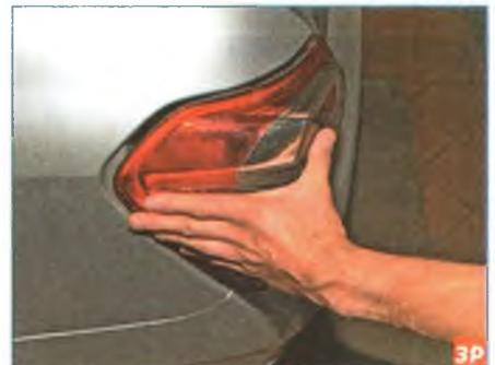
Сдвигаем фонарь назад по ходу автомобиля, выводя два штифта фонаря из пластмассовых втулок на кузове.
