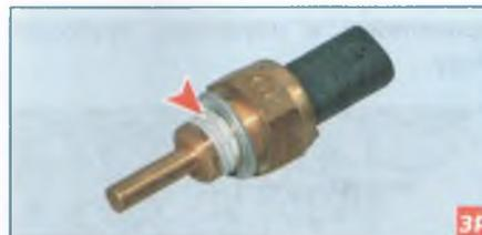
Соединение датчика и выпускного патрубка уплотняется шайбой из мягкого металла и тонким слоем герметика, нанесенным на резьбовую часть датчика. Устанавливаем датчик температуры охлаждающей жидкости в обратной последовательности и затягиваем его моментом 20 Н·м. Доводим до нормы уровень жидкости в системе охлаждения (см. «Проверка уровня и доливка охлаждающей жидкости», с. 17).
