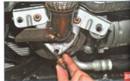
В случае если гайка отвернулась вместе со шпилькой, то следует свернуть гайку со шпильки...
