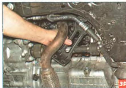
Снимаем кронштейн впускного трубопровода (см. «Снятие датчика детонации», с. 79).
