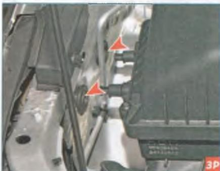
...выводя две его боковых опоры из отверстий резиновых подушек, установленных в брызговике.
