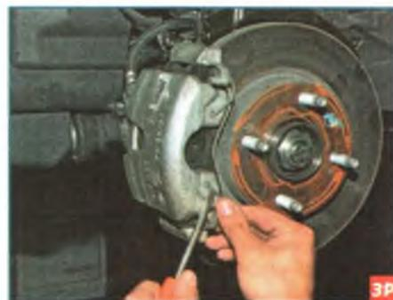
Поддев отверткой, освобождаем пружинный фиксатор наружной колодки...
