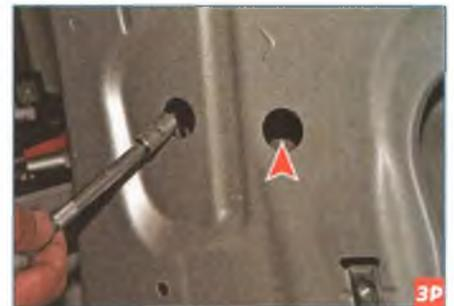
Головкой «на 8» с удлинителем отворачиваем две гайки крепления наружной ручки к двери...
