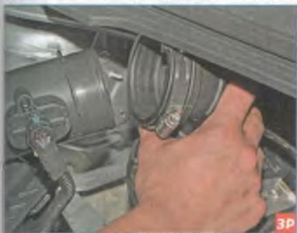
...и снимаем шланг с патрубка крышки фильтра.
