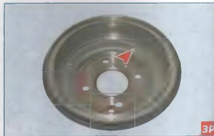
Маркировка на внутренней стороне барабана тормозного механизма – внутренний диаметр барабана не должен быть больше 202,0 мм.
