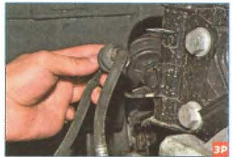
Вынимаем муфту шланга тормозного механизма из прорези в кронштейне амортизаторной стойки.
