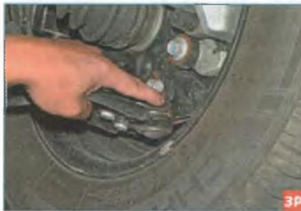
Проверяем состояние защитных чехлов шаровых опор.
