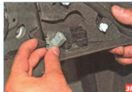
...и отсоединяем колодку жгута проводов от регулятора электропривода наружных зеркал.
