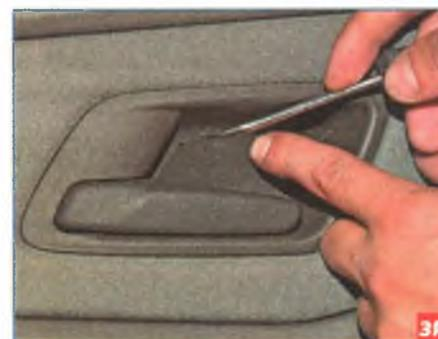
Отверткой с тонким лезвием поддеваем декоративную заглушку и, преодолев сопротивление трех фиксаторов, извлекаем ее из полости внутренней ручки двери.
