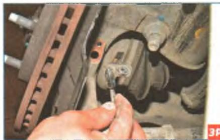
...и вынимаем датчик из отверстия в поворотном кулаке.
