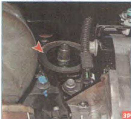
Очищаем посадочное место фильтра на двигателе от грязи и потеков масла.
