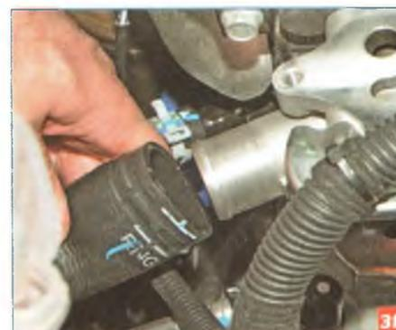
...снимаем шланг с выпускного патрубка.
