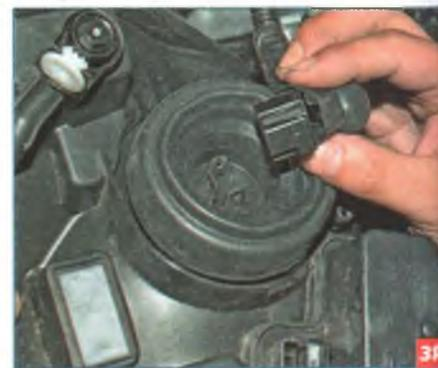
Отсоединяем колодку проводов от лампы.
