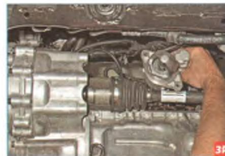
Снимаем стартер. Для оценки исправности привода стартера...
