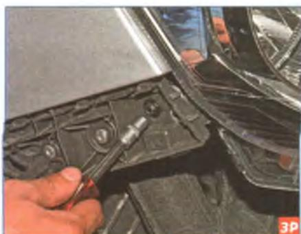
Тем же инструментом отворачиваем саморез нижнего...
