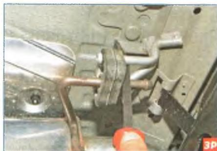
...с помощью монтажной лопатки...
