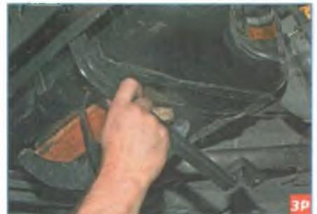
...и снимаем хомут топливного бака. Аналогично снимаем другой хомут топливного бака. Сдвигаем топливный бак вправо, выводя его левую часть из-под трубы основного глушителя системы выпуска отработавших газов.
