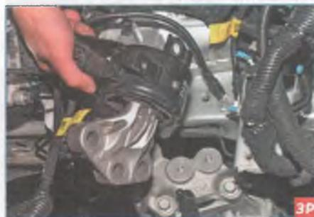
Вынимаем левую опору силового агрегата из моторного отсека.
