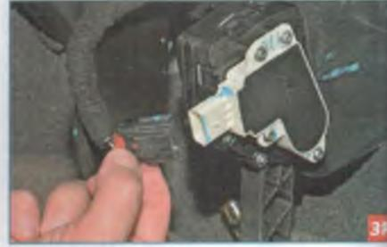
...и, нажав на фиксатор, отсоединяем колодку жгута проводов от разъема модуля педали «газа».
