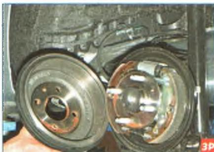
...и снимаем барабан.
