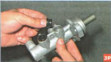
Вынимаем резиновые втулки из гнезд цилиндра, осматриваем их и при необходимости заменяем новыми.
