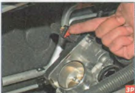
Сдвигаем стопор (красного цвета) фиксатора колодки жгута проводов системы управления двигателем...
