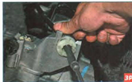
Отжимаем фиксатор наконечника оболочки троса включения передач от кронштейна (назад)...
