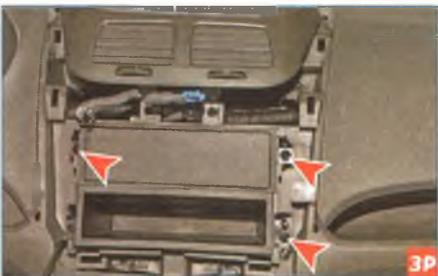
Крестообразной отверткой отворачиваем четыре самореза крепления полки для мелких вещей...
