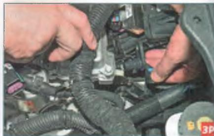
...и вынимаем датчик из гнезда в головке блока цилиндров.
