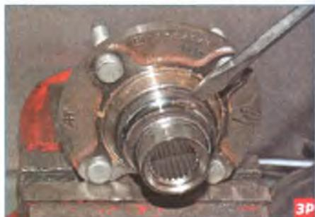
...в образовавшийся зазор, вставляем мощную отвертку...
