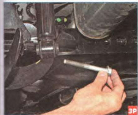
...и вынимаем болт.
