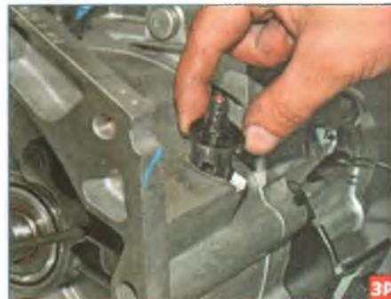
...и вынимаем ее из отверстия картера сцепления.
