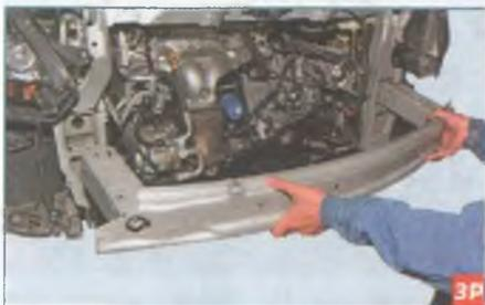
...и снимаем поперечную балку.
