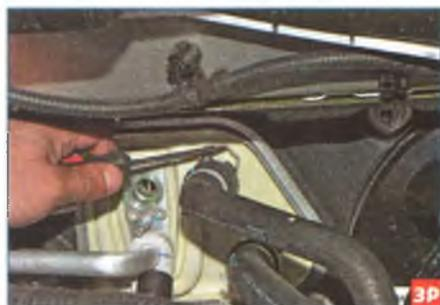
Отверткой сдвигаем пружинный фиксатор наконечника шланга...
