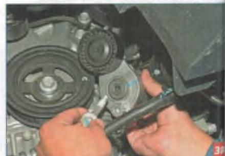
Вынимаем болт и снимаем натяжное устройство.
