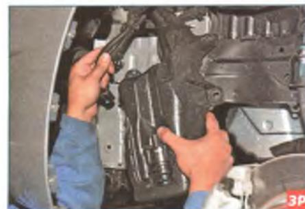
Снимаем бачок со шпилек...
