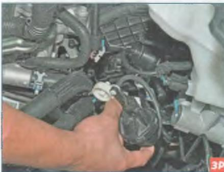
Сдвинув кулису механизма с вала заслонок, снимаем пневмокамеру с кулисой и клапаном в сборе.
