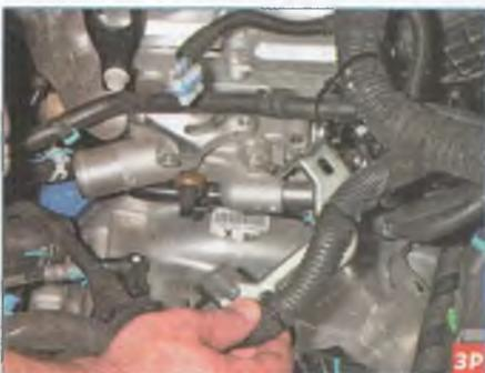
Отсоединяем кронштейн жгута проводов от выпускного патрубка системы охлаждения (см. «Снятие выпускного патрубка», с. 109).
