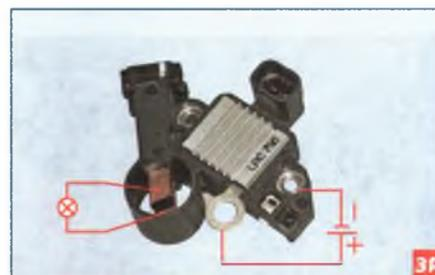
...подсоединяем к щеткам лампу (1–3 Вт, 12 В), а к выводам щеткодержателя источник постоянного тока, вначале напряжением 12 В, а затем 15–16 В.
