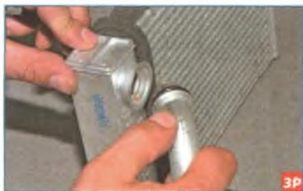
Вынимаем отводящую трубку из отверстия радиатора.
