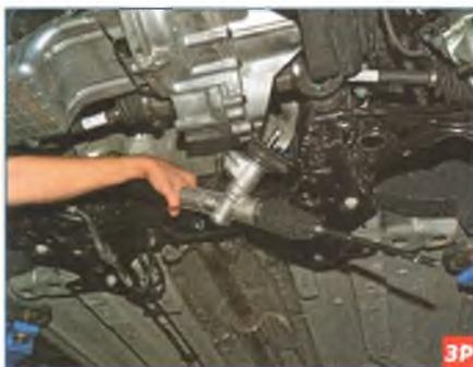
Сдвигаем рулевой механизм обратно влево и снимаем его с подрамника.
