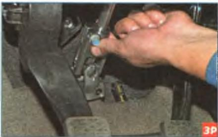
...вынимаем болт и сдвигаем вилку нижнего карданного шарнира промежуточного вала с вала приводной шестерни.
