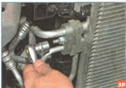
Головкой «на 13» отворачиваем гайку...
