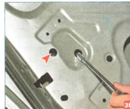
Через отверстия во внутренней панели двери головкой «на 8» с удлинителем отворачиваем две гайки крепления наружной ручки.
