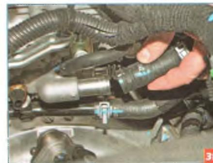
Аналогично отсоединяем от штуцера выпускного патрубка шланг подвода жидкости к радиатору отопителя.
