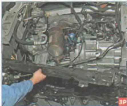
...и снимаем поперечину.
