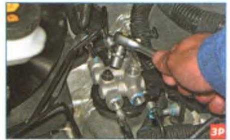
Головкой «на 10» отворачиваем гайку крепления блока регуляторов давления...
