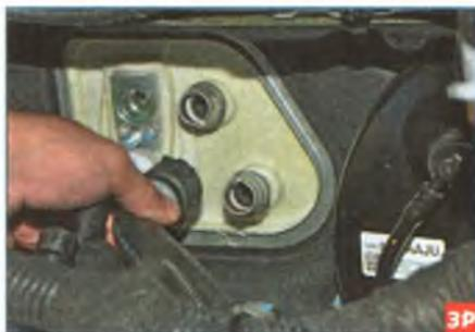
Аналогично отсоединяем подводящий шланг от трубки радиатора отопителя.
