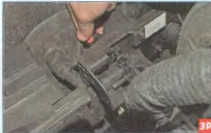
Не отсоединяя колодку жгута проводов от разъема датчика, поворачиваем датчик по часовой стрелке до совмещения выступов на его корпусе с пазами в отверстии кронштейна pedalного узла...
