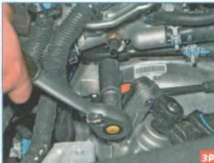
Высокой головкой «на 19» выворачиваем датчик из отверстия в выпускном патрубке...
