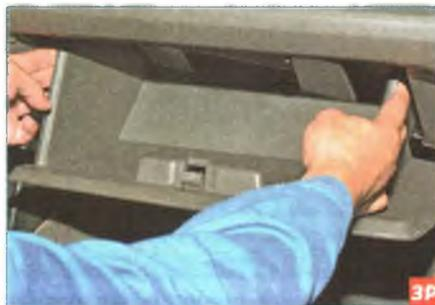
Поджимаем боковые стенки вещевого ящика внутрь.
