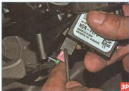
Нажав отверткой на фиксатор колодки проводов...
