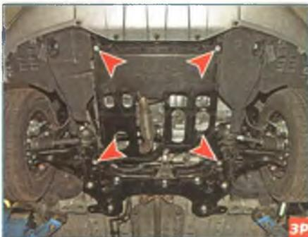
Расположение болтов крепления защиты силового агрегата.
