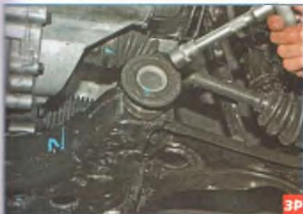
Головкой «на 18» с удлинителем отворачиваем болт крепления переднего сайлент-блока рычага к подрамнику...
