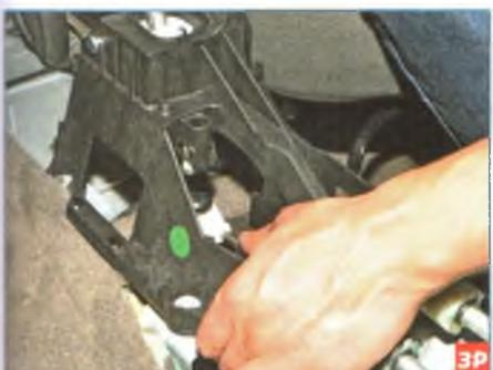
...и снимаем его с шарового конца рычага переключения передач.
