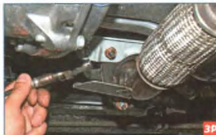
Демонтируем диагностический датчик концентрации кислорода (см. «Снятие датчиков концентрации кислорода», с. 77).
