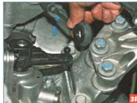
Аналогично снимаем наконечник троса включения передач с шарового пальца рычага включения передач.
