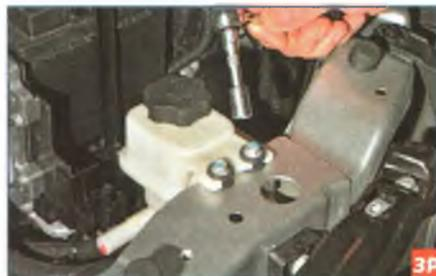
Головкой «на 10» отворачиваем два болта крепления бачка к верхней поперечине рамки радиатора...
