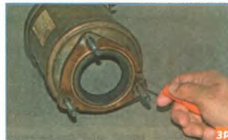
Для этого отверткой с тонким лезвием поддеваем прокладку...
