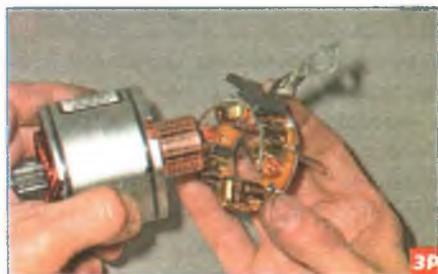
Устанавливаем щеткодержатель на коллектор якоря...
