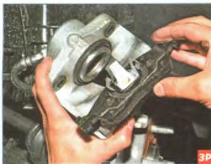
Преодолевая сопротивление лепестков пружинного фиксатора внутрен-
