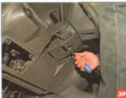
Крестообразной отверткой отворачиваем саморез крепления нижнего кожуха...
