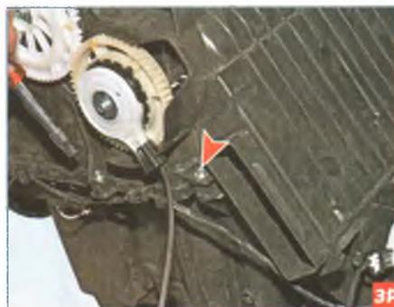
Тем же инструментом отворачиваем два самореза слева...
