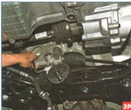
Сдвигаем рулевой механизм к правому борту автомобиля, выводя рулевую тягу с наконечником из-за подрамника.
