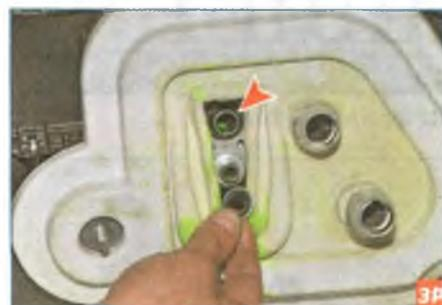
Снимаем уплотнительные кольца с трубок испарителя.
