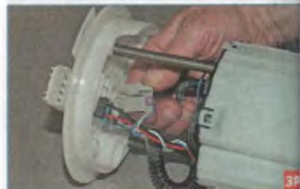
...нажимаем на фиксатор колодки проводов датчика и отсоединяем ее от разъема крышки модуля.
