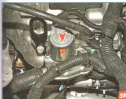
Расположение клапана рециркуляции отработавших газов.
