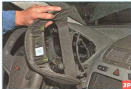
...и снимаем облицовку комбинации приборов.
