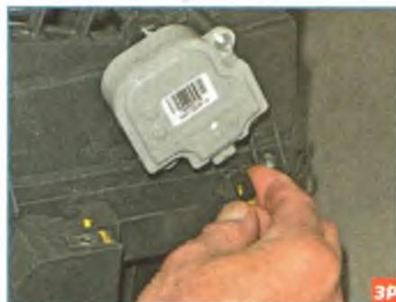
Отжав фиксатор колодки проводов, отсоединяем колодку от разъема привода заслонки рециркуляции.
