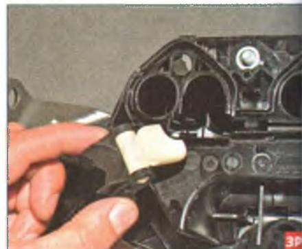
...и из окна канала трубопровода, подводящего воздух к 1-му цилиндру, вынимаем вставку с заслонкой, изменяющей сечение окна.
