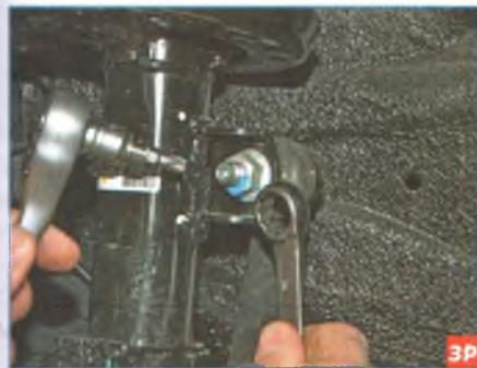
Накидным ключом «на 18» отворачиваем гайку крепления пальца верхнего шарового шарнира стойки стабилизатора поперечной устойчивости к кронштейну амортизаторной стойки, удерживая палец от проворачивания ключом Torx T-40.
