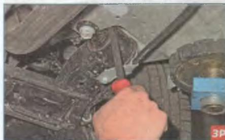
**...вставляем монтажную лопатку между проушиной рычага и задним лонжероном и пытаемся сдвинуть рычаг в разных направлениях.**
