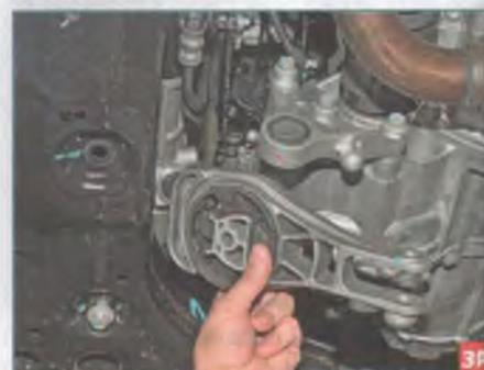
Снимаем заднюю опору.
