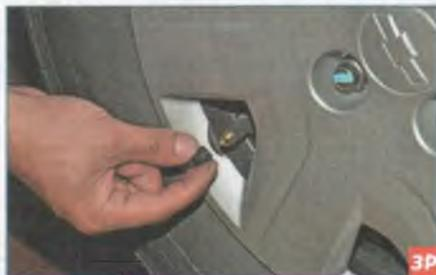
...отворачиваем колпачок колесного вентиля...
