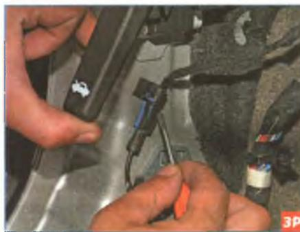
Отверткой нажимаем на фиксатор колодки...
