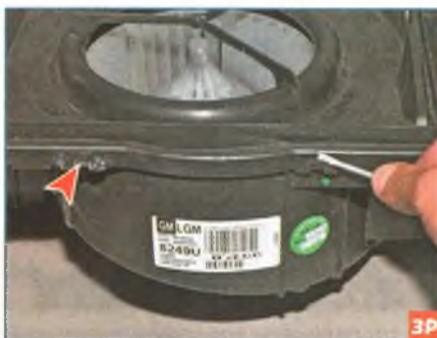
Отверткой отжимаем два фиксатора...
