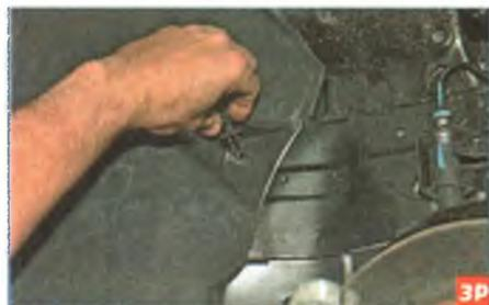
...и вынимаем пистон из отверстия лонжерона.
