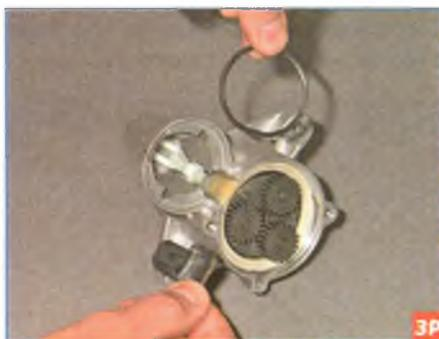
Вынимаем уплотнительное кольцо тягового реле и резиновую опору рычага.
