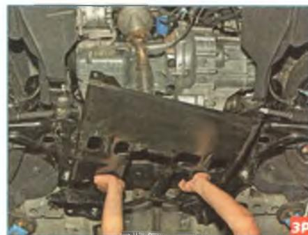
Снимаем защиту силового агрегата.
