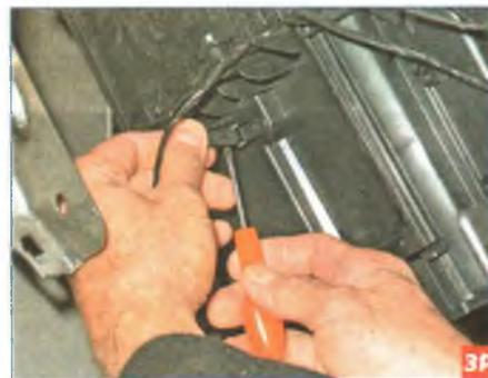
Поддев отверткой край разъема датчика, отсоединяем колодку проводов от датчика.
