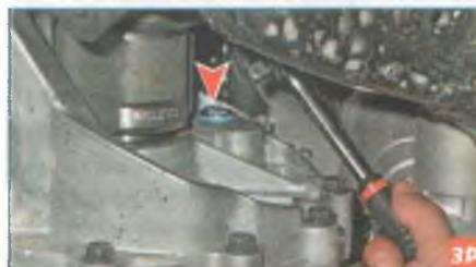
Квадратом «на 9,5» отворачиваем пробку контрольного отверстия.
