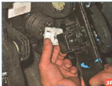
...и вынимаем вкладыш шарнира из его корпуса.
