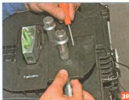
Отверткой нажимаем на фиксатор крышки...
