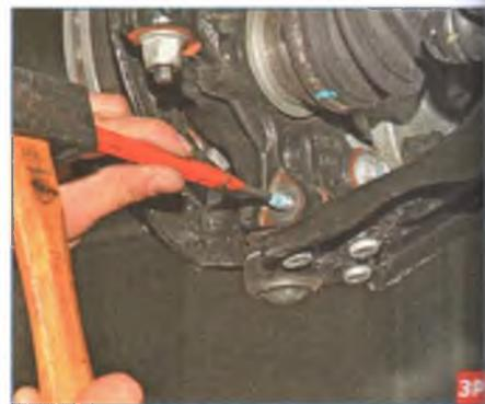
Вынимаем болт или при затруднении его извлечения выбиваем болт с помощью борodka.
