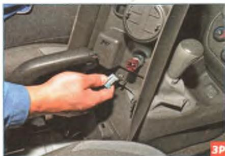
Отсоединяем колодку жгута проводов от разъема электрической розетки...
