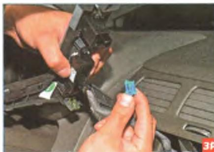
Нажав на фиксатор колодки проводов, отсоединяем колодку от выключателя аварийной сигнализации.
