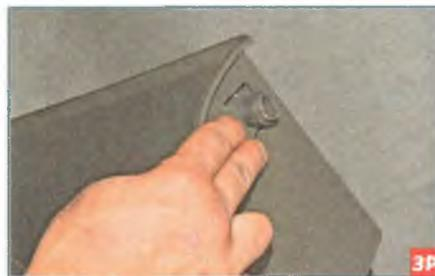
На фото показано место поджатия стенки вещевого ящика. Откинув вещевой ящик на максимальный угол...
