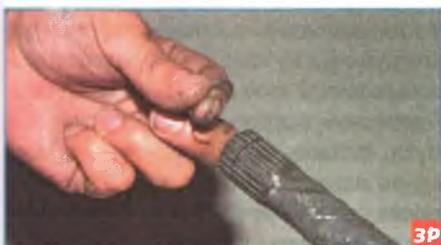
...вынимаем его из проточки на валу.
