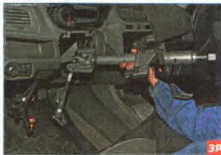
Вынимаем рулевую колонку с промежуточным валом из-под панели приборов. Устанавливаем рулевую колонку в обратной последовательности.
