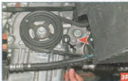
...надеваем двенадцатигранный накидной ключ «на 19» на соответствующий выступ натяжного устройства...
