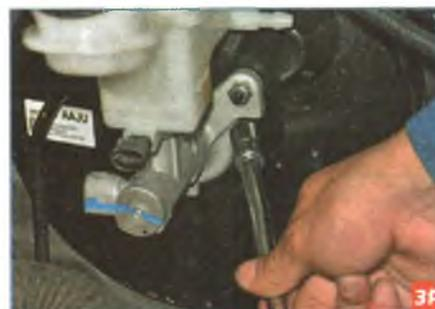
Головкой «на 13» с удлинителем отворачиваем гайку крепления главного цилиндра к вакуумному усилителю тормозов с одной стороны...
