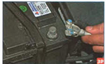
...и снимаем клемму проводов с вывода батареи.
