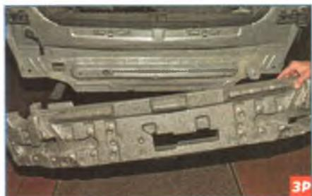
**Снимаем усилитель бампера.**
