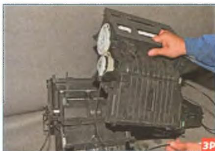
Снимаем заднюю часть корпуса отопителя.
