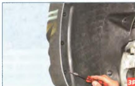
...в арке колеса ключом Torx T-20 отворачиваем три самореза крепления передней части подкрылка к переднему бамперу...
