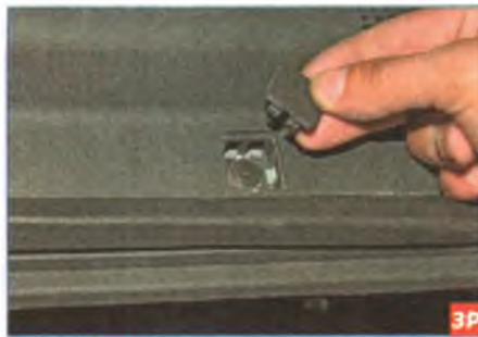
...вынимаем заглушку в середине облицовки ветрового окна.
