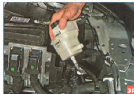
Снимаем шланг с патрубка бачка и снимаем бачок.
