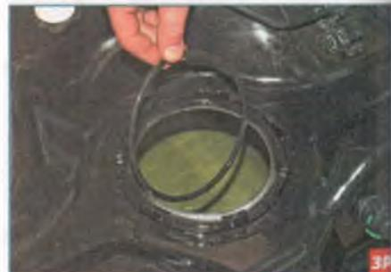
Снимаем резиновое уплотнительное кольцо соединения крышки модуля с фланцем горловины бака.
