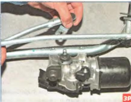
Снимаем кривошип с вала мотор-редуктора.
