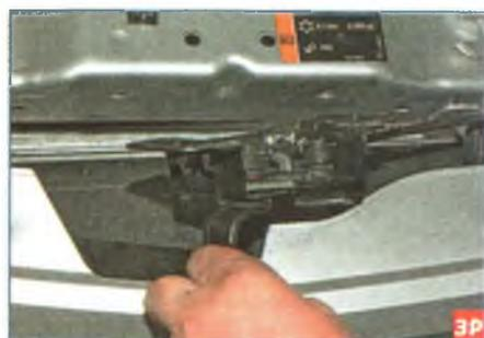
...и отводим замок от верхней поперечины рамки радиатора.
