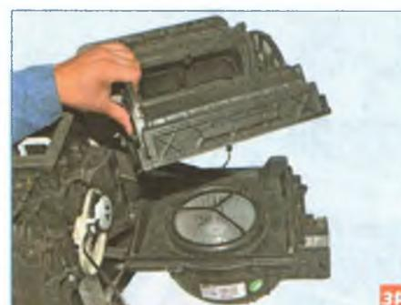
...и снимаем корпус заслонки рециркуляции.
