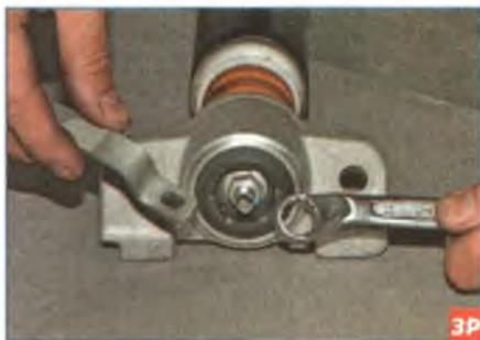
Накидным Z-образным ключом «на 15» отворачиваем гайку крепления штока амортизатора к верхней опоре, удерживая
