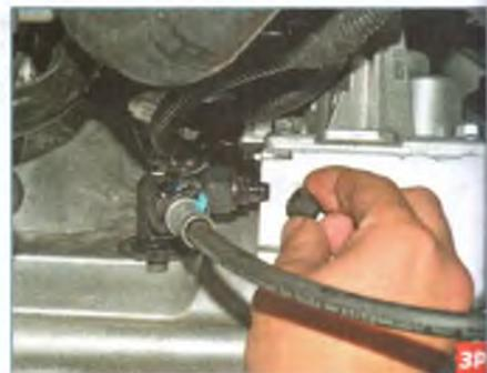
Снимаем защитный колпачок со штуцера прокачки.
