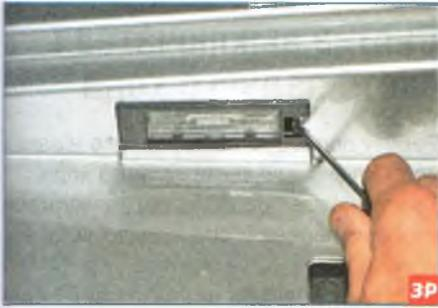
Отверткой нажимаем на фиксатор...
