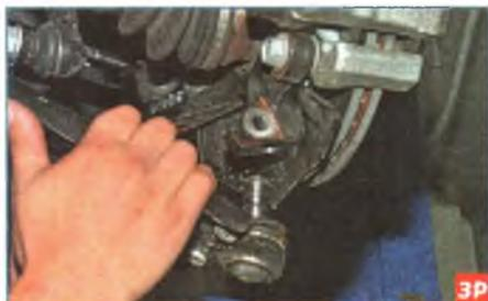
Выводим палец шаровой опоры передней подвески из отверстия поворотного кулака (см. «Снятие рычага», с. 150). Поворачиваем рулевое колесо в сторону, противоположную снимаемому приводу.
