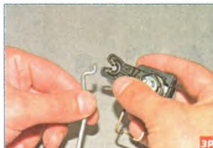
Выводим тягу цилиндра замка из отверстия рычага (для наглядности показано на снятом цилиндре).
