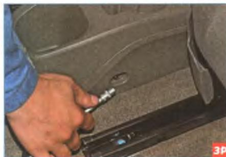
Головкой «на 7» отворачиваем с правой стороны саморез крепления задней части облицовки туннеля пола.
