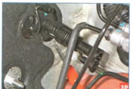
...выдвигаем фиксатор дроссельного клапана...
