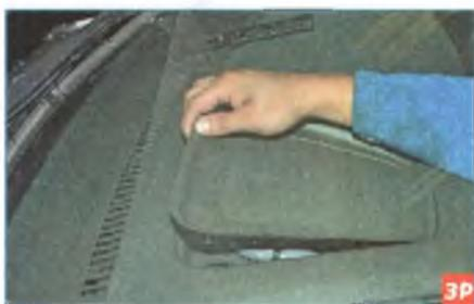
...и поднимаем накладку, преодолевая сопротивление фиксаторов.
