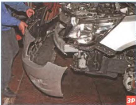
...и снимаем с помощником передний бампер. Устанавливаем передний бампер в обратной последовательности.
