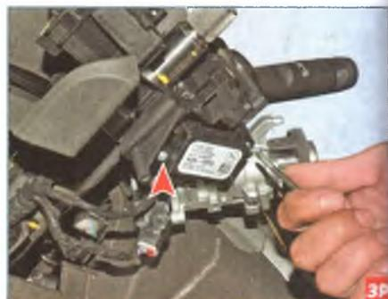
...крестообразной отверткой отворачиваем два самореза (барабанное устройство спирального кабеля снято для наглядности) ...
