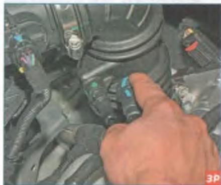
...отсоединяем наконечник трубки от штуцера шланга подвода воздуха к дроссельному узлу.
