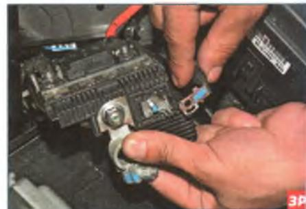
...и отсоединяем провод, идущий к монтажному блоку в салоне.
