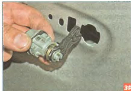
...и вынимаем из двери цилиндр замка. Устанавливаем наружную ручку передней двери и цилиндр замка в обратной последовательности.
