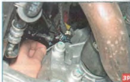
Шлицевой отверткой отжимаем фиксатор колодки жгута проводов системы управления двигателем...
