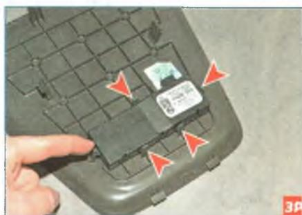
Поочередно отжимаем пять фиксаторов...
