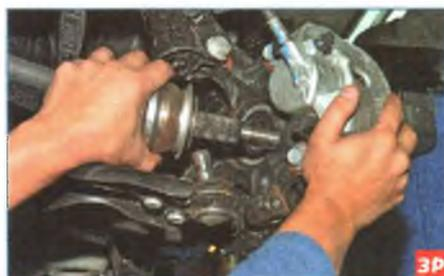
Отводим поворотный кулак с амортизаторной стойкой в сторону и выводим шлицевый хвостовик корпуса наружного шарнира из ступицы колеса.
