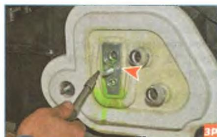
Ключом Torx T-25 отворачиваем два винта крепления редуктора.
