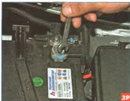
Ключом «на 10» ослабляем затяжку гайки стяжного болта клеммы проводов на «плюсовом» выводе аккумуляторной батареи...
