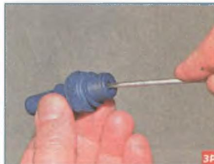
...вставляем тонкий стержень со стороны резьбовой части клапана и нажимаем на стержень.
