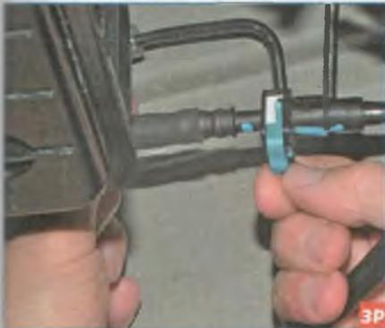
...выдвигаем стопорный элемент фиксатора наконечника трубки подачи топлива к рампе и, нажав на фиксатор...
