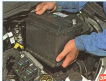
Снимаем аккумуляторную батарею (см. «Снятие аккумуляторной батареи», с. 203).
