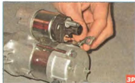
...и снимаем наконечник провода с контактного болта тягового реле.
