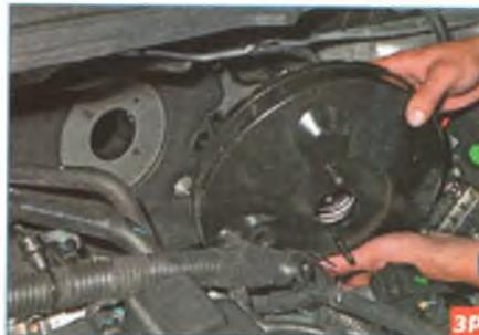
...снимаем вакуумный усилитель тормозов (см. «Снятие вакуумного усилителя тормозов», с. 186) ...
