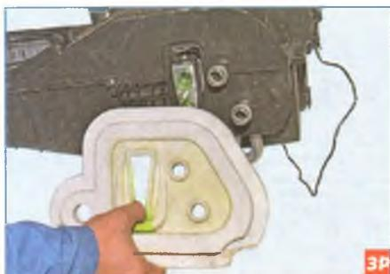
Снимаем уплотнитель трубок радиатора отопителя и редуктора.
