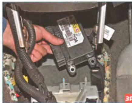
Снимаем блок со шпилек на туннеле пола.
