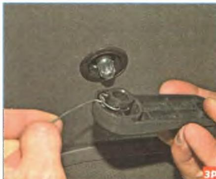
...который вставляем между ручкой и розеткой и, вытянув пружинный фиксатор, снимаем ручку с вала.
