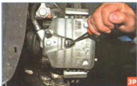
Через окно суппорта вставляем отвертку с широким лезвием между внутренней тормозной колодкой и торцом поршня.
