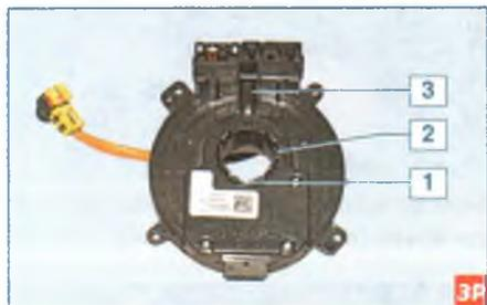
...выступ 1 датчика должен войти в широкий паз втулки барабана, выступ 2 – в узкий паз втулки, а штифт 3 – между выступами на корпусе барабанного устройства.
