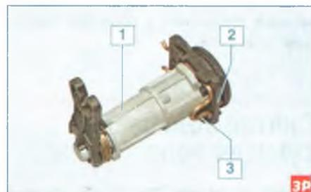
Цилиндр замка 1 крепится к наружной панели крышки багажника фиксирующей пластиной 2 и стопорной скобой 3 (для наглядности показано на снятом цилиндре).
