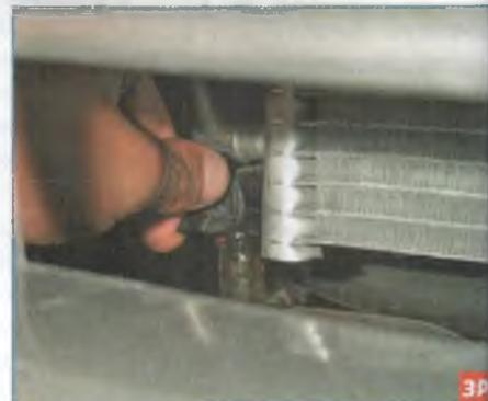
Отворачиваем на 2–3 оборота сливную пробку радиатора...
