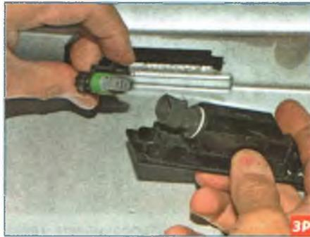
...отжав фиксатор колодки проводов, отсоединяем колодку от патрона лампы. Устанавливаем фонарь освещения номерного знака в обратной последовательности. Аналогично снимаем другой фонарь освещения номерного знака.
