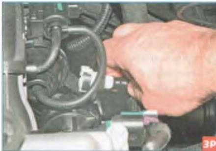
С левой стороны (по ходу движения автомобиля) впускного трубопровода нажимаем на фиксатор наконечника трубки вакуумного усилителя тормозов и отсоединяем наконечник трубки от штуцера впускного трубопровода. Снизу автомобиля демонтируем нижний кронштейн впускного трубопровода (см. «Снятие датчика детонации», с. 79) и отсоединяем от впускного трубопровода пять держателей жгута проводов. С правой стороны трубопровода головкой «на 13» отворачиваем болт крепления рыма к головке блока цилиндров...
