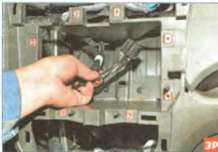
В нише размещения полки для мелких вещей заводим жгут проводов за стенку панели приборов.
