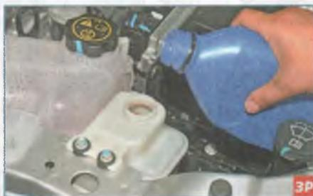
Доливаем жидкость в бачок до метки MAX.
