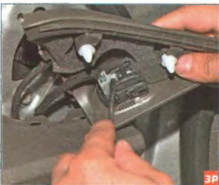
Отверткой отжимаем фиксатор колодки проводов...
