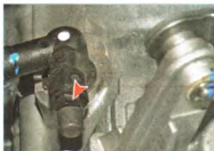
Штуцер для прокачки гидропривода сцепления
