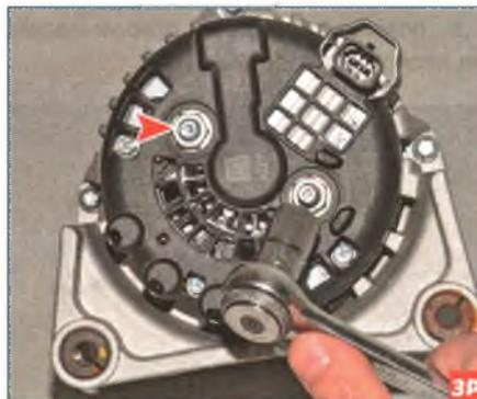
Головкой «на 13» отворачиваем две гайки...
