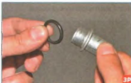
Снимаем с трубки уплотнительное кольцо.
