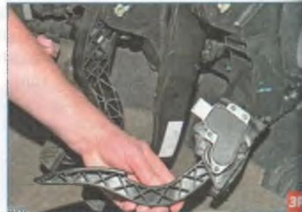
...и снимаем модуль педали «газа». При установке модуля педали «газа» вводим...
