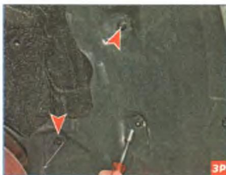
Головкой «на 10» отворачиваем три гайки крепления задней части подкрылка в арке колеса.
