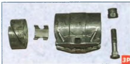
Специальный хомут для соединения трубы нового узла с трубами системы выпуска.
