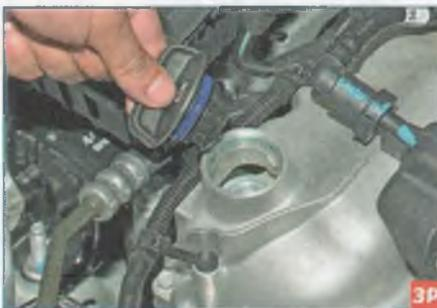
**...поворачиваем против часовой стрелки и снимаем крышку маслозаливной горловины.**
