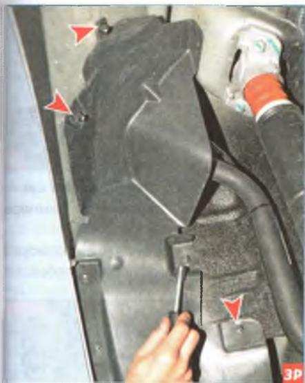
Головкой «на 10» отворачиваем четыре пластмассовые гайки крепления подкрылка в арке заднего колеса...
