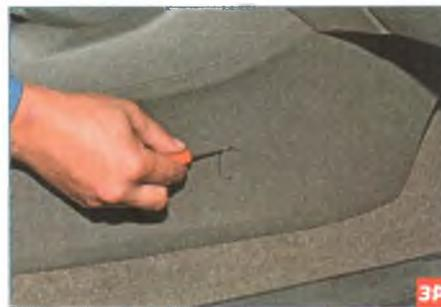
Отверткой с тонким лезвием снимаем заглушки с обеих сторон передней части облицовки туннеля пола.
