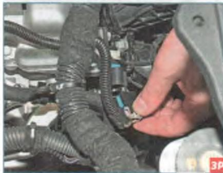
...и, нажав на фиксатор, отсоединяем колодку жгута проводов от разъема датчика.
