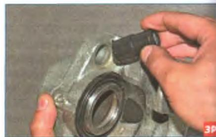
При повреждении втулки вынимаем ее из отверстия суппорта и заменяем.
