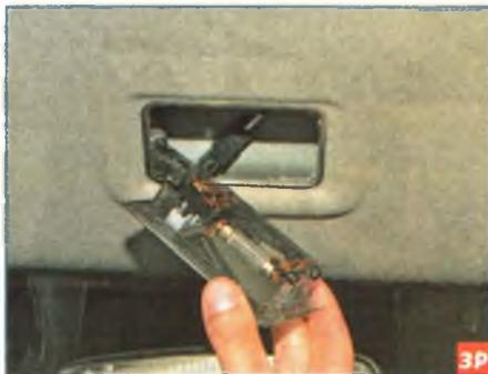
...и вынимаем плафон из обивки полки.
