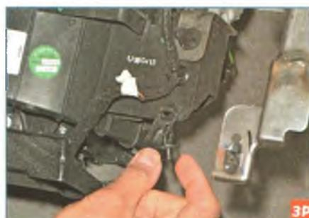
...вынимаем пистон крепления воздуховода...
