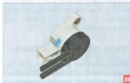
Выключатель сигналов торможения
