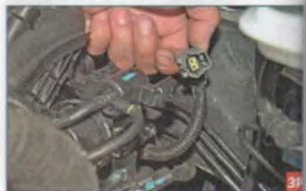
...отсоединяем колодку от разъема клапана.
