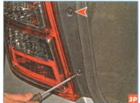
Крестообразной отверткой отворачиваем два самореза крепления фонаря.
