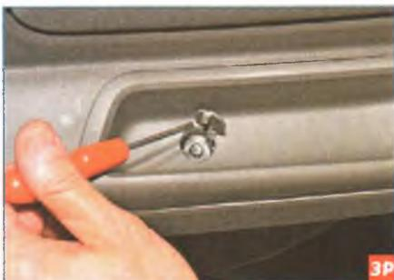
Отверткой с тонким лезвием поддеваем декоративную заглушку в нише подлокотника и откидываем ее.
