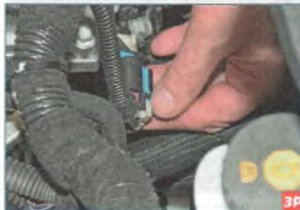
Выдвигаем стопор (серого цвета) фиксатора колодки жгута проводов системы управления двигателем...
