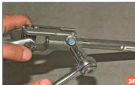
...головкой «на 11» отворачиваем болт крепления клеммного соединения вилки нижнего карданного шарнира к промежуточному валу...
