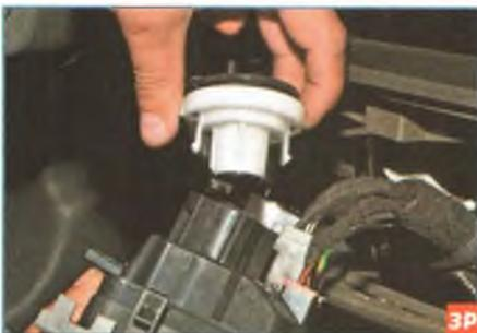
...и снимаем привод с блока управления.
