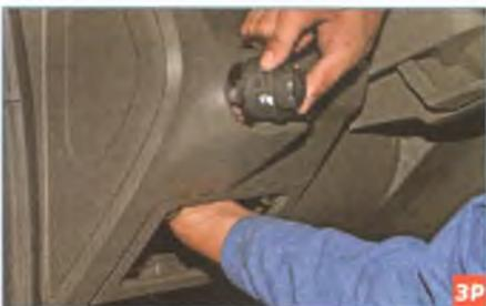
Снимаем блок выключателей и регуляторов (см. «Снятие выключателей и регуляторов», с. 222).
