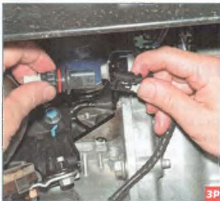
...и, нажав на фиксатор, отсоединяем колодку жгута проводов от разъема датчика.
