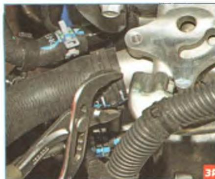
Раздвижными пассатижами сжимаем концы хомута крепления шланга подвода жидкости к радиатору системы охлаждения и, сдвинув хомут по шлангу...
