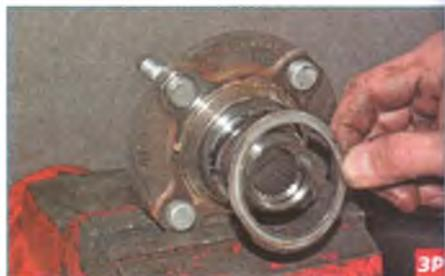
Снимаем грязезащитное кольцо подшипника.
