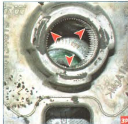
...с тремя пазами, выполненными в ступице колеса (нижний паз шире двух остальных).
