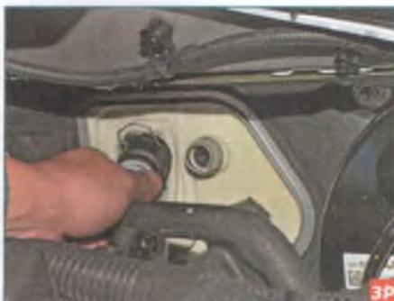
Отсоединяем шланги системы охлаждения от трубок радиатора отопителя (см. «Снятие отопителя», с. 260)...
