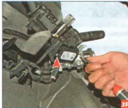
Крестообразной отверткой отворачиваем два самореза...
