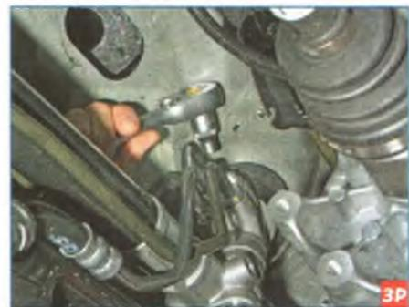
Головкой E-10 отворачиваем винт крепления фланца трубок нагнетательной и сливной магистралей к картеру рулевого механизма.
