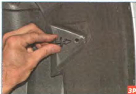
...и вынимаем пистоны из отверстий.
