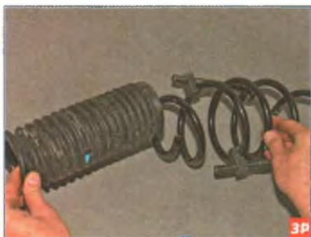
Разъединяем пружину и защитный чехол.
