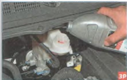
Доливаем жидкость DOT-4 в бачок до метки MAX. Заворачиваем крышку бачка.
