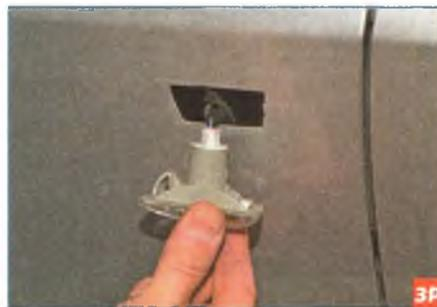
...вынимаем его из отверстия в переднем крыле.
