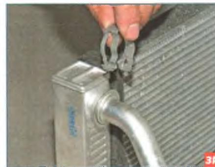
...и снимаем держатель отводящей трубки.
