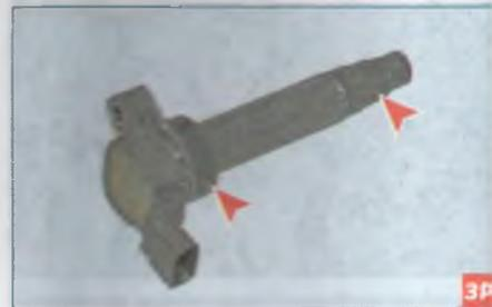
Катушка уплотняется в крышке головки блока цилиндров резиновой втулкой, а на свече зажигания – резиновым колпачком.
