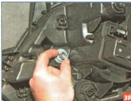
...поворачиваем патрон лампы против часовой стрелки...
