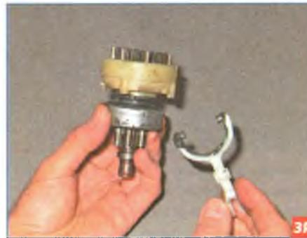
Снимаем рычаг привода.
