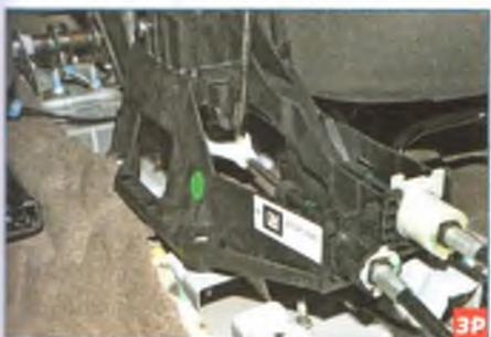
...большой отверткой нажимаем на пластмассовый наконечник троса включения передач...
