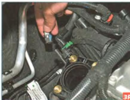
...и, нажав на фиксатор, отсоединяем колодку от разъема клапана.
