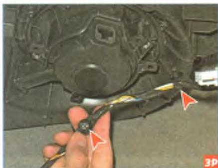
Вынимаем два держателя жгута проводов из кронштейнов снизу вентилятора.
