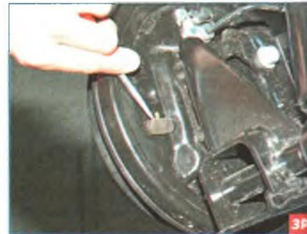
Со стороны балки задней подвески нащипте тормозного механизма шлицевой отверткой поддеваем резиновую заглушку...
