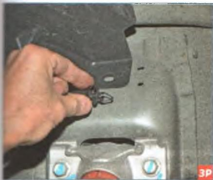
...и вынимаем пистон из отверстия кузова.
