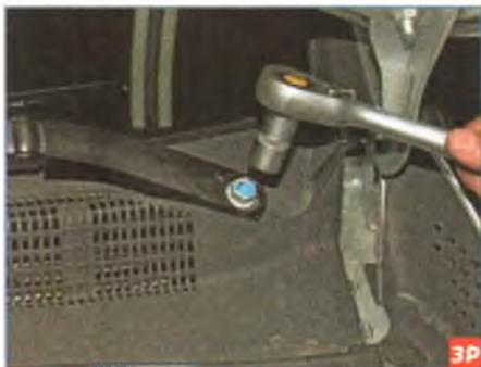
Головкой «на 15» отворачиваем гайку крепления рычага щетки.
