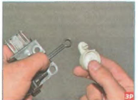
...выводим ее фиксатор из отверстия штока пневмокамеры.
