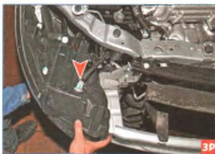
Отводим блок-фару от кузова. Сдвигаем стопор фиксатора колодки (показан на фото стрелкой) ...
