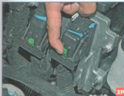
Сдвигаем вверх фиксатор скобы крепления одной из двух колодок жгута проводов системы управления двигателем...
