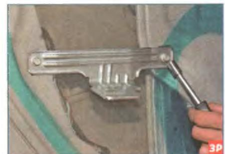
Головкой «на 10» отворачиваем два болта крепления кронштейна к внутренней панели двери...
