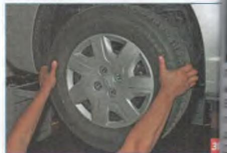
**Помощник, взявшись за колесо, качает его в горизонтальной плоскости: несколько раз поочередно резко тянет заднюю часть колеса на себя, а переднюю часть – от себя, и наоборот.** При этом, приложив руку...
