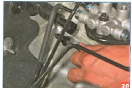
...и вынимаем наконечник трубки из отверстия дроссельного клапана. Поддев отверткой...
