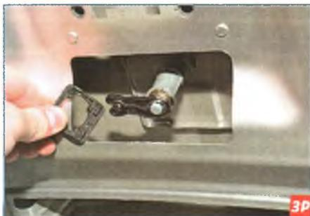
Снимаем фиксирующую пластмассовую пластину...
