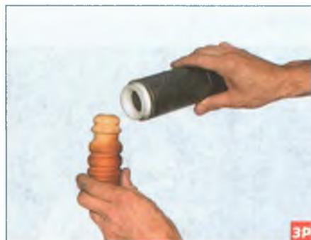
Вынимаем буфер хода сжатия из защитного чехла.
