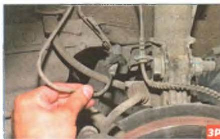
Выводим жгут проводов датчика из моторного отсека.
