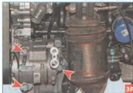
Головкой «на 13» отворачиваем три болта крепления компрессора кондиционера и, не отсоединяя от компрессора трубки (для наглядности показано на снятом двигателе)...
