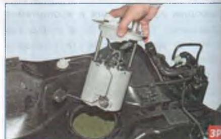
Аккуратно, чтобы не повредить поплавок датчика указателя уровня топлива, извлекаем модуль из горловины бака.
