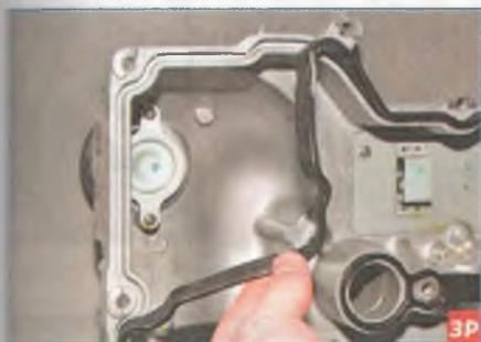
Вынимаем резиновую уплотнительную прокладку из пазов крышки.
