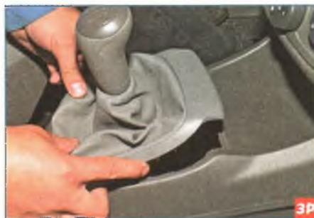
Поддеваем рамку чехла рычага переключения передач и выводим ее из зацепления с облицовкой туннеля пола.
