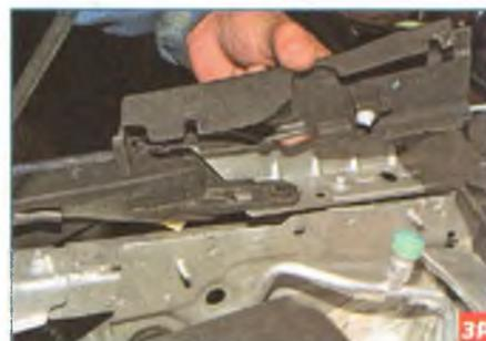
...и снимаем облицовку, преодолевая сопротивление пистона.
