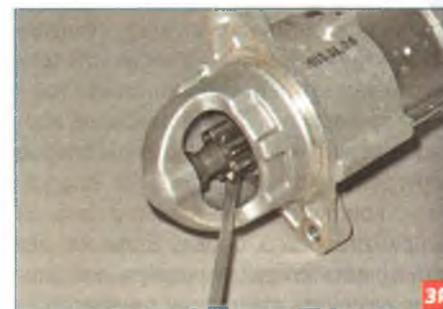
...отверткой проворачиваем шестерню привода.
