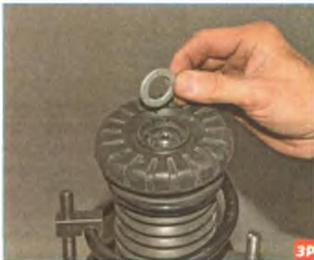
Снимаем со стойки шайбу...
