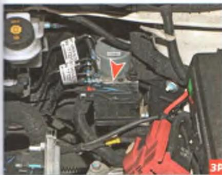
Расположение блока ABS в моторном отсеке
