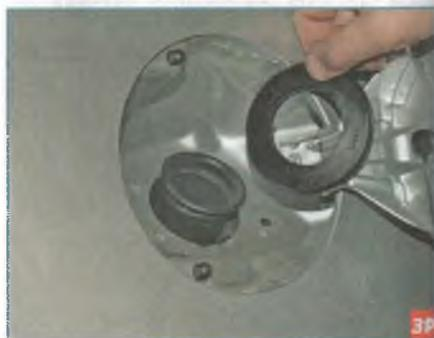
Снимаем резиновый уплотнитель с горловины наливной трубы.
