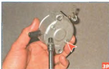
Головкой Е-6 отворачиваем два винта...
