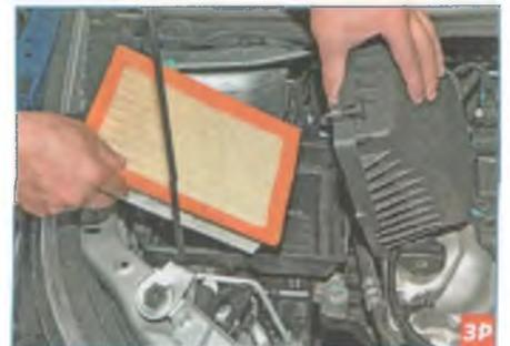
...и вынимаем сменный элемент из корпуса воздушного фильтра.
