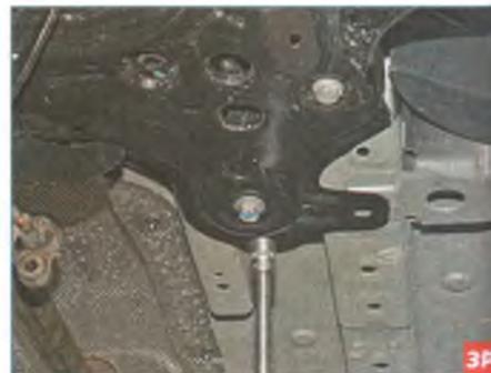
Тем же инструментом отворачиваем задний болт крепления подрамника к кронштейну кузова с левой стороны. Аналогичные операции выполняем с правой стороны автомобиля.
