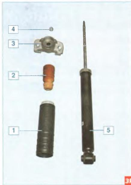
Амортизатор: 1 – защитный чехол; 2 – буфер хода сжатия; 3 – верхняя опора; 4 – гайка; 5 – амортизатор
