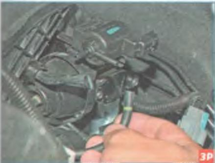
С бокового штуцера клапана снимаем шланг, соединяющий клапан с пневмокамерой механизма.
