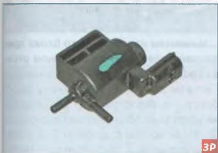
Электромагнитный клапан системы изменения геометрии каналов во впускном трубопроводе
