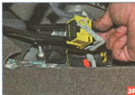
...отсоединяем колодку от блока управления подушками безопасности.
