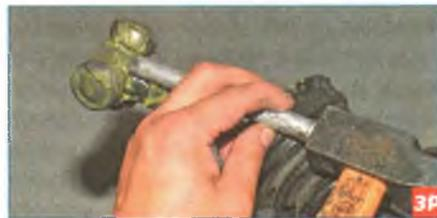
Выколоткой из мягкого металла сбиваем трехшариковик со шлицов вала, нанося удары по торцу ступицы трехшариковика и при этом перемещая выколотку по окружности.
