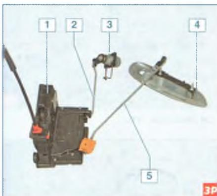
Замок водительской двери: 1 – замок двери с электроприводом; 2 – тяга цилиндра замка; 3 – цилиндр замка; 4 – наружная ручка; 5 – тяга наружной ручки
