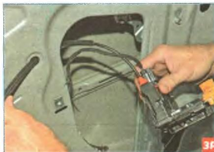
...и сдвигаем замок с тросом внутренней ручки к технологическому отверстию во внутренней панели двери.
