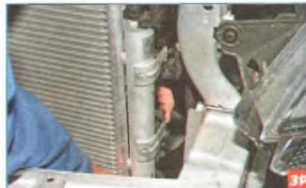
Нажимаем на фиксатор нижнего держателя конденсатора на левом бачке радиатора и приподнимаем левую сторону конденсатора, выводя его кронштейны из нижнего и верхнего держателей.
