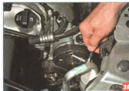
Шестигранником «на 8» отворачиваем три винта крепления насоса к кронштейну блока цилиндров...
