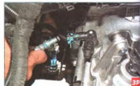
Отсоединяем шланг гидропривода сцепления от переходника трубки подвода жидкости к рабочему цилиндру гидропривода сцепления (см. «Замена трубки со шлангом гидропривода сцепления», с. 128).
