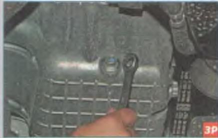
Накидным ключом «на 15» ослабляем затяжку пробки сливного отверстия.
