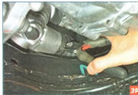
Бокорезами перекусываем замок большого хомута крепления чехла...
