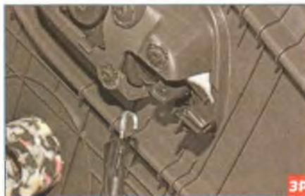
Выводим крючок троса из отверстия рычага ручки...
