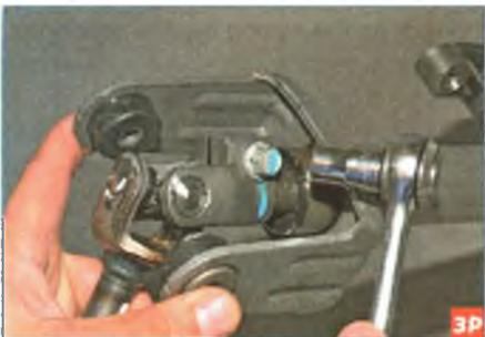
Головкой «на 11» отворачиваем болт крепления клеммного соединения вилки верхнего карданного шарнира промежуточного вала с валом рулевого
