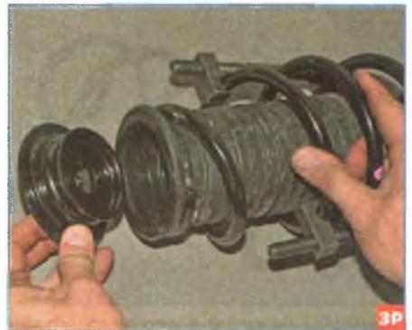
С верхней стороны пружины снимаем чашку верхней опоры.
