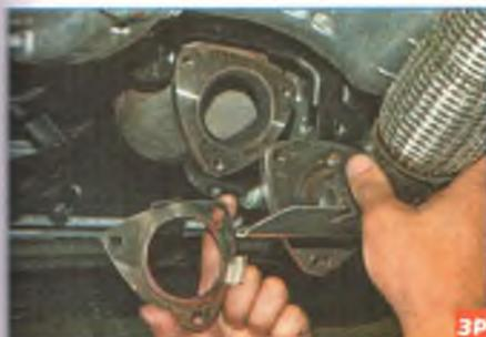
Снимаем уплотнительную прокладку.
