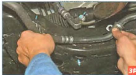
...и отводим шланг от подрамника. Устанавливаем регулируемый упор под подрамник.
