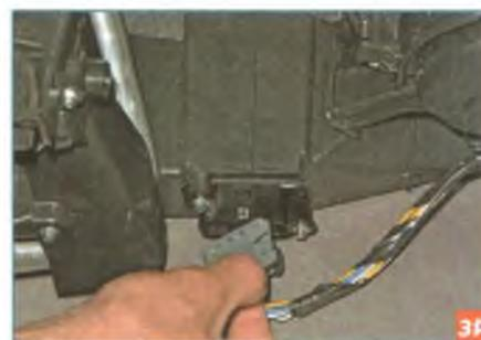
Отжав фиксатор колодки проводов, отсоединяем колодку от разъема резистора вентилятора.
