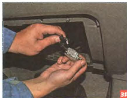
Отсоединяем колодку проводов от плафона освещения вещевого ящика.
