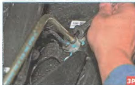
Ключом «на 10» отворачиваем штуцер прокачки на 1/2–3/4 оборота.
