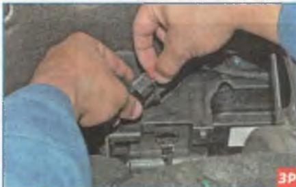
Выдвигаем стопор (красного цвета) фиксатора колодки жгута проводов и, нажав на фиксатор, отсоединяем колодку от разъема датчика положения педали сцепления.
