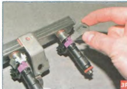
...и снимаем запорную скобу форсунки.
