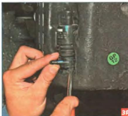
Отверткой выдвигаем насос из уплотнительной втулки...
