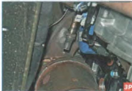
...и выворачиваем датчик из резьбового отверстия выпускного коллектора.
