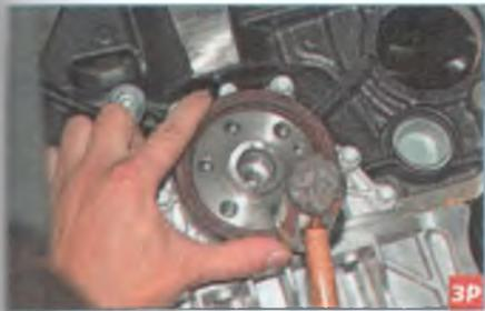
...и запрессовываем его в гнездо пышки с помощью старого сальника или подходящей оправки.
