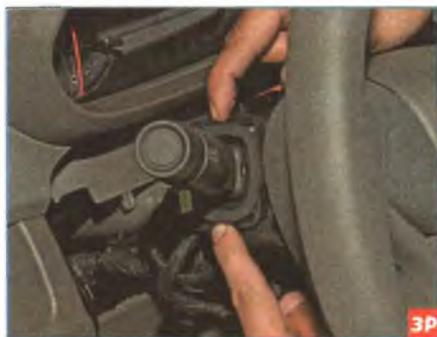
Сжимаем пальцами два фиксатора сверху и снизу переключателя...
