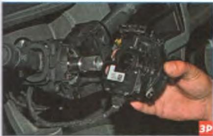
Снимаем с рулевой колонки барабанное устройство в сборе с датчиком угла поворота рулевого колеса.
