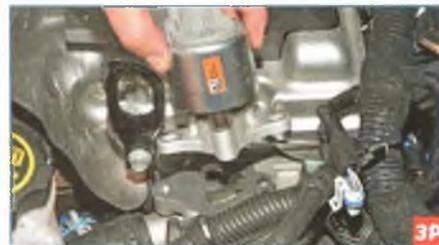
Снимаем клапан рециркуляции...
