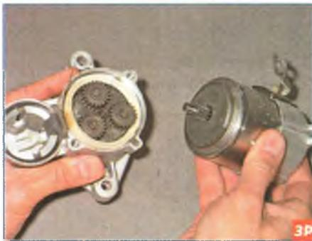
Разъединяем переднюю крышку и корпус стартера.
