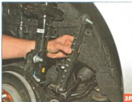
**Снимаем стойку стабилизатора поперечной устойчивости.**
