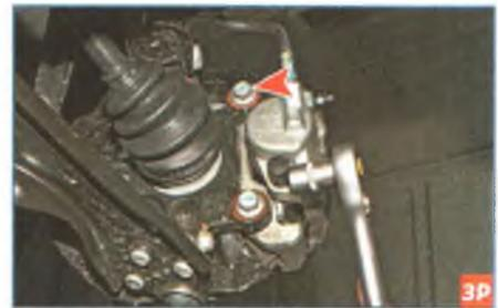
Головкой «на 18» отворачиваем два болта крепления направляющей колодок к поворотному кулаку...
