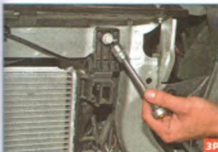
С левой стороны головкой «на 13» отворачиваем болт крепления кронштейна от верхней опоры радиатора...
