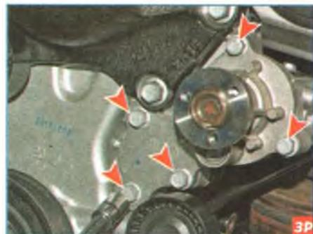
Головкой «на 13» отворачиваем пять болтов крепления насоса к передней крышке блока цилиндров...
