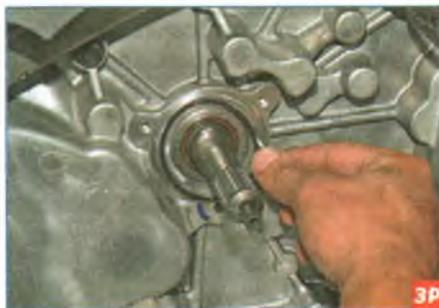
Поддев тонкой отверткой уплотнительное кольцо, вынимаем его из канавки на торце картера сцепления.
