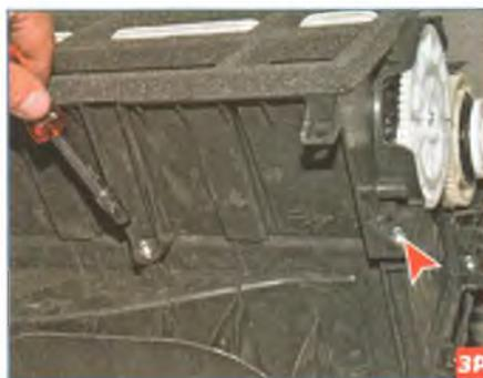
...и два самореза спереди отопителя.
