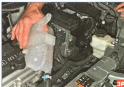
...отводим расширительный бачок системы охлаждения от бачка гидроусилителя рулевого управления (см. «Снятие расширительного бачка», с. 114).
