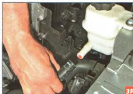
...и снимаем шланг с патрубка бачка.
