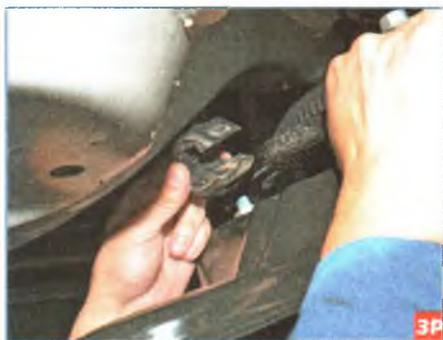
Снимаем подушку со штанги. Устанавливаем подушки в обратной последовательности, при этом...
