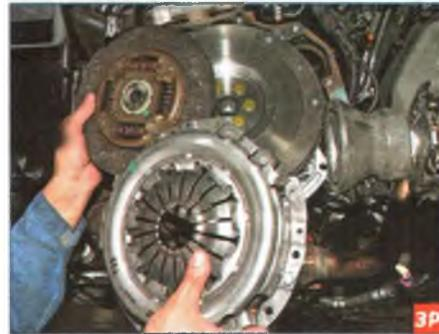
Снимаем «корзину» и ведомый диск сцепления.
