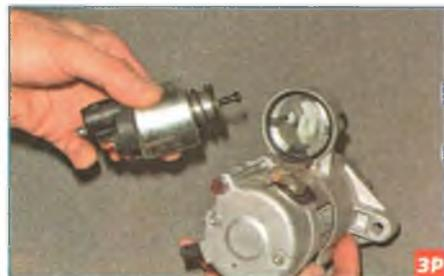
Снимаем тяговое реле, выводя шток якоря из прорези рычага привода.
