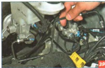
...и снимаем трубки.
