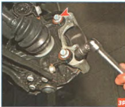
Головкой «на 18» отворачиваем два болта крепления направляющей колодок к поворотному кулаку...
