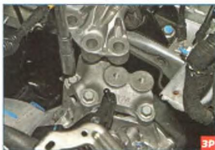
Тем же инструментом отворачиваем три болта крепления кронштейна левой опоры силового агрегата к картеру коробки передач...
