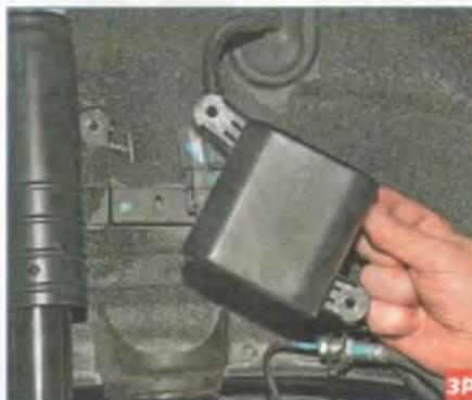
Снимаем кожух со шпилек кузова.
