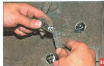
Нажав на фиксаторы колодки жгута проводов кузова, отсоединяем ее от колодки жгута проводов датчика.
