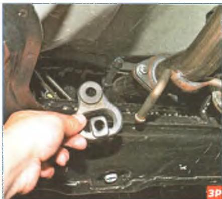
Отсоединяем резиновые подушки подвески трубы дополнительного глушителя от кронштейнов подрамника (см. «Замена подушек подвески системы выпуска отработавших газов», с. 117).
