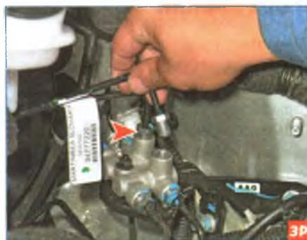
Выводим концы трубок из отверстий в блоке регуляторов...
