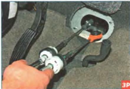
Выводим тросы управления коробкой передач в салон автомобиля через отверстие в щитке передка.
