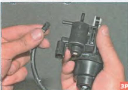
Отсоединяем от штуцера клапана шланг, соединяющий пневмокамеру с клапаном.
