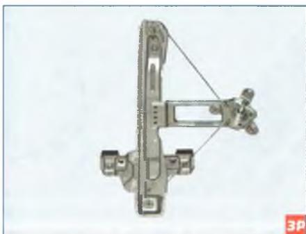
Механизм стеклоподъемника левой задней двери.
