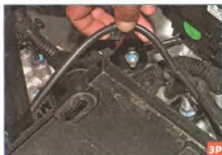
Вынимаем из отверстий площадки аккумуляторной батареи пластмассовые держатели провода «массы».
