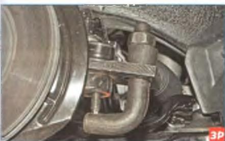
Выпрессовываем палец шарнира наконечника рулевой тяги с помощью съемника.
