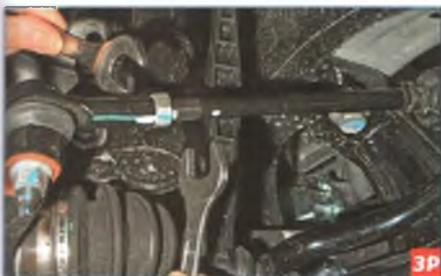
Ключом «на 21» ослабляем затяжку контргайки, удерживая наконечник за грани ключом «на 19».
