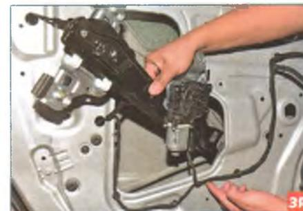
Сдвинув стеклоподъемник к технологическому отверстию во внутренней панели двери...
