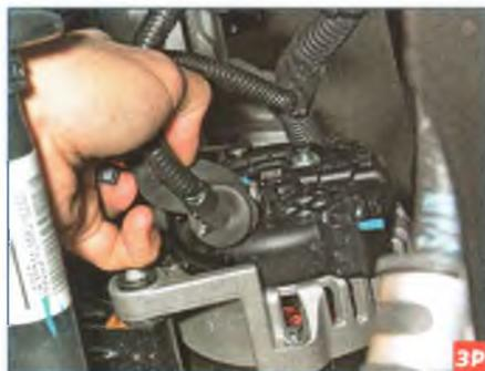
Снимаем резиновый защитный колпак с вывода генератора.
