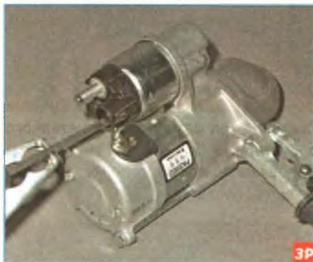
...«плюсовой» вывод аккумуляторной батареи с управляющим выводом тягового реле, а «минусовой» вывод – с корпусом стартера.
