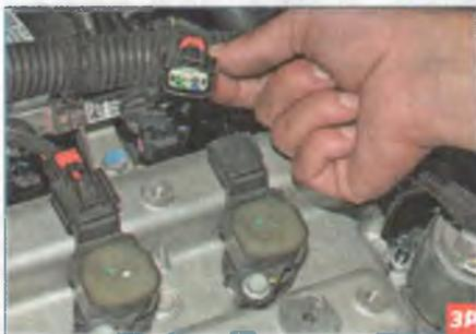
...и, нажав на фиксатор, отсоединяем колодку от катушки зажигания.
