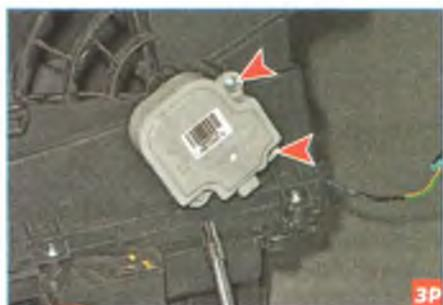
Головкой «на 5,5» отворачиваем три самореза...
