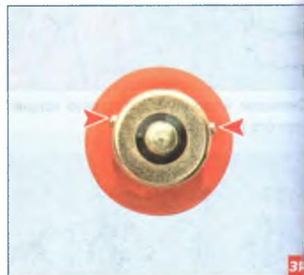
...два выступа, расположенные несимметрично относительно оси лампы, должны войти в соответствующие пазы патрона.
