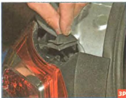
Снимаем резиновый уплотнитель с корпуса фонаря.
