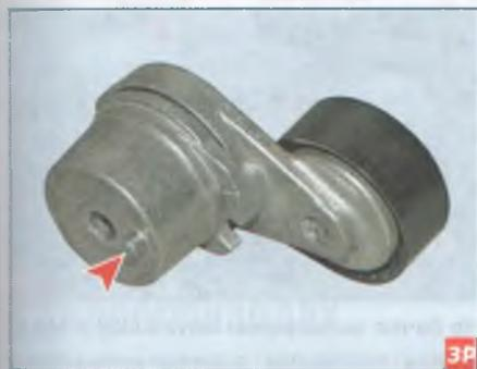
...выступ на корпусе натяжного устройства...
