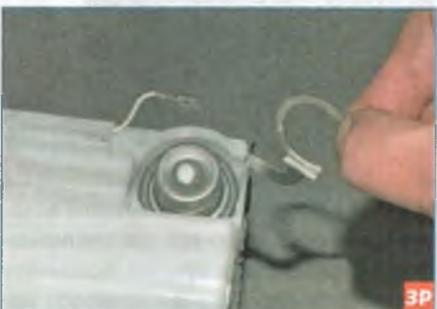
Снимаем контактное кольцо регулятора.
