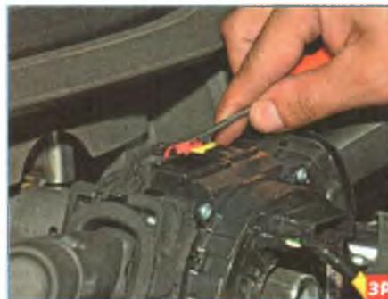
Отверткой поддеваем стопор фиксатора колодки проводов...
