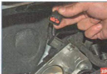
...и, нажав на фиксатор, отсоединяем колодку от разъема блока управления дроссельной заслонкой.
