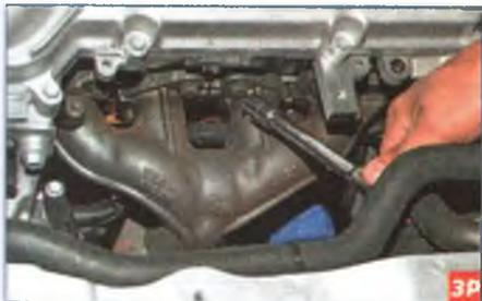
Головкой «на 13» отворачиваем девять болтов крепления выпускного коллектора к головке блока цилиндров.
