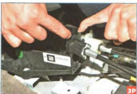
Разжимаем фиксирующие лепестки наконечника оболочки троса включения передач...
