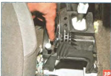
...и снимаем его с шарового пальца рычага выбора передач.
