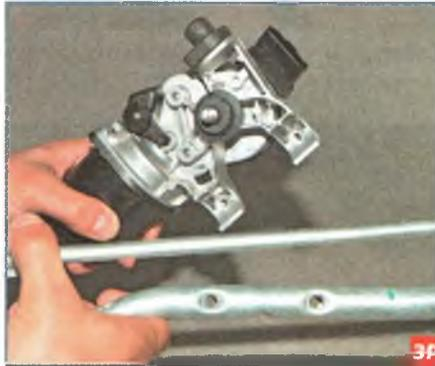
Снимаем мотор-редуктор с кронштейна.
