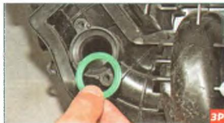
Вынимаем из отверстия во впускном трубопроводе резиновую уплотнительную прокладку наконечника трубки.
