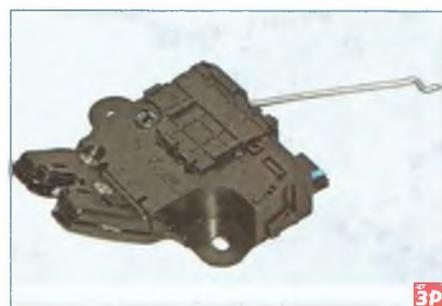
Замок в сборе с тягой цилиндра замка.
