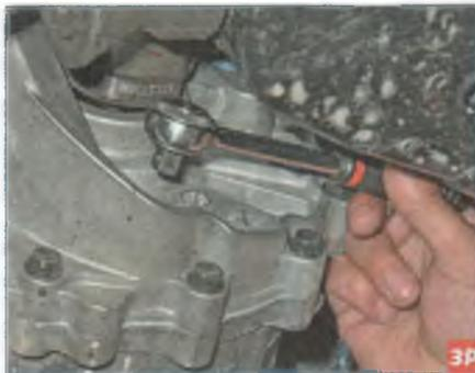
Квадратом «на 9,5» отворачиваем пробку сливного отверстия.
