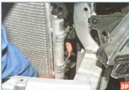
Нажимаем на фиксатор нижнего держателя и, приподняв конденсатор, выводим кронштейны конденсатора из держателей на радиаторе с левой стороны.
