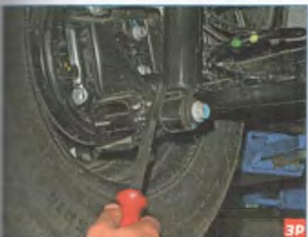
Монтажной лопаткой пытаемся сдвинуть нижнюю проушину заднего амортизатора.
