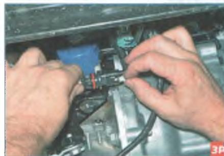
Выдвигаем фиксатор (белого цвета) колодки жгута проводов системы управления двигателем...
