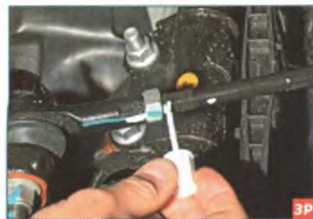
Перед отворачиванием наконечника краской помечаем его положение относительно рулевой тяги...
