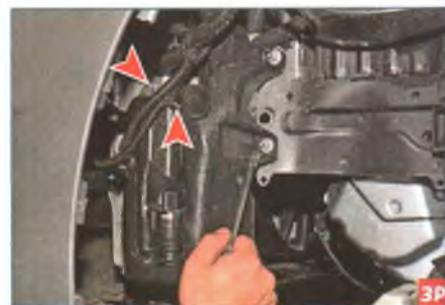
Головкой «на 10» отворачиваем три гайки крепления бачка (стрелками показаны держатель жгута проводов и кронштейн бачка).
