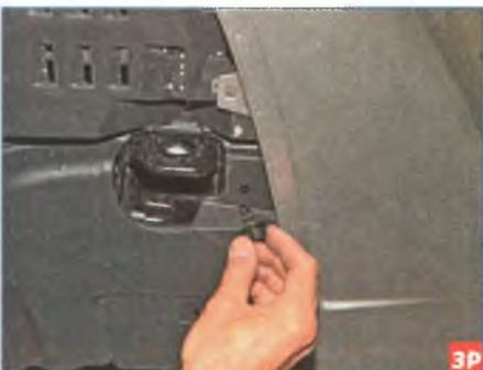
Поддеваем фиксатор и вынимаем пистон нижнего крепления правого щитка.
