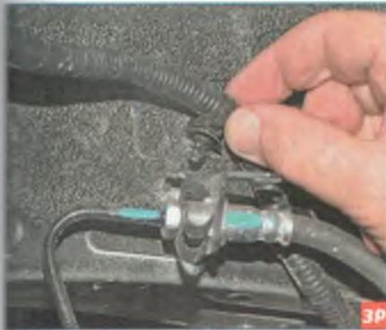
Выводим из отверстия в кронштейне тормозной трубки и двух отверстий в кузове держатели жгута проводов топливного бака.
