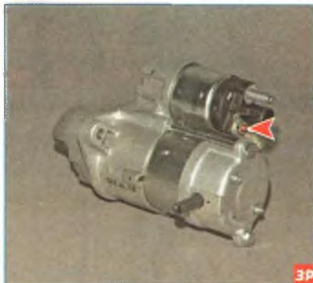
...соединяем проводами для «прикуривания» «плюсовой» вывод аккумуляторной батареи с нижним контактным болтом тягового реле (показан стрелкой), а «минусовой» вывод – с корпусом стартера.
