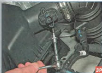
Ключом Torx T-20 отворачиваем два винта крепления датчика...
