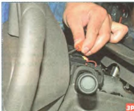
...отверткой отжимаем пружинный фиксатор подушки.
