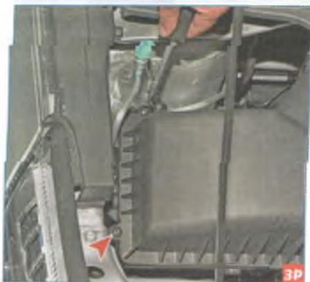
Ключом Torx T-25 отворачиваем два самореза крепления крышки фильтра.
