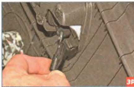
Освободив фиксатор, выводим наконечник оболочки троса внутренней ручки из паза основания ручки.
