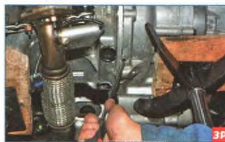
Вставляем отвертку в нижнее отверстие картера сцепления и отжимаем фланец картера сцепления от поддона картера двигателя так, чтобы образовалась небольшая щель.
