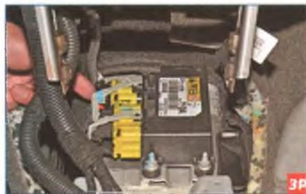
...поворачиваем фиксатор колодки проводов...
