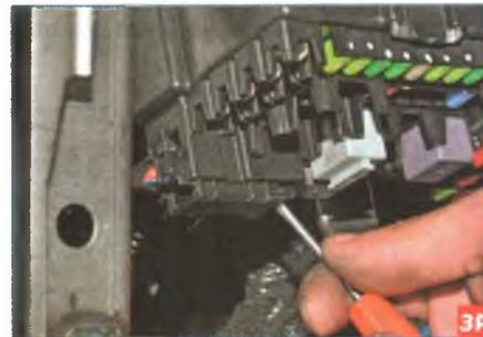
Отверткой поддеваем колодку проводов...
