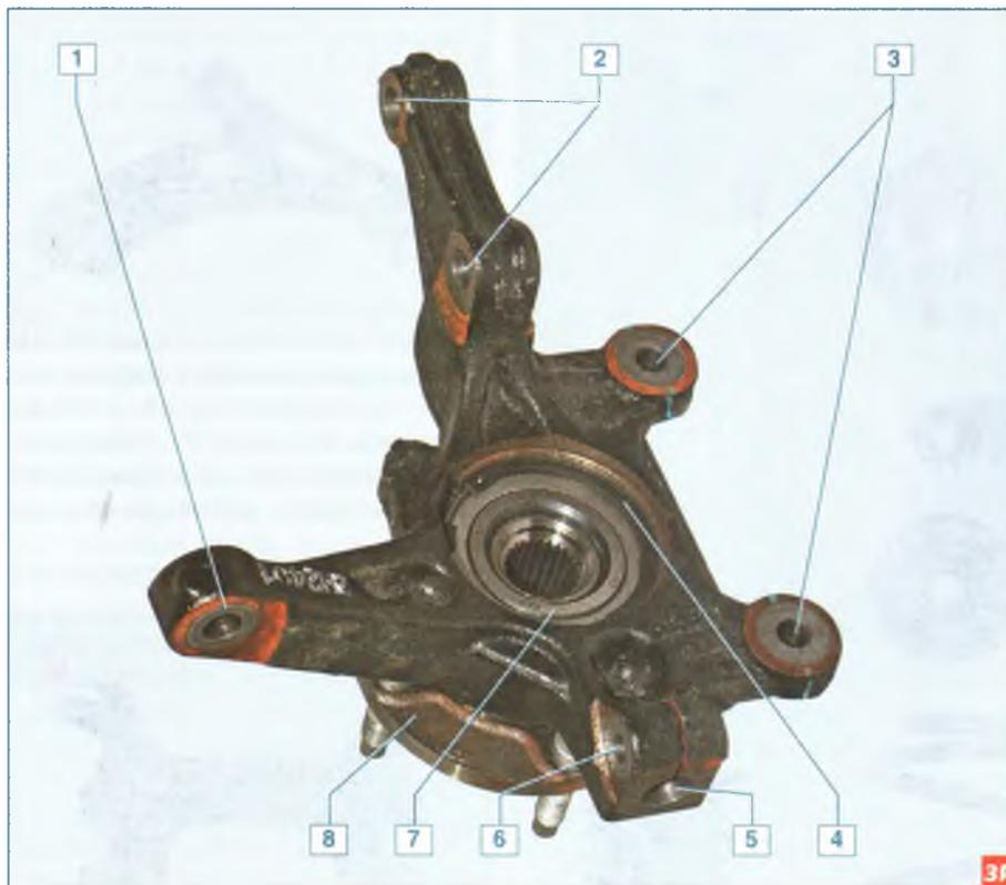
**Поворотный кулак в сборе с подшипником и ступицей:** 1 – отверстие для крепления наконечника рулевой тяги; 2 – отверстия для крепления к кронштейну амортизаторной стойки; 3 – отверстия для крепления направляющей тормозных колодок; 4 – стопорное кольцо; 5 – отверстие для крепления пальца шаровой опоры; 6 – отверстие под стяжной болт; 7 – подшипник ступицы; 8 – ступица
