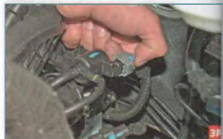
Нажав на фиксатор колодки жгута проводов системы управления двигателем...
