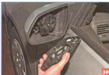
...выводим элемент из корпуса зеркала.
