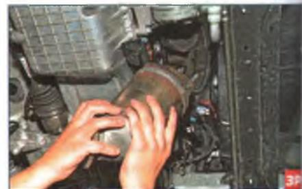
Снимаем каталитический нейтрализатор (см. «Снятие каталитического нейтрализатора», с. 119).
