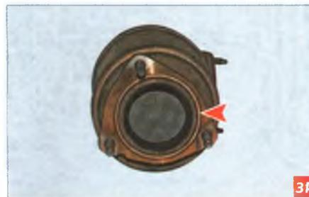
Уплотнительная прокладка в соединении фланцев выпускного коллектора и каталитического нейтрализатора
