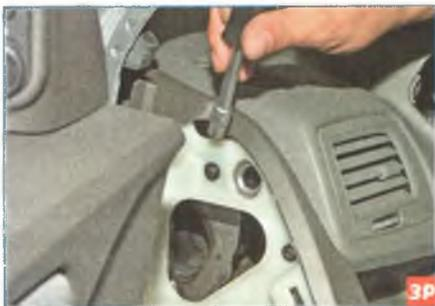
Головкой «на 7» отворачиваем саморез бокового крепления панели приборов.
