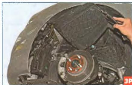
...отгибаем переднюю часть подкрылка и заводим ее за тормозной механизм.
