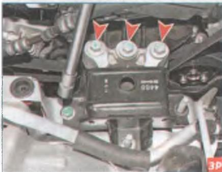
Головкой «на 15» отворачиваем четыре болта...
