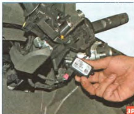
...снимаем с соединителя блок управления иммобилайзером...
