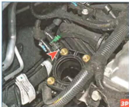
Расположение клапана продувки адсорбера на впускном трубопроводе.
