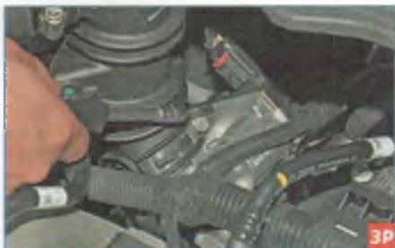
Головкой «на 8» ослабляем затяжку хомута крепления шланга подвода воздуха к дроссельному узлу. Снимаем шланг с патрубка дроссельного узла...
