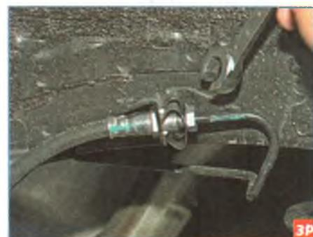
Специальным ключом «на 13» для штуцеров тормозных трубок отворачиваем штуцер крепления тормозной трубки (проходящей под днищем автомобиля) к верхнему наконечнику шланга.
