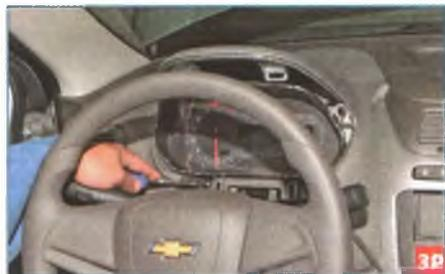
Крестообразной отверткой отворачиваем четыре самореза крепления комбинации приборов.
