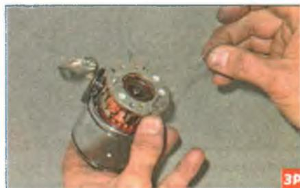
...и вынимаем отрезки проволоки. Под действием пружин щетки выдвигаются к коллектору. Дальнейшую сборку стартера выполняем в обратной последовательности. Смазываем шестерни планетарного редуктора смазкой ШРУС-4.
