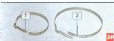
Универсальные хомуты для крепления чехла ШРУСа: 1 – хомут крепления чехла на на валу привода; 2 – хомут крепления чехла на корпусе шарнира
