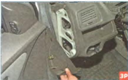
...снимаем левую боковую облицовку панели приборов.
