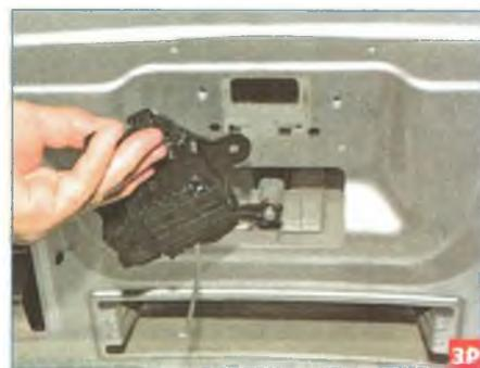
...и снимаем замок.
