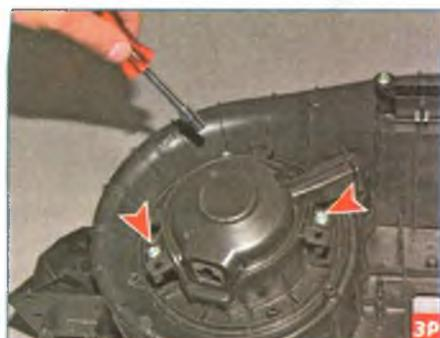
Головкой «на 5,5» отворачиваем три самореза...
