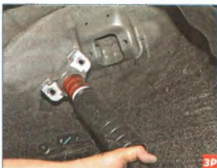
Отводим верхнюю опору амортизатора от кузова...
