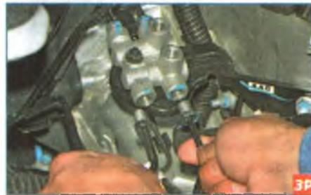
...и выводим концы трубок из отверстий в блоке.
