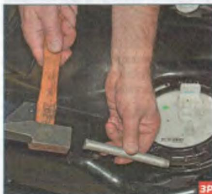
Уперев в один из пазов прижимного кольца крышки модуля стержень из мягкого металла, наносим по нему удары, поворачивая кольцо против часовой стрелки.
