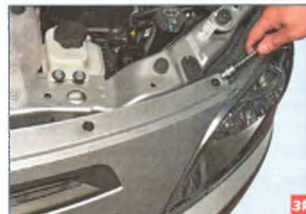
Головкой «на 7» отворачиваем шесть саморезов крепления облицовки радиатора к кронштейну бампера.
