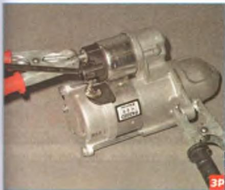
Отверткой переключаем верхний контактный болт и управляющий вывод тягового реле.
