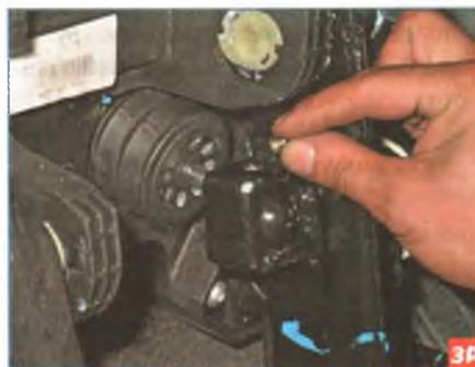
...то через верхнее отверстие в корпусе шарнира устанавливаем на фиксатор упор подходящего размера (например, болт)...
