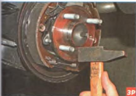
Молотком выбиваем поврежденную шпильку из ступицы.
