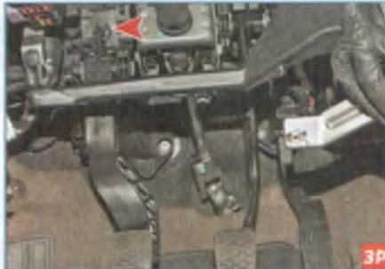
Расположение датчика на кронштейне pedalного узла.
