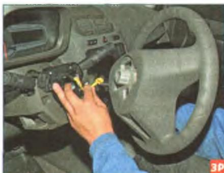
Снимаем рулевое колесо с вала, осторожно выводя колодку со жгутом проводов подушки безопасности водителя через отверстие в ступице рулевого колеса.
