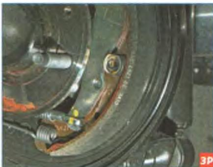
Положение рычага привода стояночного тормоза при снятии барабана. Металлической щеткой очищаем от загрязнений головку винта крепления барабана.
