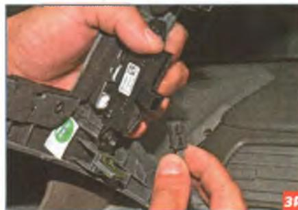
...отсоединяем колодку от выключателя центрального замка...
