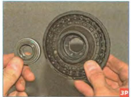
Вынимаем из верхней опоры упорный подшипник.
