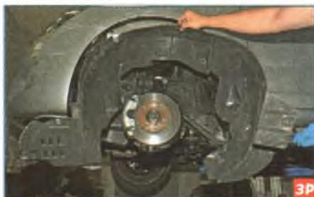
...и снимаем подкрылок левого переднего колеса.
