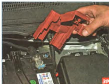
Снимаем крышку блока силовых предохранителей.
