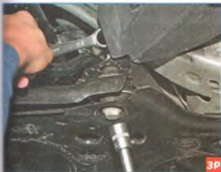
Головкой «на 21» отворачиваем болт крепления заднего сайлент-блока рычага к подрамнику, удерживая от проворачивания гайку ключом того же размера...
