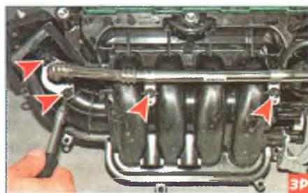
Ключом Torx T-30 отворачиваем четыре самореза крепления к трубопроводу трубки системы рециркуляции отработавших газов...
