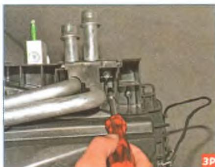
Головкой «на 5,5» отворачиваем саморез крепления крышки трубок радиатора.
