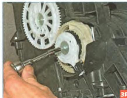
...головкой «на 5,5» отворачиваем саморез крепления привода...
