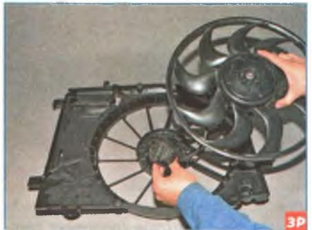
...и снимаем с кожуха электродвигатель с крыльчаткой.
