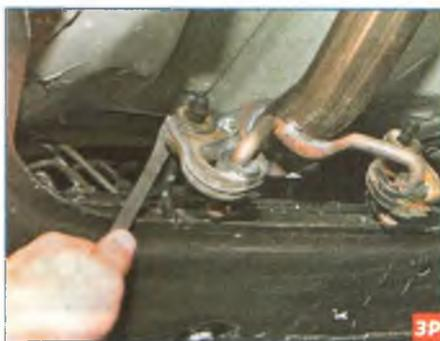
Оперев отвертку на буртик кронштейна подрамника...
