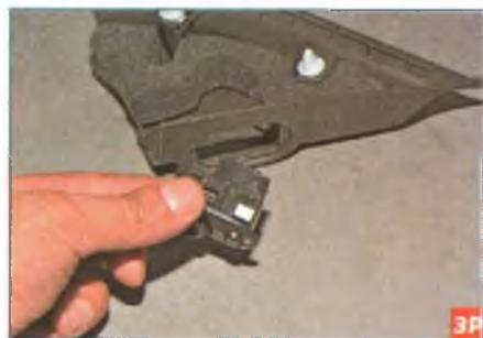
Вынимаем регулятор из накладки, преодолевая сопротивление фиксаторов. Устанавливаем регулятор управления наружными зеркалами в обратной последовательности.
