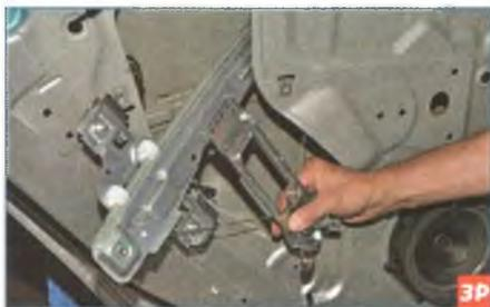
Вынимаем механизм стеклоподъемника через технологическое отверстие во внутренней панели двери.
