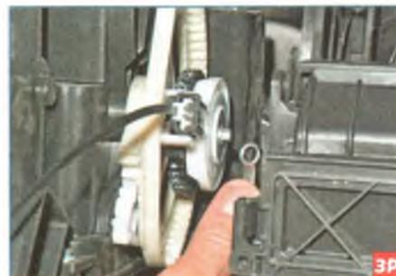
Ключом «на 5,5» отворачиваем саморез крепления привода заслонки регулятора температуры...
