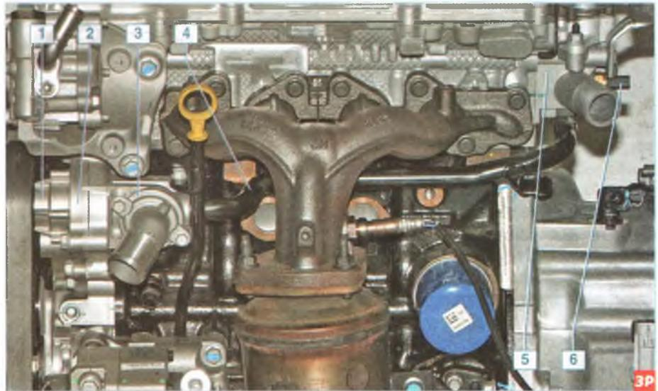
Элементы системы охлаждения (для наглядности показано на демонтированном силовом агрегате): 1 – насос охлаждающей жидкости; 2 – передняя крышка блока цилиндров; 3 – корпус термостата; 4 – трубка подвода жидкости к насосу; 5 – выпускной патрубок системы охлаждения; 6 – датчик температуры охлаждающей жидкости
