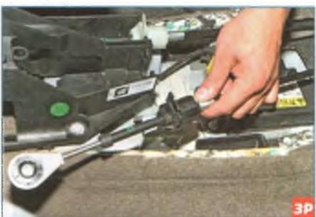
...и вынимаем трос включения передач из корпуса механизма управления коробкой передач.
