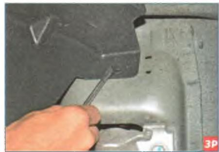
Шлицевой отверткой поддеваем фиксатор пистона верхнего крепления подкрылка к кузову...
