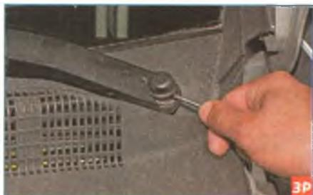
Отверткой поддеваем защитный колпачок...
