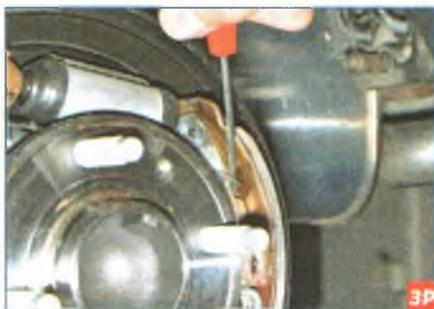
Поддев шлицевой отверткой, выводим из зацепления с задней колодкой крю-
