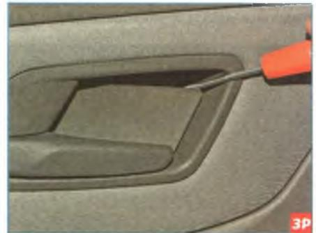
Отверткой с тонким лезвием поддеваем декоративную заглушку и, преодолев сопротивление трех фиксаторов...
