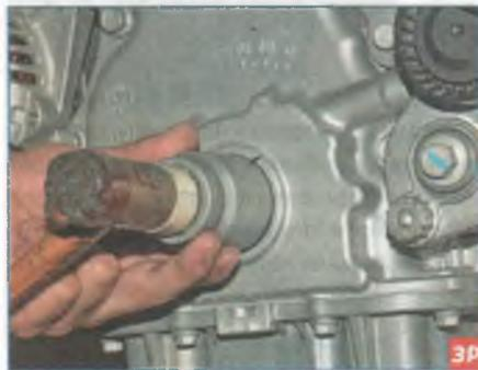
Запрессовываем сальник в гнездо крышки блока цилиндров с помощью инструментальной головки или отрезка трубы подходящего размера.
