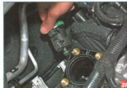
Преодолевая сопротивление резинового уплотнительного кольца, вынимаем выходной штуцер клапана из отверстия во впускном трубопроводе.
