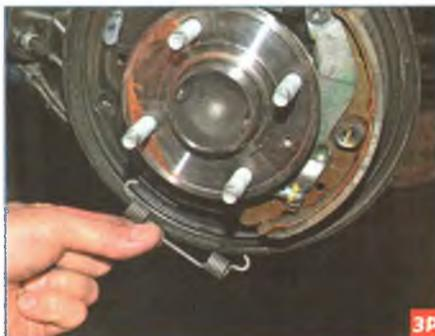
...и снимаем пружину. Снимаем опорную стойку задней тормозной колодки.
