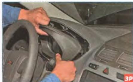
Отводим облицовку комбинации от панели приборов, преодолевая сопротивление фиксаторов...
