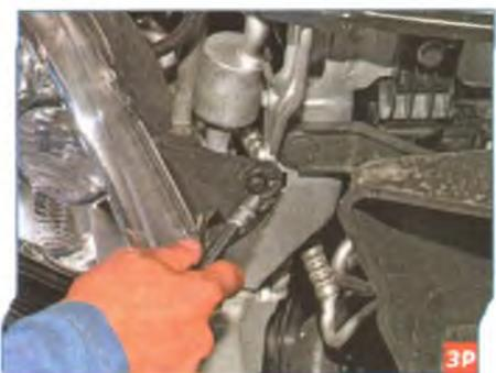
...и саморез переднего крепления блок-фары.
