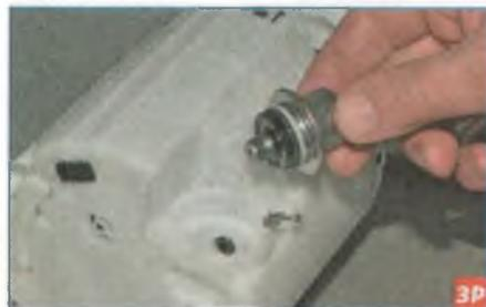
...вынимаем регулятор из гнезда в корпусе топливного модуля.
