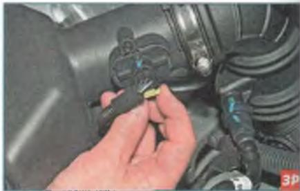
Выдвигаем стопор (желтого цвета) фиксатора колодки жгута проводов системы управления двигателем...
