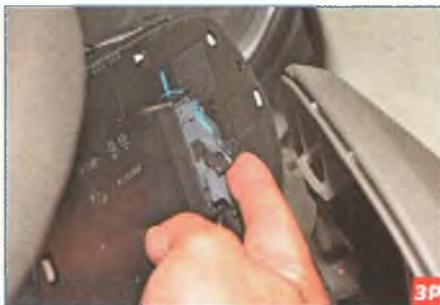
...поворачиваем фиксатор колодки проводов...
