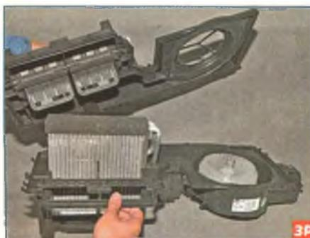
...и снимаем среднюю часть корпуса отопителя.
