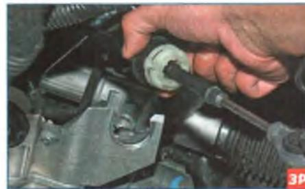
...и вынимаем наконечник оболочки троса из кронштейна движением вверх.
