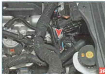
Расположение на двигателе датчика распределительного вала впускных клапанов.
