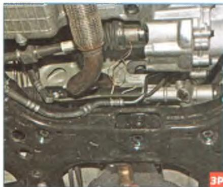
...и подвязываем рулевой механизм к промежуточной трубе системы выпуска отработавших газов.
