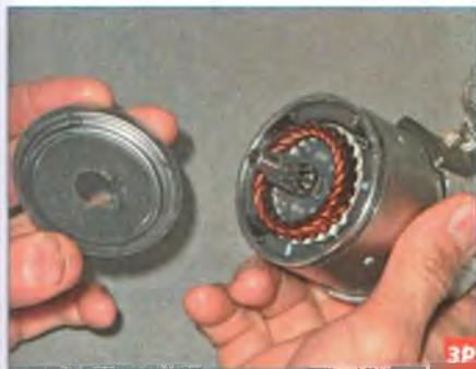
Снимаем крышку электродвигателя с корпуса стартера.
