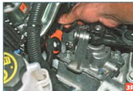
...снимаем наконечник троса выбора передач с шарового пальца рычага.
