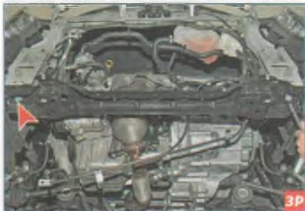
Головкой «на 15» отворачиваем два болта крепления нижней поперечины рамки радиатора к лонжеронам...
