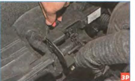
...отсоединяем колодку жгута проводов от датчика положения педали сцепления (см. «Снятие датчика положения педали сцепления», с. 81).
