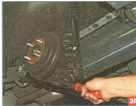
Вставляем монтажную лопатку в полость левого рычага балки, приспускаем рычаг на регулируемом упоре и отжимаем рычаг вниз с помощью монтажной лопатки.
