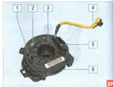
**Барабанное устройство со спиральным кабелем:** 1 – поводок; 2 – окно; 3 – барабан; 4 – колодка проводов подушки безопасности; 5 – электрический разъем; 6 – корпус устройства
