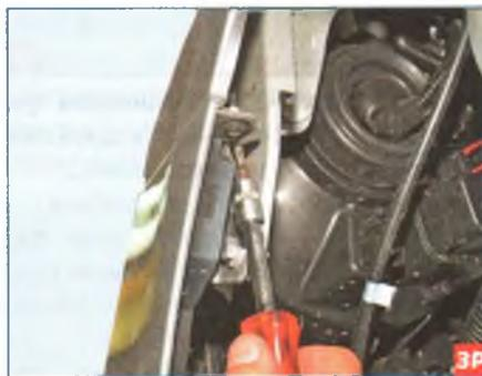
Ключом Torx T-20 отворачиваем саморез крепления переднего бампера к левому переднему крылу.
