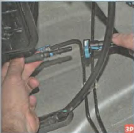
...снимаем наконечник с трубки топливной магистрали на днище автомобиля.
