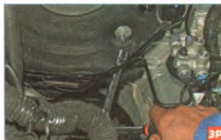
...головкой «на 13» отворачиваем четыре гайки крепления педального узла к щитку передка.
