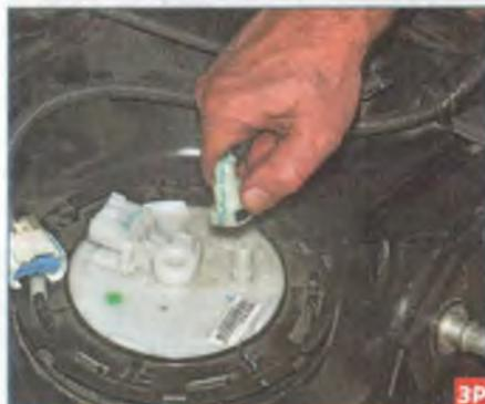
Нажав на фиксатор наконечника трубки подачи топлива к рампе, снимаем наконечник со штуцера крышки топливного модуля.
