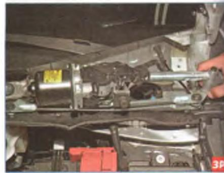
Поворачиваем очиститель так, чтобы получить доступ к колодке проводов.
