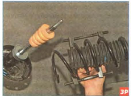
Снимаем со стойки пружину с защитным чехлом и чашкой верхней опоры.
