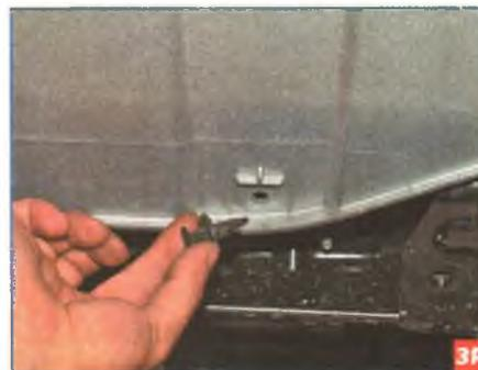
...и вынимаем пистоны из отверстий рамки.
