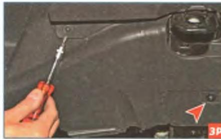
Ключом Torx T-20 отворачиваем два самореза нижнего крепления щитка.
