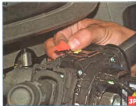
...и вынимаем стопор из колодки.
