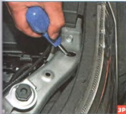
Поворачивая крестообразной отверткой регулятор, расположенный ближе к крылу автомобиля, изменяем положение светового пучка в горизонтальной плоскости.
