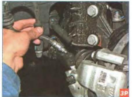
...и снимаем шланг тормозного механизма переднего колеса.
