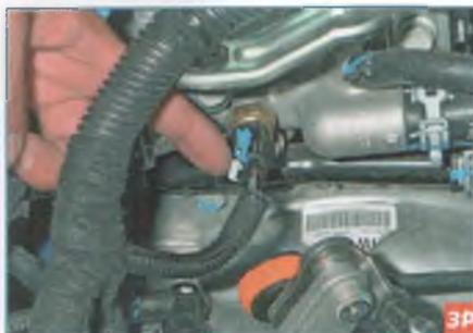
Выдвигаем фиксатор (белого цвета) колодки жгута проводов системы управления двигателем, и нажав на фиксатор...
