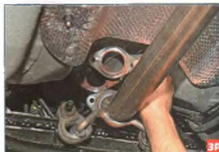
Снимаем со шпилек фланца промежуточной трубы уплотнительную прокладку.
