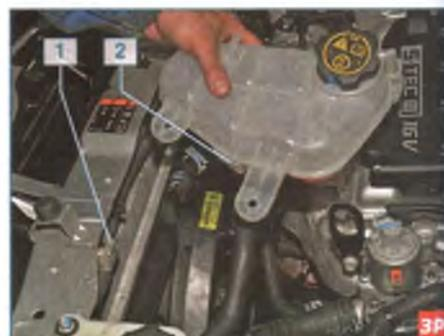
Тянем бачок вверх, снимая кронштейн 2 бачка с выступа 1 верхней поперечины рамки радиатора.
