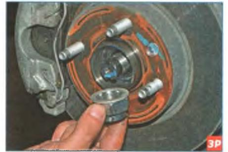
...и отворачиваем гайку крепления подшипника ступицы колеса.
