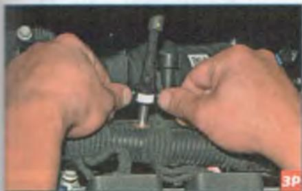
Сдвигаем стопорный элемент фиксатора наконечника трубки подвода топлива к рампе...
