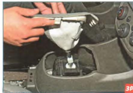
Сдвигаем рамку с чехлом по рычагу переключения передач.
