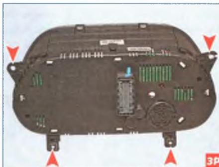
Места крепления комбинации приборов (для наглядности показано на снятой комбинации).
