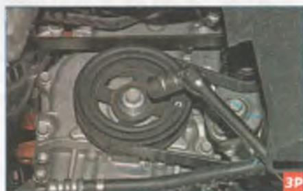
Головкой «на 17» проворачиваем колеччатый вал за болт крепления шкива вспомогательных агрегатов по часовой стрелке и осматриваем ремень по всей длине.
