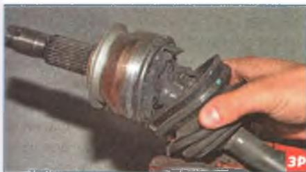
Снимаем чехол с корпуса наружного шарнира и сдвигаем чехол по валу в сторону внутреннего шарнира. Для снятия наружного шарнира...
