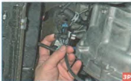
Снизу автомобиля нажимаем на фиксатор колодки (черного цвета) жгута проводов диагностического датчика концентрации кислорода...
