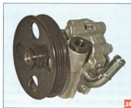
Насос гидроусилителя рулевого управления
