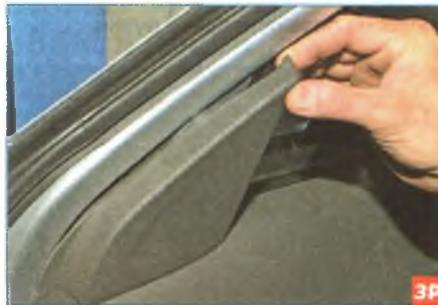
Поддеваем заднюю угловую декоративную накладку и, преодолев сопротивление трех пластмассовых фиксаторов...
