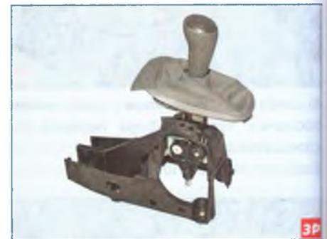
Механизм управления коробкой передач.
