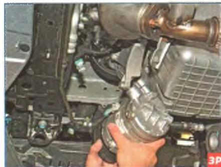
Снимаем компрессор кондиционера. Устанавливаем компрессор в обратной последовательности. При этом заменяем уплотнительные кольца трубок новыми. Заряжаем систему кондиционирования на специализированном сервисе.
