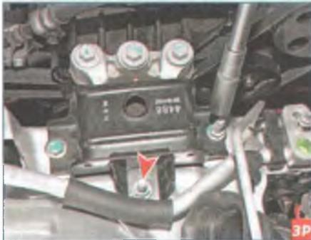
Высокой головкой «на 15» отворачиваем две гайки крепления опоры к кузову.
