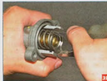
...и, поворачивая пластину в любую сторону, выводим ее из зацепления с выступами на корпусе термостата.
