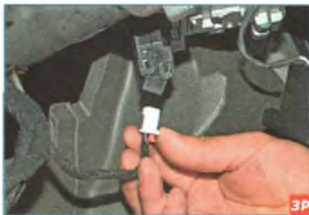
...и, нажав на фиксатор колодки проводов, отсоединяем колодку от разъема контактной группы выключателя зажигания.
