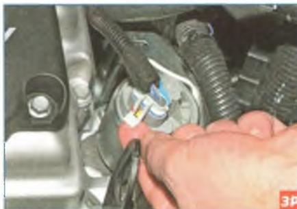
Отжав фиксатор колодки жгута проводов системы управления двигателем...
