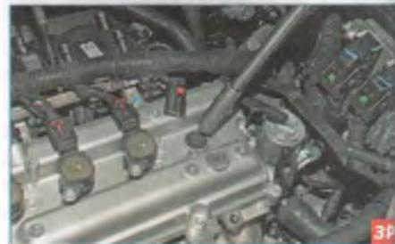
Высокой (свечной) головкой «на 16» с удлинителем выворачиваем свечу зажигания...
