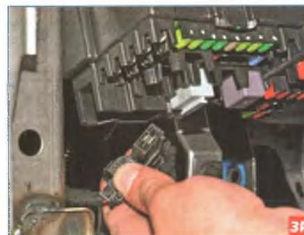
...и отсоединяем колодку от разъема монтажного блока.
