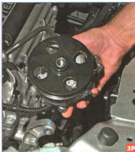
...и снимаем насос.
