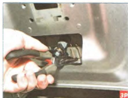
...пассатижами с длинными губками сдвигаем стопорную скобу и снимаем ее.
