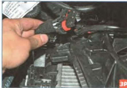
Снимаем держатель жгута проводов с ребра кожуха вентилятора...
