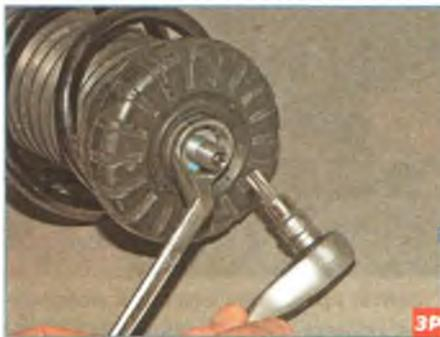
Удерживая шток ключом Torx T-50, отворачиваем гайку крепления верхней опоры стойки Z-образным ключом «на 24».
