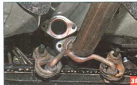
...и разъединяем фланцы промежуточной трубы и трубы дополнительного глушителя.
