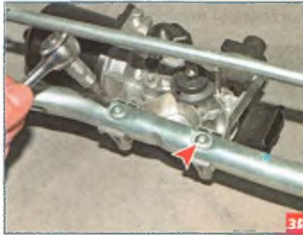
Ключом Torx T-30 отворачиваем два винта крепления мотор-редуктора.
