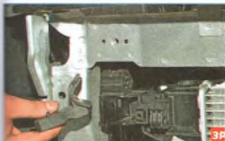
Аналогично снимаем кронштейн верхней опоры радиатора с правой стороны. Наклоняем радиатор вперед, чтобы он вышел из-под верхней поперечины рамки радиатора, и поднимаем радиатор, выводя его нижние штифты из резиновых подушек нижних опор.
