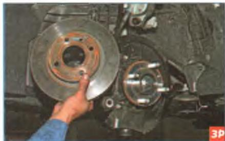
...и снимаем диск тормозного механизма со шпилек ступицы колеса.
