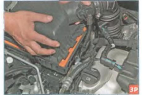
Сдвигая крышку в сторону правого крыла, выводим три выступа крышки из прорезей в корпусе фильтра.
