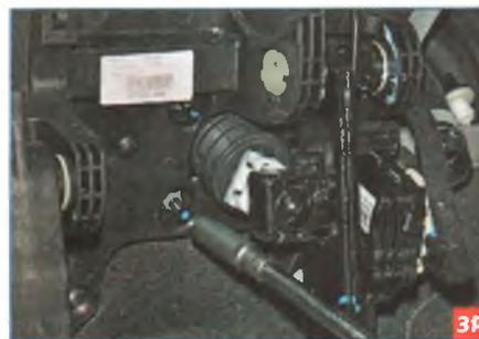
Высокой головкой «на 13» отворачиваем четыре гайки крепления вакуумного усилителя тормозов к педальному узлу.
