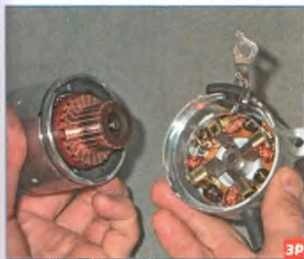
Снимаем заднюю крышку со щеткодержателем.
