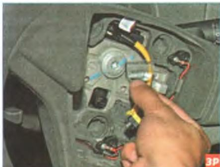
Отклеиваем пленку с винта крепления рулевого колеса.
