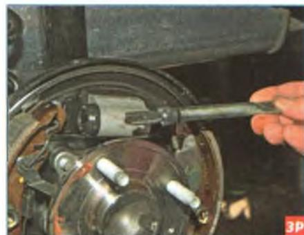
...и снимаем распорную планку.
