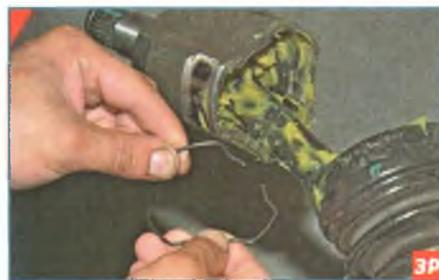
...и вынимаем его из проточки в корпусе внутреннего шарнира.
