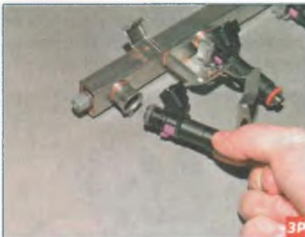
Преодолевая сопротивление резинового уплотнительного кольца форсунки, извлекаем ее из патрубка рампы. Аналогично извлекаем другие форсунки из патрубков рампы.
