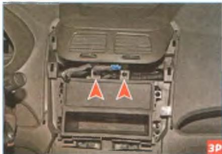
Крестообразной отверткой отворачиваем два самореза крепления корпуса центральных дефлекторов.
