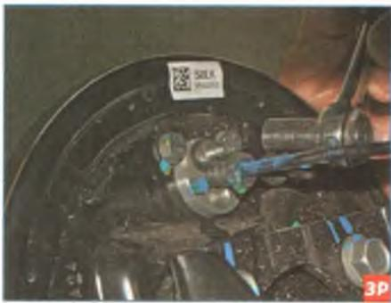
Головкой «на 10» отворачиваем два болта крепления цилиндра к щиту тормозного механизма...
