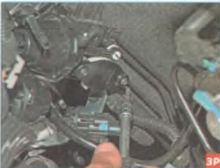
Ключом Torx T-20 отворачиваем два самореза крепления к впускному трубопроводу упорной пластины кулисы механизма...
