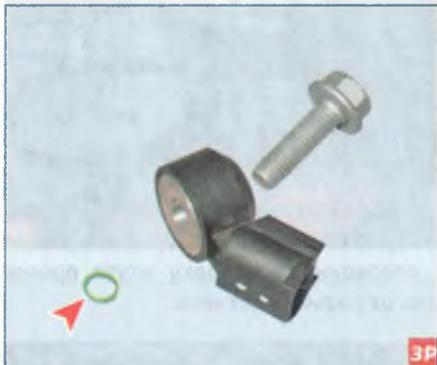
Снимаем с резьбовой части болта резиновое кольцо (показано на фото стрелкой), препятствующее выпадению болта из отверстия датчика при его монтаже, и вынимаем болт.
