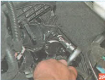
...ключом Torx T-30 отворачиваем саморез ее крепления к впускному трубопроводу.
