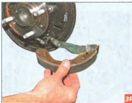
Снимаем заднюю тормозную колодку, выводя рычаг привода стояночного тормоза из отверстия наконечника заднего троса стояночного тормоза. Перед установкой новых колодок очищаем резьбу наконечника распорной планки и храповой гайки и наносим на резьбу тонкий слой пластичной смазки. Устанавливаем новые колодки тормозного механизма в обратной последовательности. Перед монтажом распорной планки ее нужно максимально укоротить. Для этого наворачиваем до конца на резьбовую стержень наконечника
