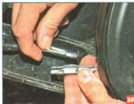
Сдвигаем наконечник среднего троса в муфте и вынимаем его.
