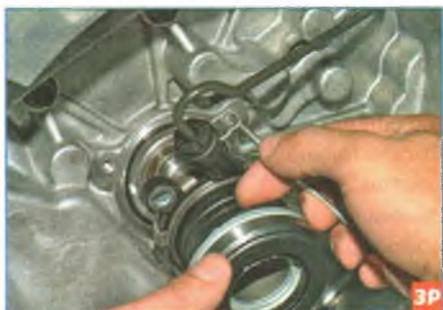
Отверткой выдвигаем из наконечника рабочего цилиндра фиксатор наконечника трубки подвода рабочей жидкости...
