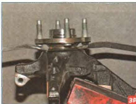
Закрепив кулак в тисках, опираемся двумя монтажными лопатками на торец кулака...
