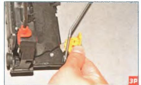
...раскрываем фиксатор, отжав отверткой флажок...
