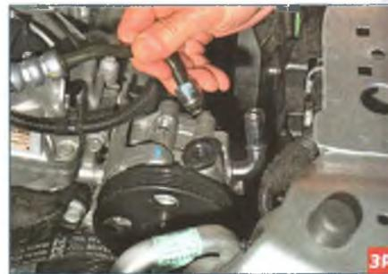
...и вынимаем трубку из резьбовой втулки насоса.
