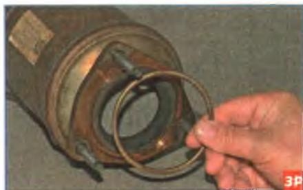
...и извлекаем ее из канавки во фланце каталитического нейтрализатора.
