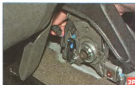
...отсоединяем колодку жгута проводов от разъема выключателя.
