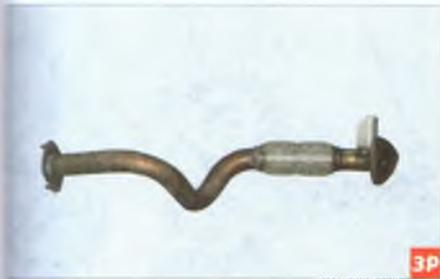
Промежуточная труба с металлокомпенсатором
