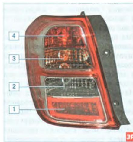
**Расположение ламп в задних фонарях:** 1 – противотуманного и габаритного света; 2 – света заднего хода; 3 – указателя поворота; 4 – сигнала торможения
