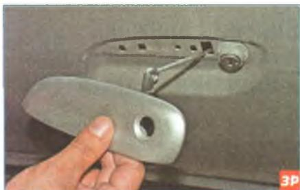
...и снимаем наружную ручку вместе с тягой, извлекая ее через отверстие в двери.
