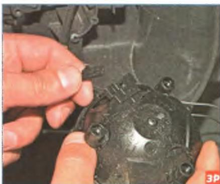
Нажав на фиксатор колодки проводов, отсоединяем колодку от разъема блока...
