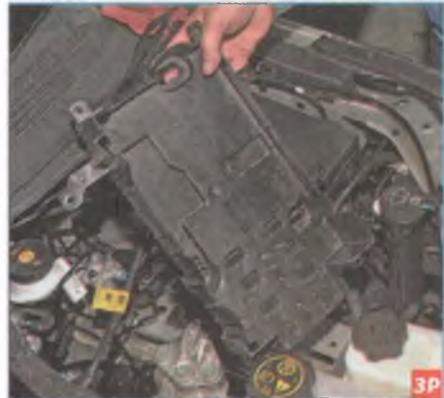
Снимаем площадку аккумуляторной батареи (см. «Снятие площадки аккумуляторной батареи», с. 233).
