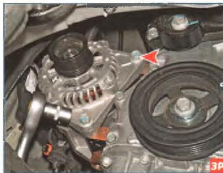
Головкой «на 15» отворачиваем два болта крепления генератора.
