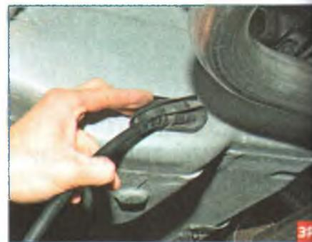
Вынимаем резиновый уплотнитель троса из отверстия в днище кузова...
