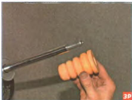
Снимаем со штока амортизатора буфер хода сжатия.
