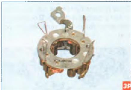
Щеткодержатель с заблокированными пружинами щеток.
