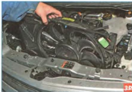
...и вынимаем кожух вентилятора из моторного отсека.
