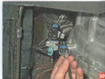
...и отсоединяем колодку от колодки жгута проводов системы управления двигателем.
