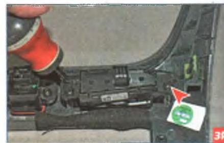
Крестообразной отверткой отворачиваем два самореза крепления выключателя центрального замка.
