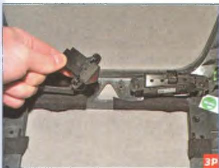
Вынимаем выключатель из накладки. Устанавливаем выключатель аварийной сигнализации в обратной последовательности.
