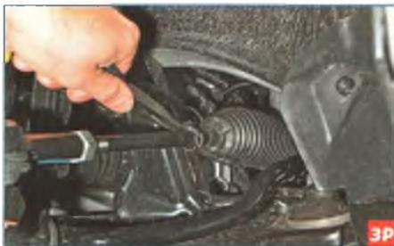
...сдвигаем пассатижами малый хомут защитного чехла рулевого механизма на самую тягу.
