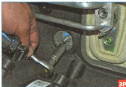
Высокой головкой «на 10» отворачиваем гайку крепления каркаса панели приборов.
