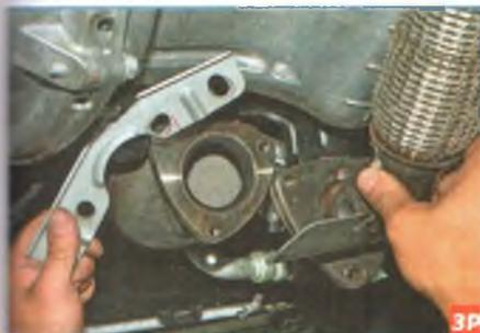
Снимаем кронштейн и разъединяем фланцы каталитического нейтрализатора и промежуточной трубы.
