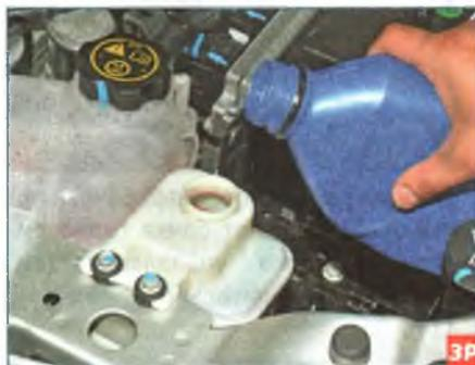
**Снимаем крышку бачка гидроусилителя рулевого управления и доливаем рабочую жидкость в бачок...**
