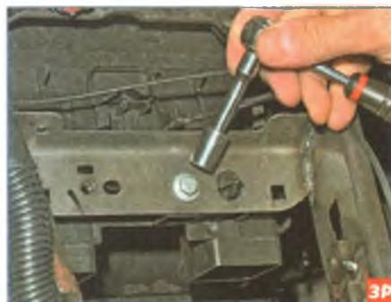
Головкой «на 10» отворачиваем болт центрального крепления отопителя...
