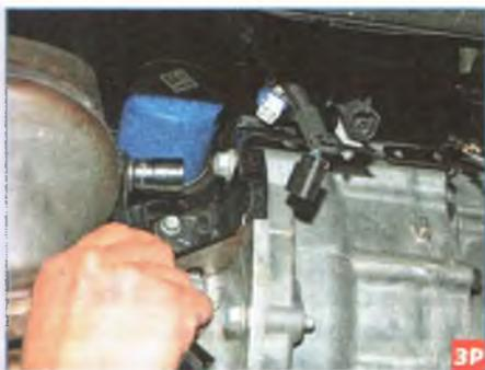
Головкой «на 15» отворачиваем болт крепления держателя жгутов проводов, предварительно отсоединив их колодки...
