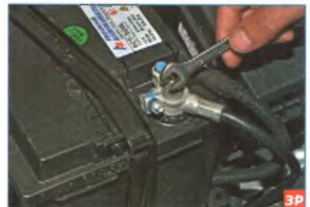
Ключом «на 10» ослабляем затяжку гайки болта клеммы проводов на «минусовом» выводе аккумуляторной батареи...
