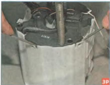
...шлицевыми отвертками освобождаем на корпусе модуля четыре фиксатора фильтра тонкой очистки топлива...
