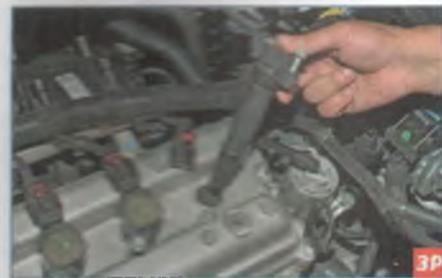
Снимаем катушку зажигания.
