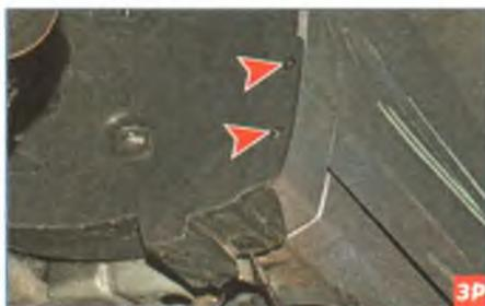
Ключом Torx T-20 отворачиваем два самореза крепления задней части подкрылка к переднему крылу и один саморез снизу...
