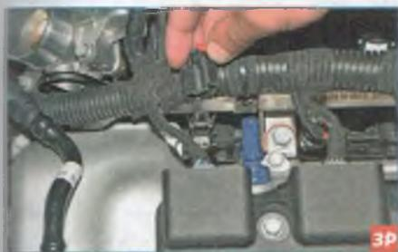
...и, нажав на фиксатор, отсоединяем колодку жгута проводов от разъема форсунки.
