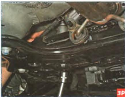
Теми же інструментами отворачиваем винт крепления картера рулевого механизма к подрамнику.
