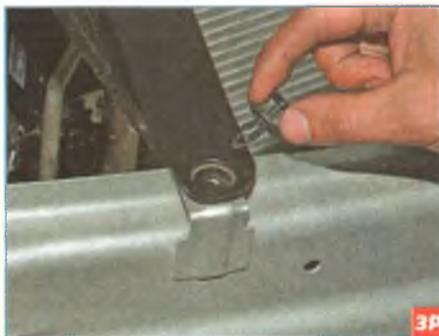
...и вынимаем пистоны. Аналогично вынимаем три пистона с другой стороны дефлектора...
