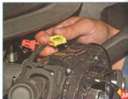
Нажав на фиксатор колодки проводов, отсоединяем колодку желтого цвета от разъема барабанного устройства.
