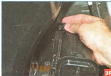
Вынимаем болты из отверстий в отбортовке бака и кронштейне адсорбера.
