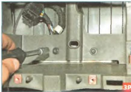
В том же месте головкой «на 7» отворачиваем два самореза крепления панели приборов.
