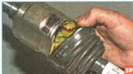
Снимаем чехол с корпуса внутреннего шарнира и сдвигаем чехол по валу в сторону наружного шарнира.
