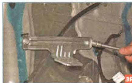
Головкой «на 10» отворачиваем два болта крепления кронштейна к внутренней панели двери...
