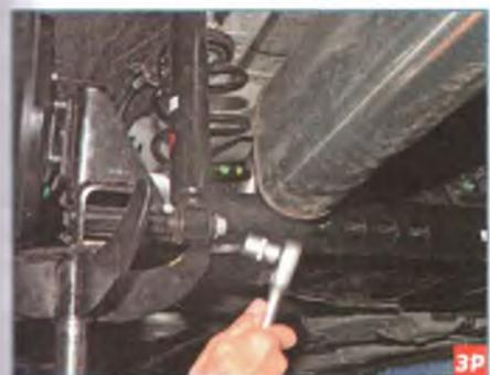
Головкой «на 18» отворачиваем болт нижнего крепления амортизатора к рычагу балки...
