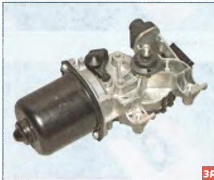
Мотор-редуктор очистителя ветрового стекла.
