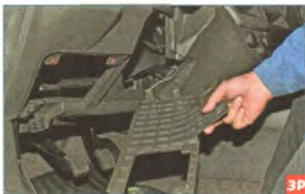
Преодолев сопротивление трех металлических и четырех пластмассовых фиксаторов, снимаем нижнюю накладку панели приборов.
