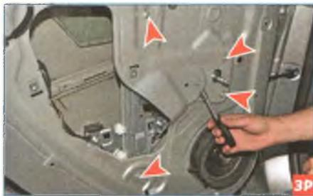
Тем же инструментом отворачиваем два болта крепления направляющей ползуна стеклоподъемника и три болта крепления механизма стеклоподъемника к внутренней панели двери.
