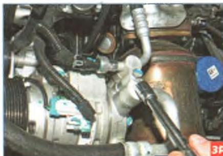
Головкой «на 13» отворачиваем болт крепления фланца трубок высокого и низкого давления (отводящий шланг радиатора снят для наглядности)...
