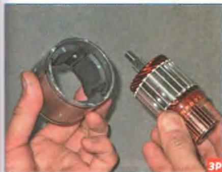
Вынимаем якорь из корпуса стартера.
