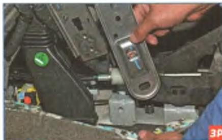
...и снимаем левый кронштейн каркаса панели приборов.
