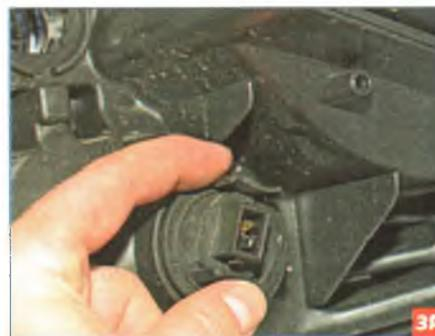
...поворачиваем патрон лампы против часовой стрелки...
