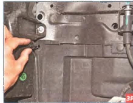
...и вынимаем пистоны из отверстий лонжерона.
