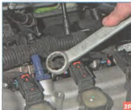
Накидным ключом «на 23» выворачиваем клапан из отверстия в крышке головки блока цилиндров...
