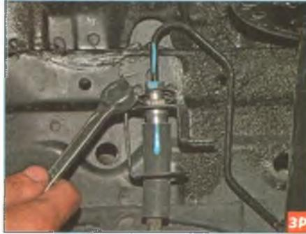
Специальным ключом «на 13» для штуцеров тормозных трубок отворачиваем штуцер крепления тормозной трубки к верхнему наконечнику шланга.
