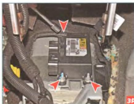
Головкой «на 10» отворачиваем три гайки крепления блока.
