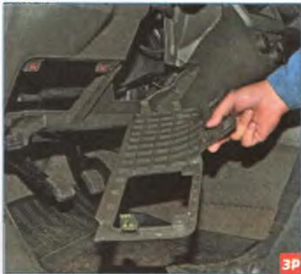
Снимаем нижнюю накладку панели приборов (см. «Снятие панели приборов», с. 251).
