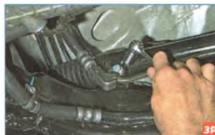
Головкой «на 13» отворачиваем болт крепления держателя трубки нагнета-
